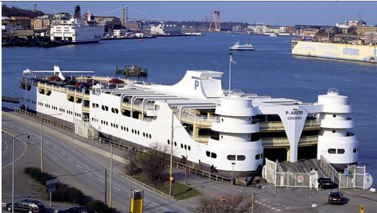
Slika 2. Prikaz plutajućeg garažnog objekta tvrtke MacGregor [3]
