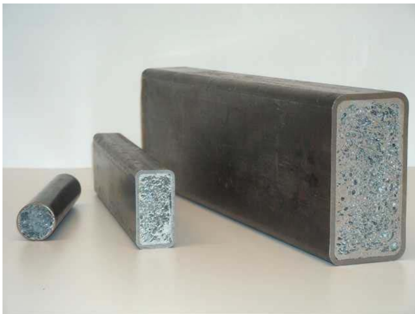
Slika 24. Sendvič konstrukcija s jezgrom od metalne pjene [2]
