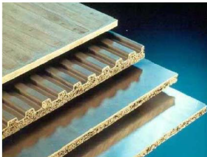
Slika 26. Sendvič poluproizvodi od metalne pjene [10]
