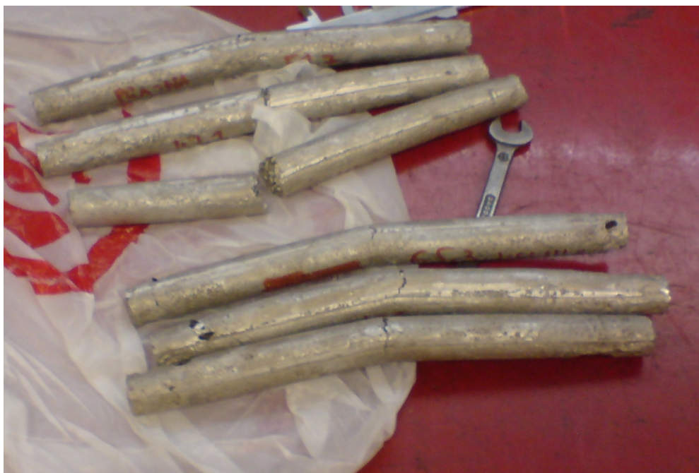
Slika 43. Uzorci nakon ispitivanja na savijanje
