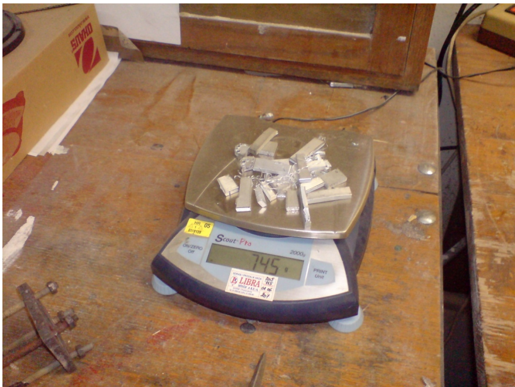
Slika 30. Masa narezanog prekursora potrebna za jedan ispitni uzorak iznosi 75 g
