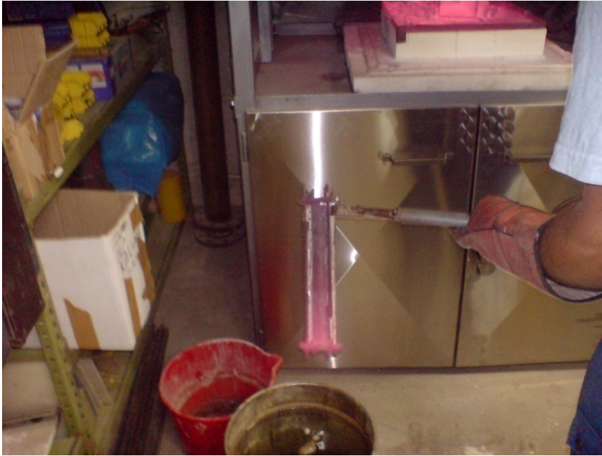
Slika 37. Intenzivno hlađenje uzorka u vodi
