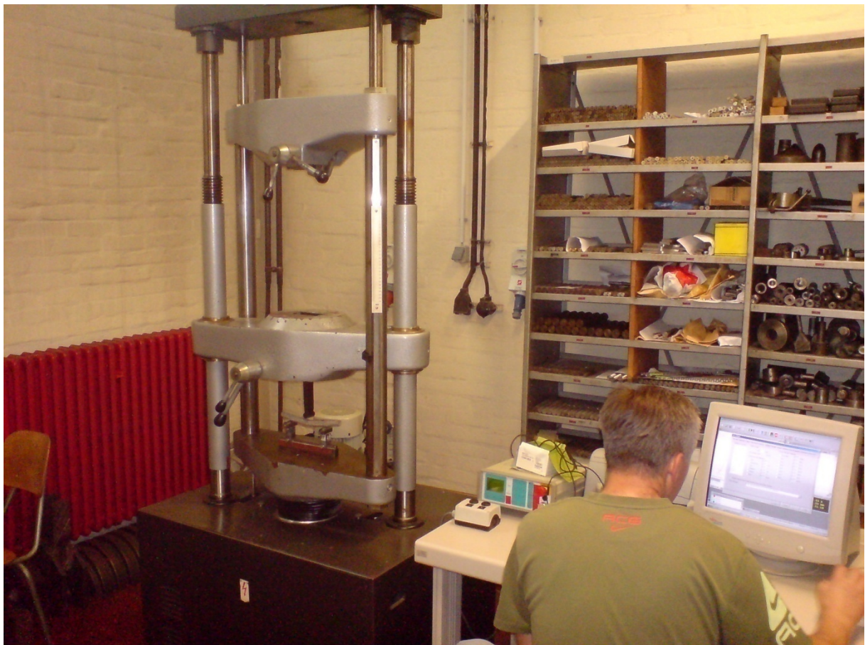
Slika 39. Kidalica na kojoj su uzorci ispitani na savijanje
