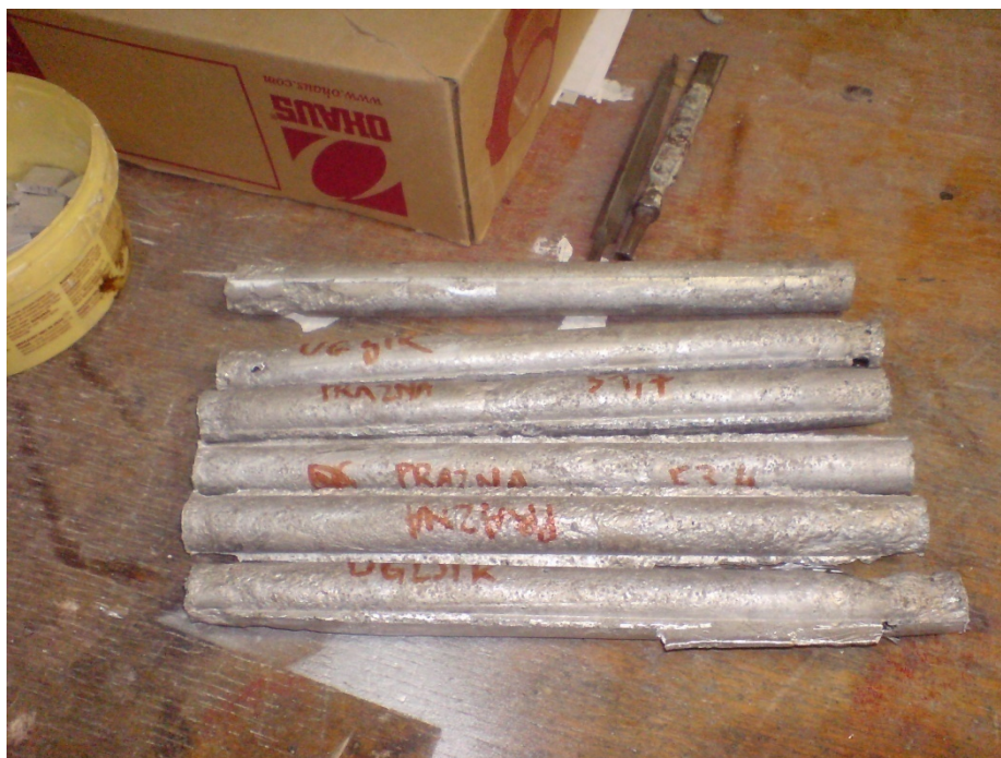
Slika 38. Gotovi ispitni uzorci aluminijske pjene
