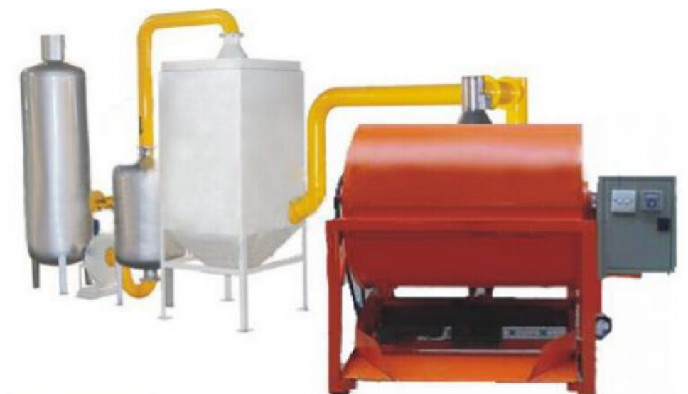
Slika 48. Uključeni sustavi za filtriranje opasnih plinova unutar bubnja
