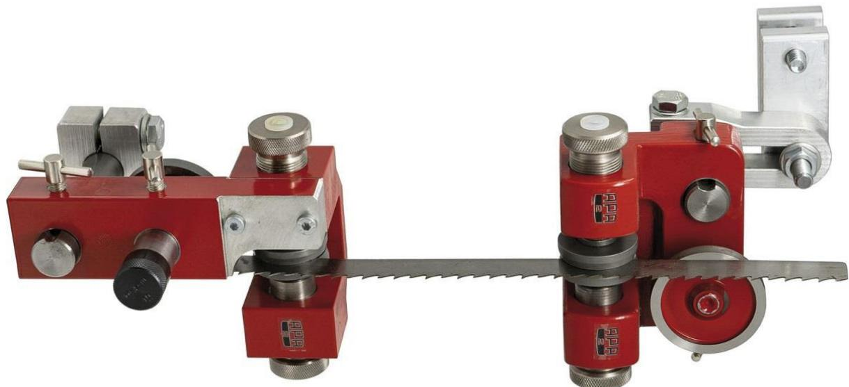
Slika 75. Vodilice lista tračne pile, [12]
