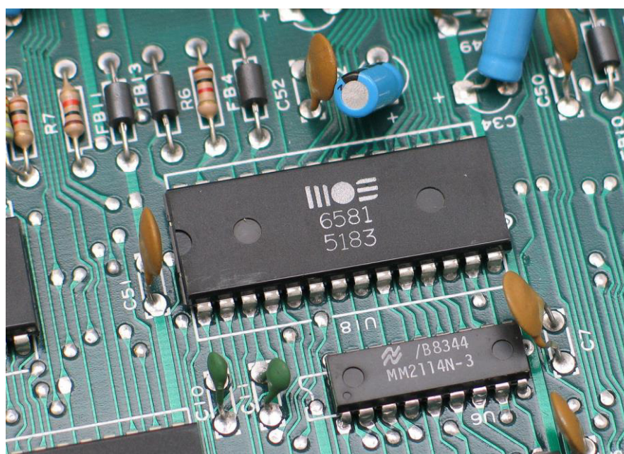
Slika 26. Komponente matične ploče spojene THT lemljenjem
