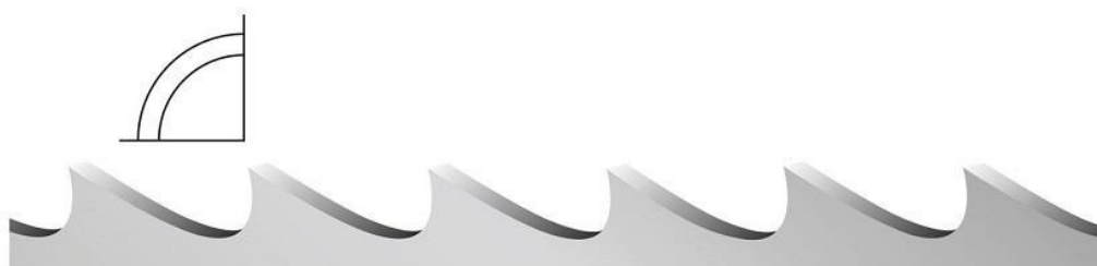
Slika 67. Oblik zuba odabrane lista tračne pile, [12]
