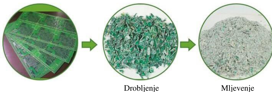
Slika 43. Rezultat usitnjavanja tiskanih ploča
