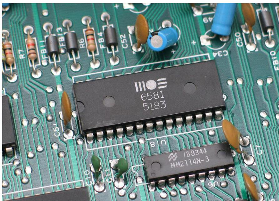
Slika 26. Komponente matične ploče spojene THT lemljenjem
