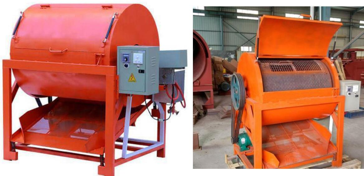
Slika 47. Stroj za uklanjanje komponenti s matičnih ploča
