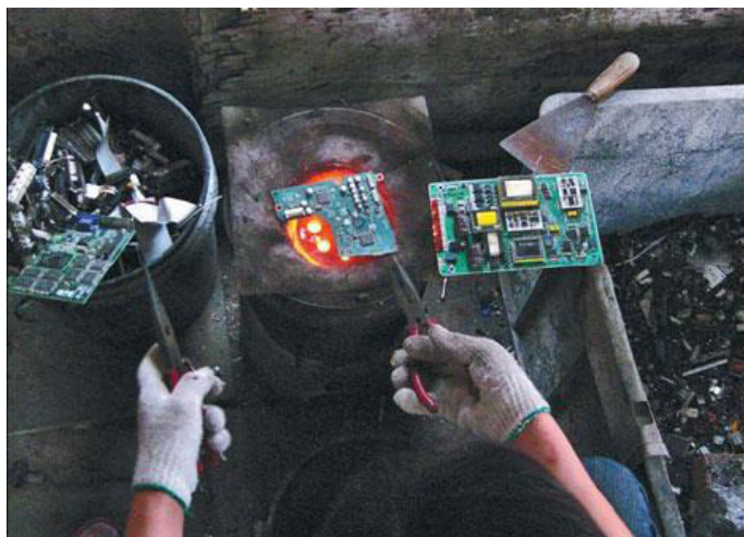
Slika 41. Rastavljanje zagrijavanjem u Guiyu u Kini
