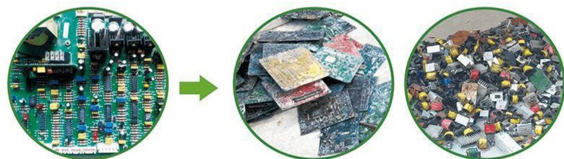
Slika 49. Odvojene komponente i tiskane ploče
