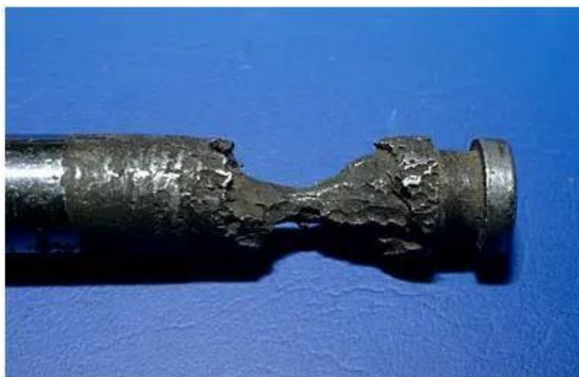
Slika 20. Korozija u procjepu čelika AISI 316L [34]
