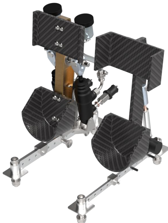
Slika 16. Sklop pedala bolida FSB-RT06R VulpesR -a
