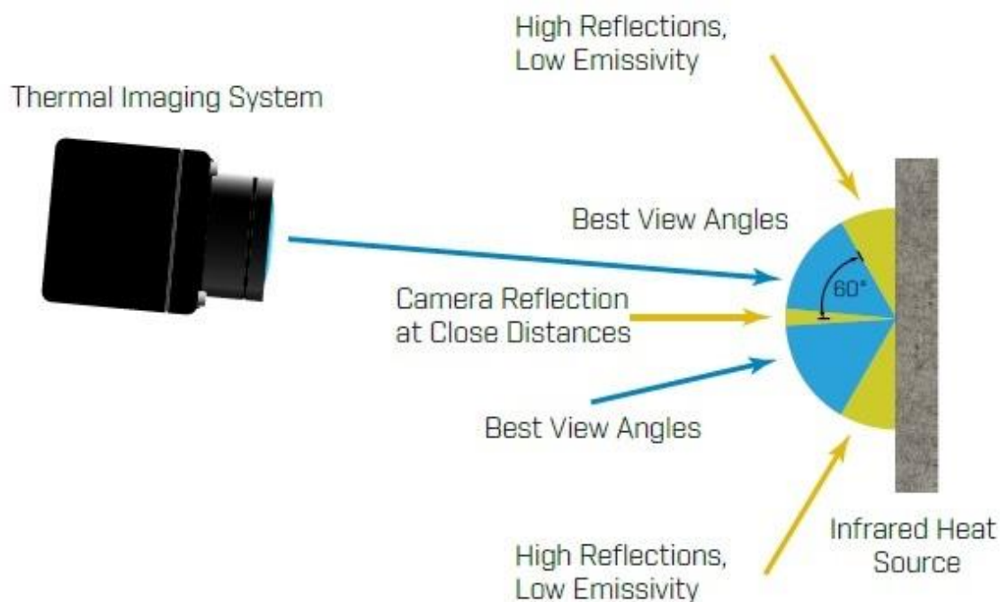
Slika 23. Optimalan kut mjerenja IC senzorom [22]
