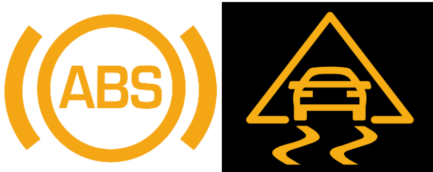
Slika 8. Indikator djelovanja ABS sustava (lijevo) i ESP sustava (desno) na instrumentnoj ploči automobila [8]
