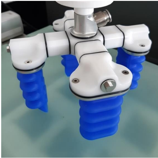
Slika 4. Hvataljka mGrip Soft Robotics
