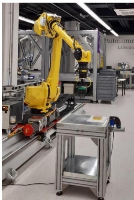
**Slika 58. Eksperimentalni postava za ispitivanje točnosti i ponovljivosti Fanuc 3D Area senzora**
