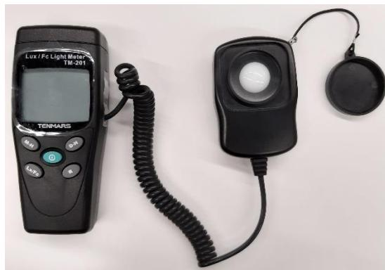
Slika 52. Tenmars TM-201 mjerač intenziteta osvjetljenja
