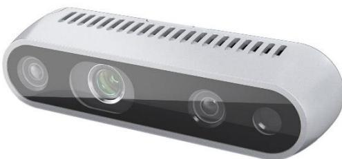
Slika 2. Intel RealSense D435
