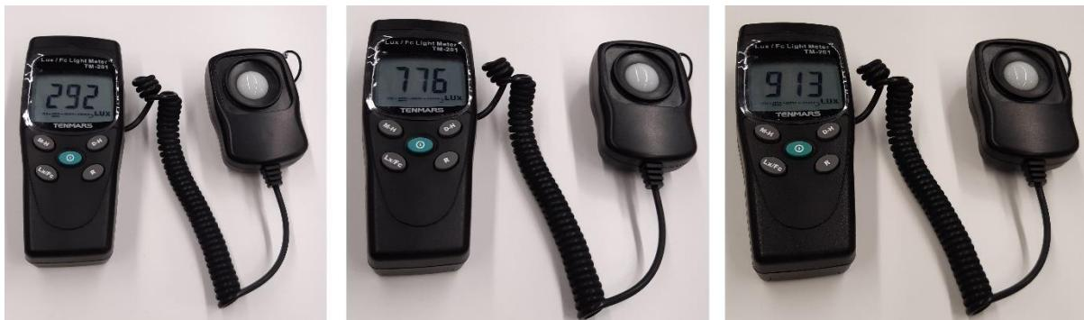
**Slika 53. Prikaz izmjerene vrijednosti intenziteta ambijentalnog osvjetljenja u Laboratoriju za autonomne sustave u CRTA-i**
