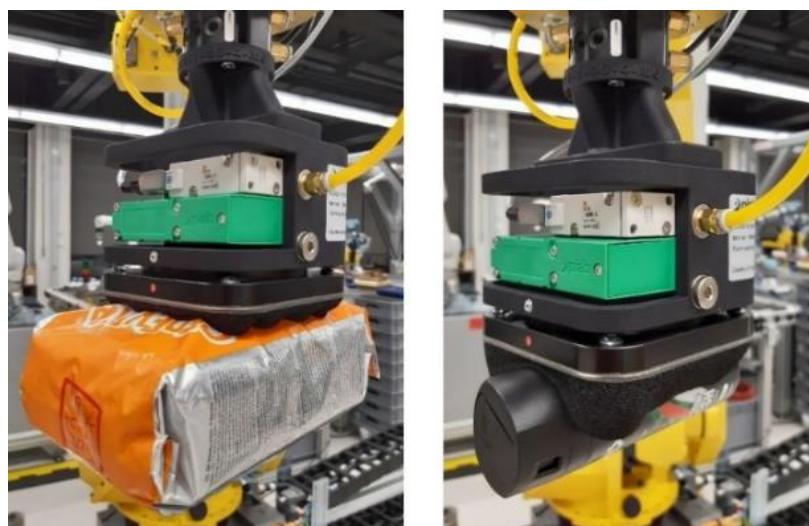
**Slika 25. Prikaz hvatanja predmeta rada s Piab Kenos KCS vakuumskom hvataljkom**
