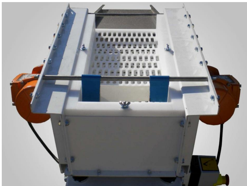
Slika 47 Vibracijski stol za grubo odvajanje ljuski [17]
