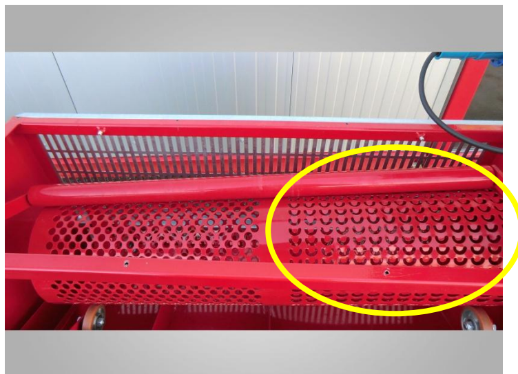
Slika 46 Grubo odvajanje ljuske bubnjem s rupama [17]
