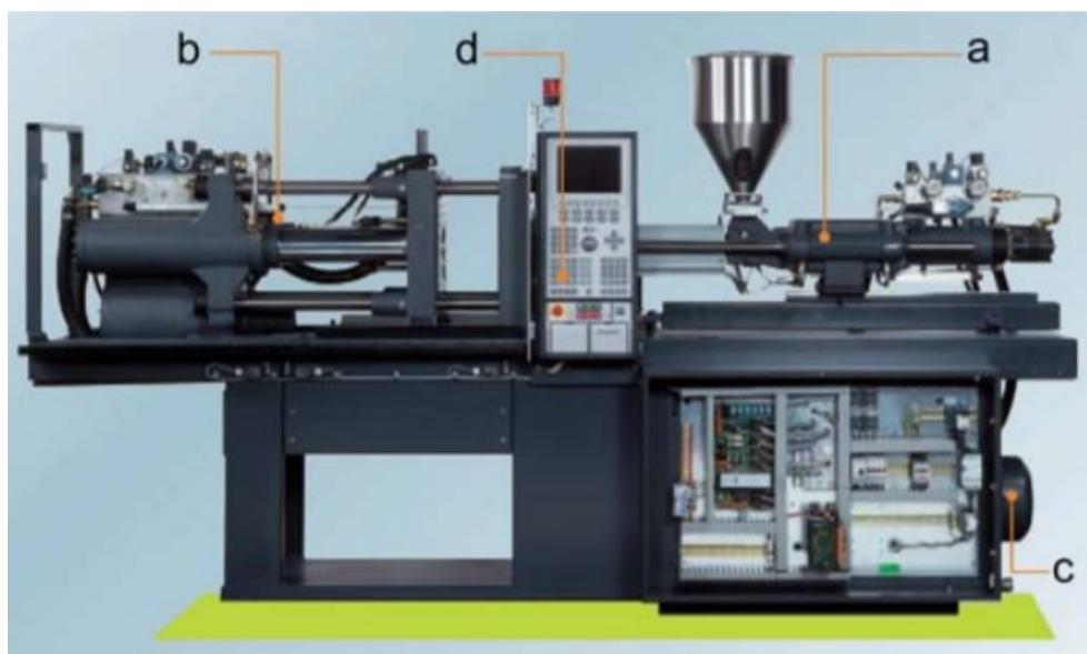
Slika 3. Hidraulična ubrizgavalica [2]
