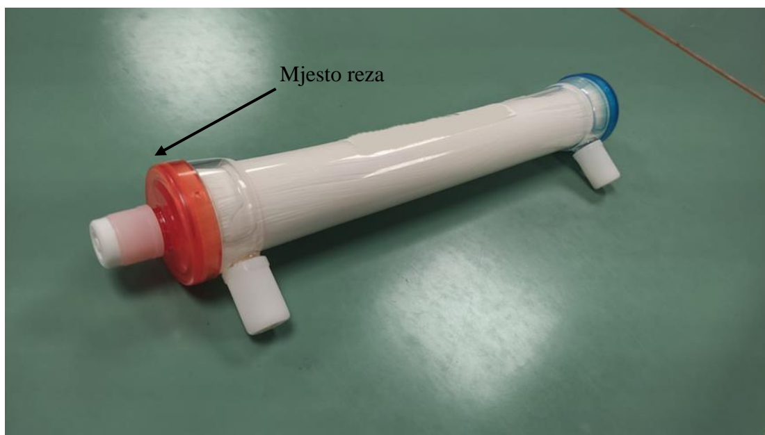
Slika 38. Mjesto reza membrana
