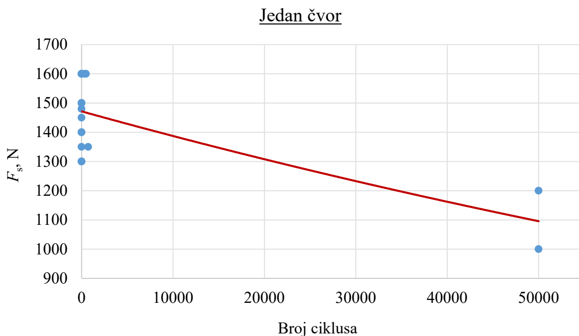
Slika 34. Wöhlerov dijagram za uzorke s jednim čvorom
