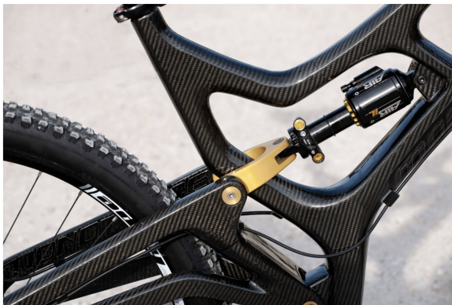
Slika 8. Okvir bicikla od ugljičnih vlakana [11]
