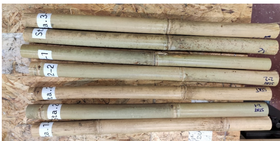
Slika 28. Uzorci za statičko ispitivanje
