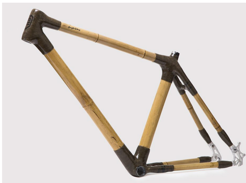
Slika 22. Okvir bicikla izrađen od Tonkin Cane bambusa [12]
