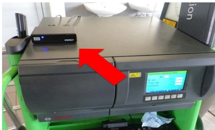
Slika 28. RFID uređaj postavljen na analizator ispušnih plinova [227]
