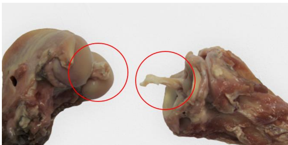
Slika 43. Proksimalno puknuće prednje ukrižene sveze uzorka iz eksperimentalne grupe 0; snopa vlakana prednje ukrižene sveze nakon vlačnog ispitivanja
