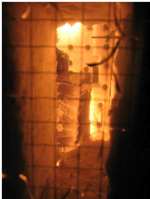
Slika 6. Snimka profila, zaštićen Hensothermom 3KS nakon 30 minuta (temperatura je viša od  $600^{\circ}\text{ C}$ )
