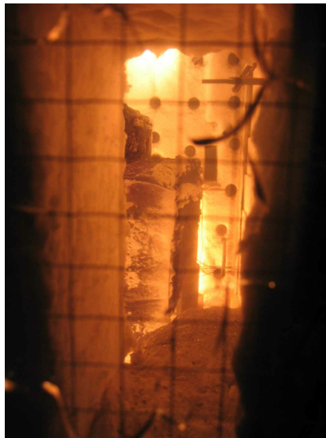
Slika 6. Snimka profila, zaštićen Hensothermom 3KS nakon 30 minuta (temperatura je viša od 600° C)
