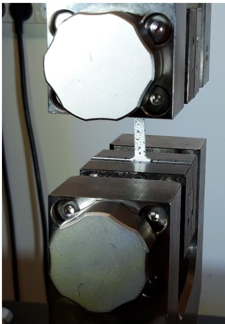
Slika 17. Provođenje statičkog vlačnog ispitivanja materijala Pocan B3225 [11]
