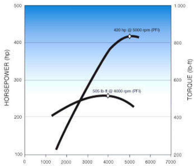
Dijagram 4 - Radna karakteristika motora GM Vortec 8100
