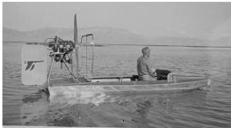
Slika 1 – Izgled ranog tipa plovila sa zračnom propulzijom
