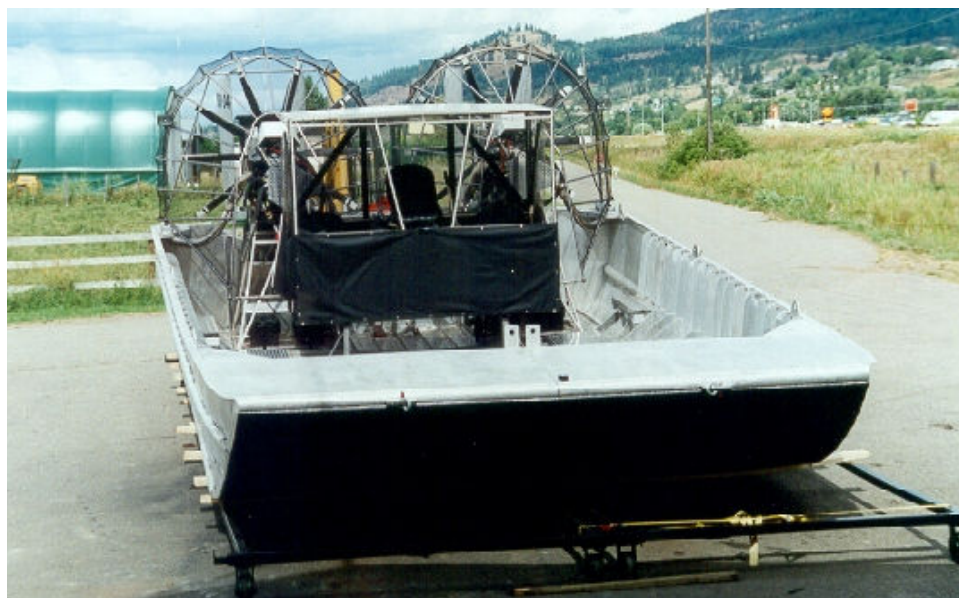
Slika 4 – Veliko plovilo sa zračnom propuzijom nosivosti 8 tona
