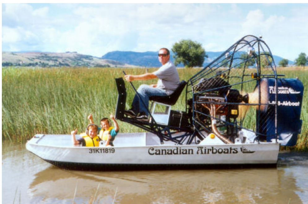
Slika 5 – Jednosjedno plovilo sa zračnom propulzijom
