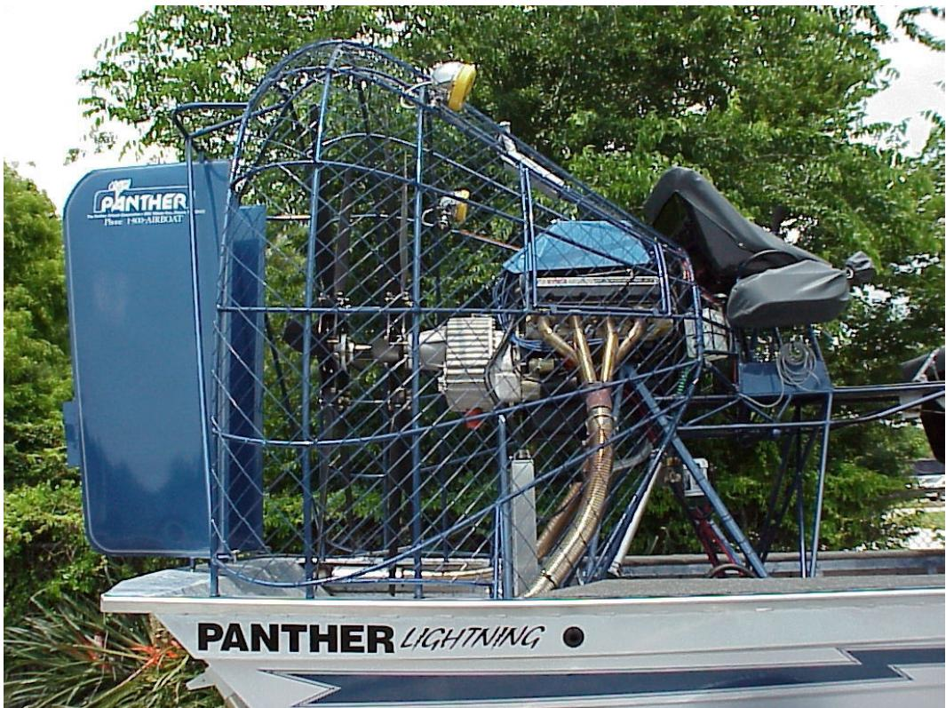
Slika 7 – Zaštitni kavez motora i propelera
