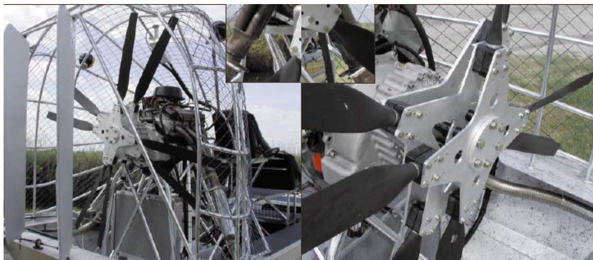
Slike 10 i 11 – Kompozitni propeleri postavljeni u turbinsku konfiguraciju
