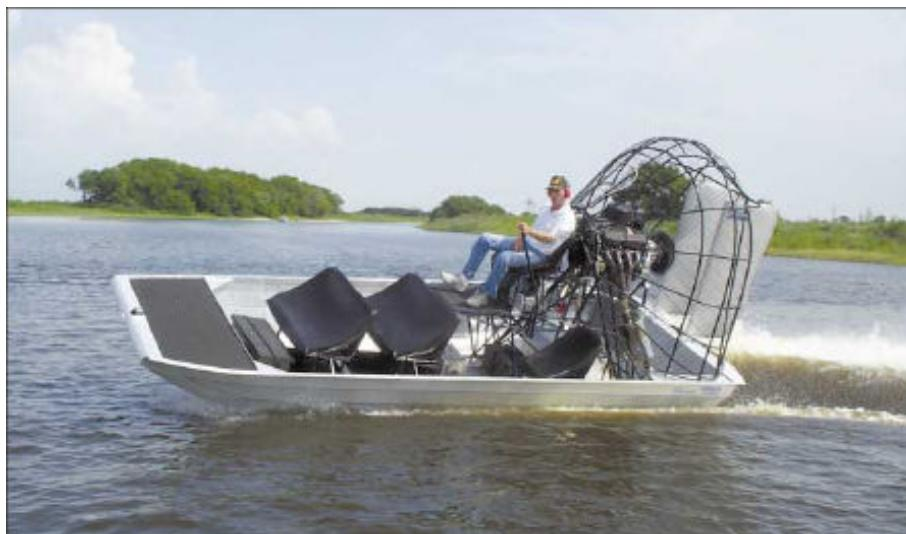
Slika 12 – Plovilo sa zračnom propulzijo u oštem manevru
