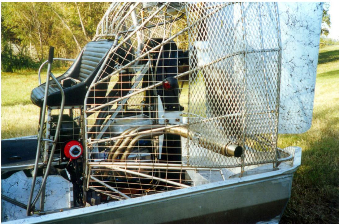
Slika 6 – Smještaj motora nisko u trupu zbog stabilnosti
