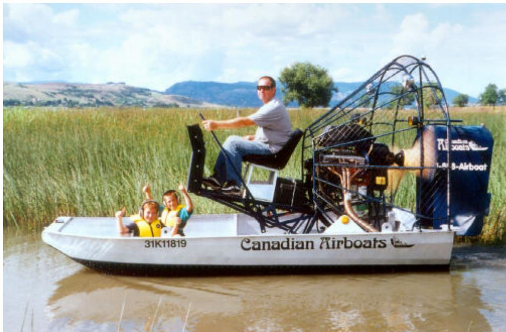
Slika 5 – Jednosjedno plovilo sa zračnom propulzijom
