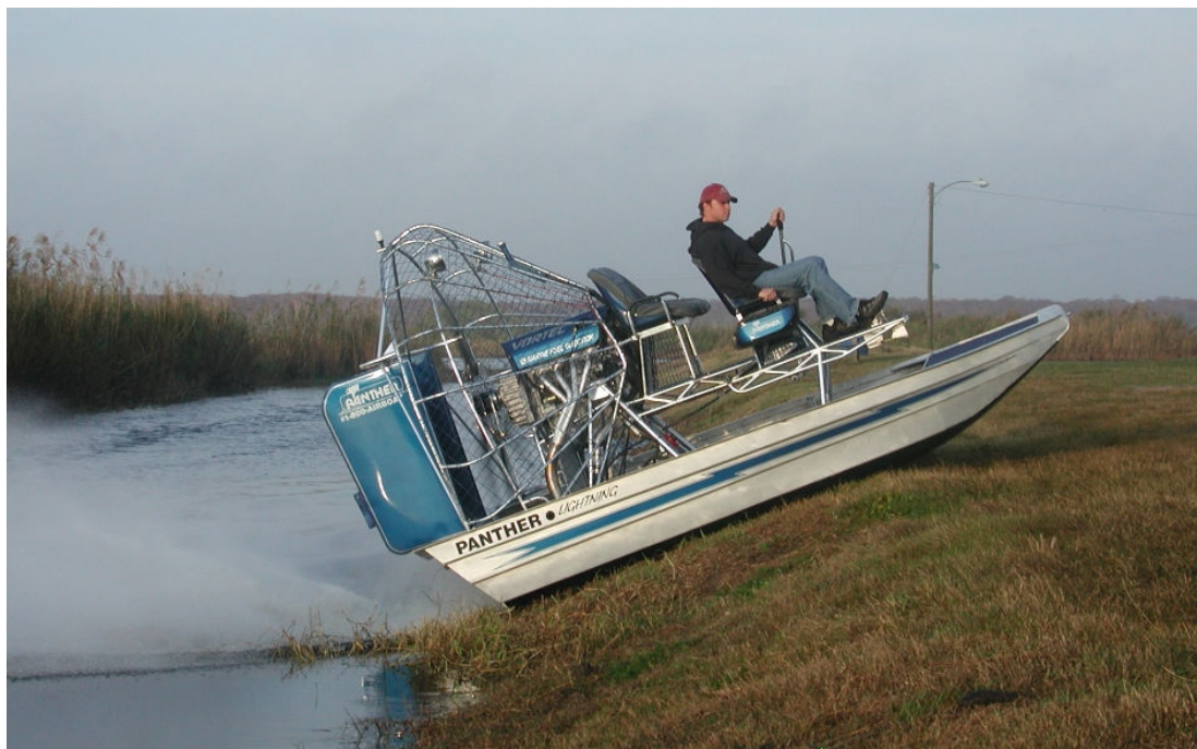
Slika 13 – Plovilo sa zračnom propulzijom izlazi bez problema na kopno po strmini
