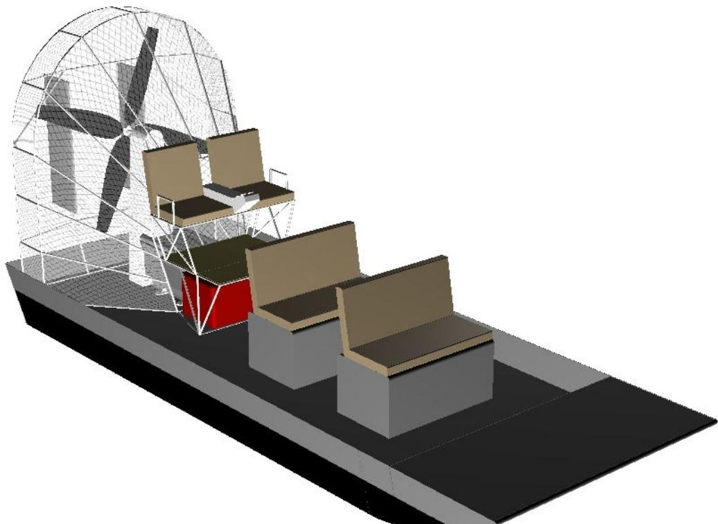
Slika 42 – 3D model plovila sa zračnom propulzijom
