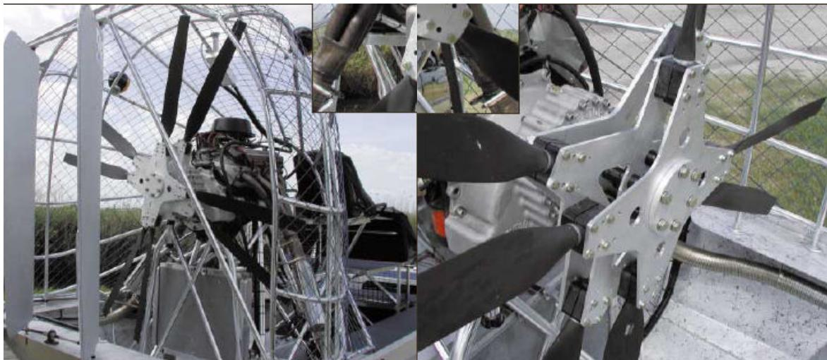
Slike 10 i 11 – Kompozitni propeleri postavljeni u turbinsku konfiguraciju
