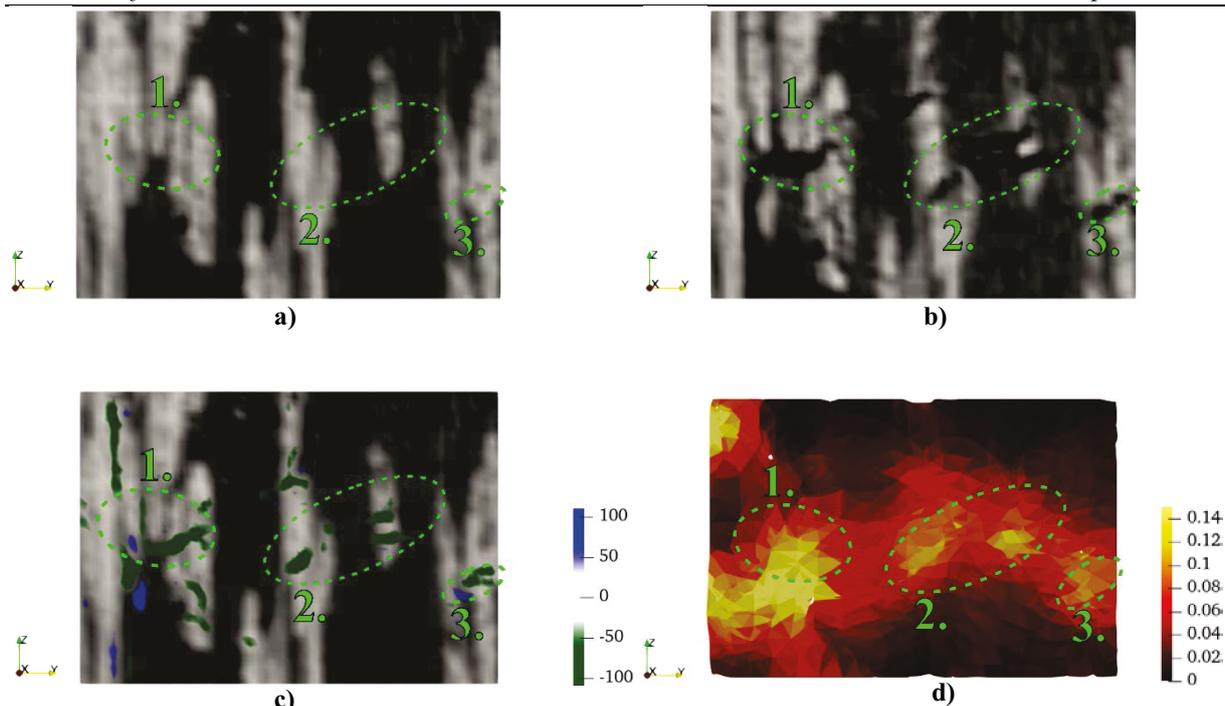
**Slika 28. a) Presjek skena 0, b) presjek skena 1, c) korelacijski reziduali preklopljeni sa presjekom skena 0 i d) presjek polja glavnih deformacija. Zelene isprekidane elipse su numerirane brojevima 1.-3. i prikazuju zone unutar kojih su nastale pukotine.**
