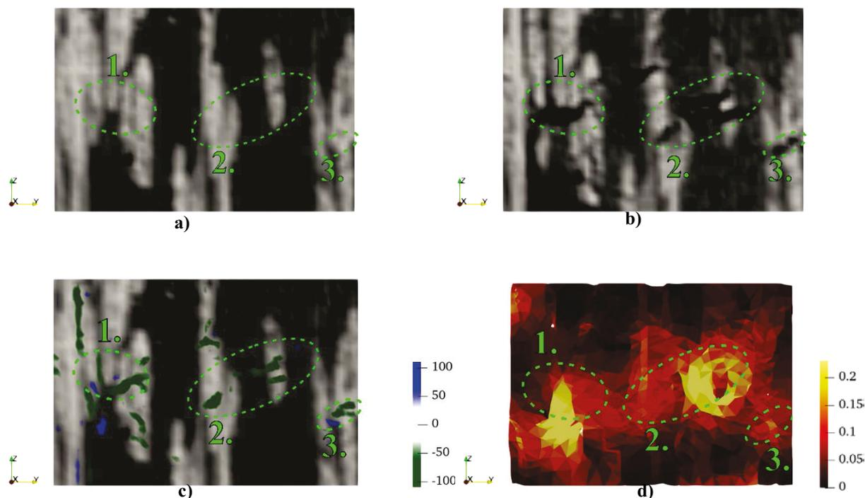
**Slika 40.a) Presjek početnog skena 0, b) presjek deformiranog skena 1, c) korelacijski reziduali preklopljeni sa presjekom skena 0 i d) presjek polja glavnih deformacija. Zelene isprekidane elipse su numerirane 1.-3. i prikazuju zone unutar kojih su nastale pukotine.**
