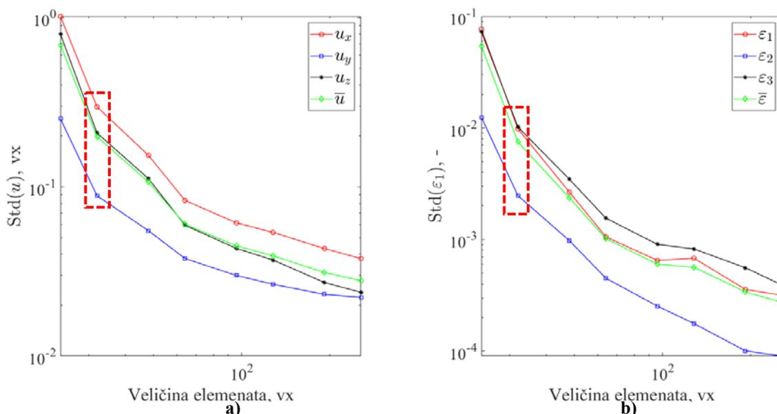
**Slika 12. a) Standardna devijacija pomaka u ovisnosti o veličini elemenata i b) standardna devijacija deformacija u ovisnosti o veličini elemenata. Crveni isprekidani pravokutnik označuje odabranu veličinu elemenata.**
