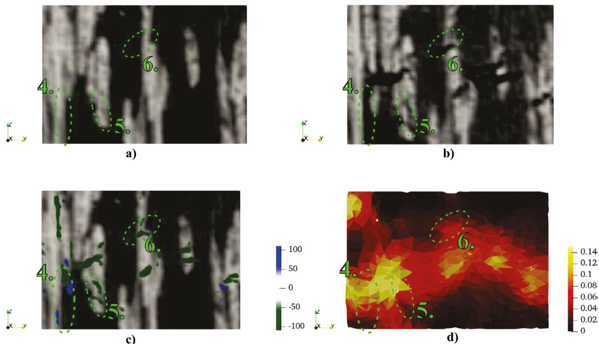
**Slika 29. a) Presjek početnog skena 0, b) presjek deformiranog skena 1, c) korelacijski reziduali preklapljeni sa presjekom skena 0 i d) presjek polja glavnih deformacija. Zelene isprekidane elipse su numerirane 4.-6. i prikazuju zone unutar kojih su nastale pukotine.**
