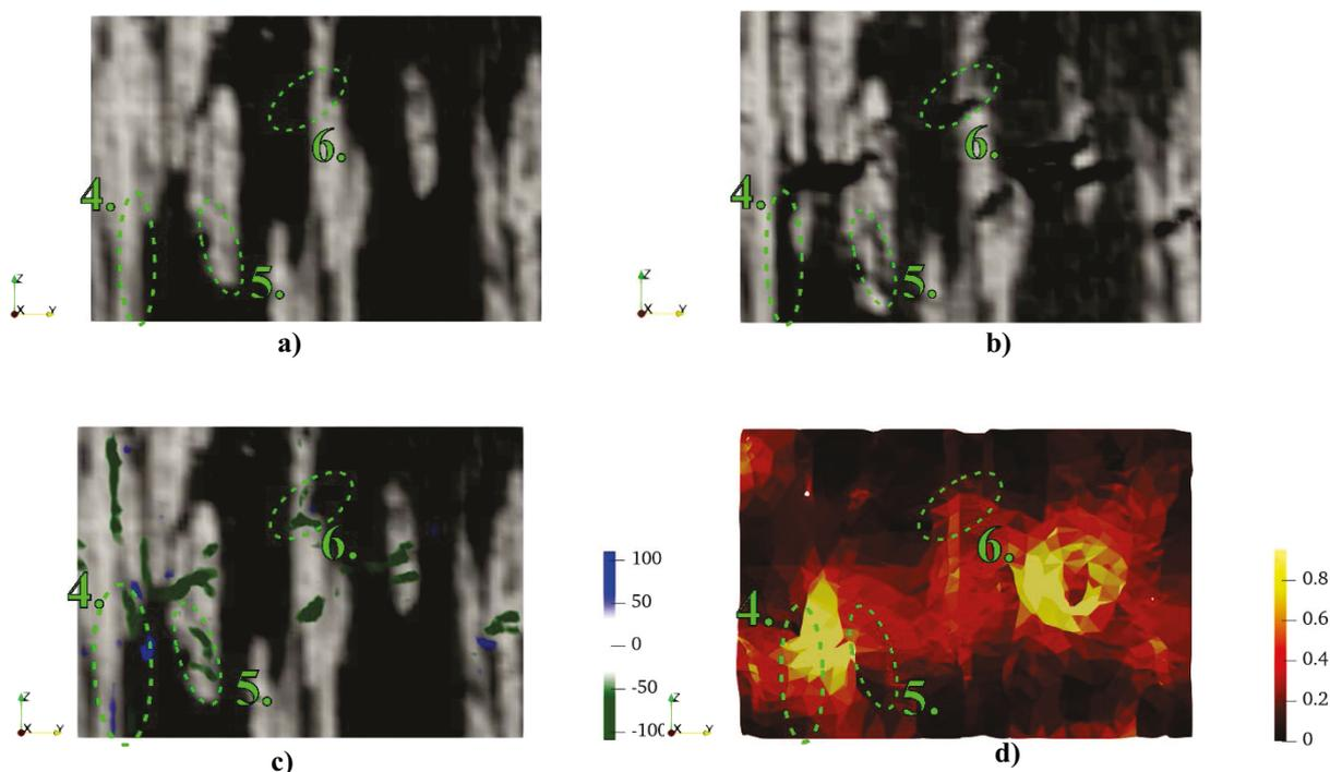
**Slika 41. a) Presjek početnog skena 0, b) presjek deformiranog skena 1, c) korelacijski reziduali preklopljeni sa presjekom skena 0 i d) presjek polja glavnih deformacija. Zelene isprekidane elipse su numerirane 4.-6. i prikazuju zone unutar kojih su nastale pukotine.**
