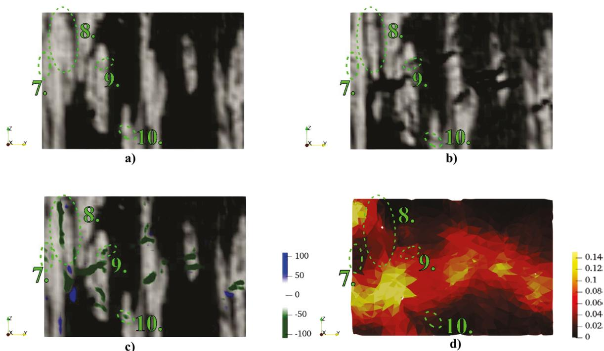
**Slika 30. a) Presjek početnog skena 0, b) presjek deformiranog skena 1, c) korelacijski reziduali preklapljeni sa presjekom skena 0 i d) presjek polja glavnih deformacija. Zelene isprekidane elipse su numerirane 7.-10. i prikazuju zone unutar kojih su nastale pukotine.**
