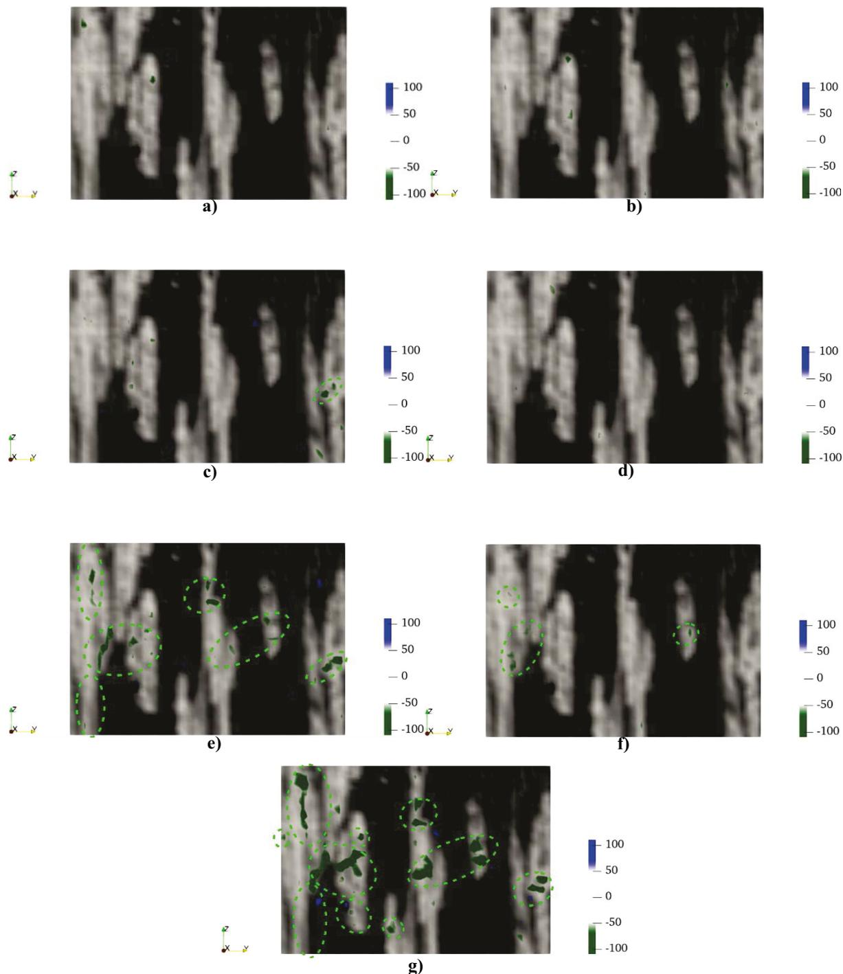
**Slika 45. Korelacijski reziduali preklopljeni sa početnim skenom 0 za a) sken 001, b) sken 002, c) sken 003, d) sken 004, e) sken 005, f) sken 006 i g) sken 007. Zelene elipse označuju zone unutar kojih su nastale pukotine.**
