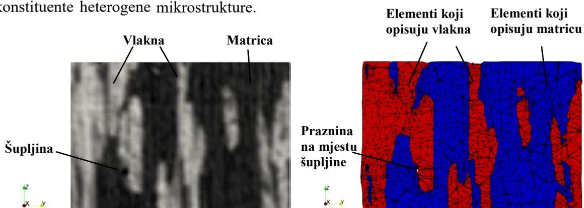
Slika 5. Presjek a) mikrostrukture i b) pripadajuće mreže konačnih elemenata kompozita.
