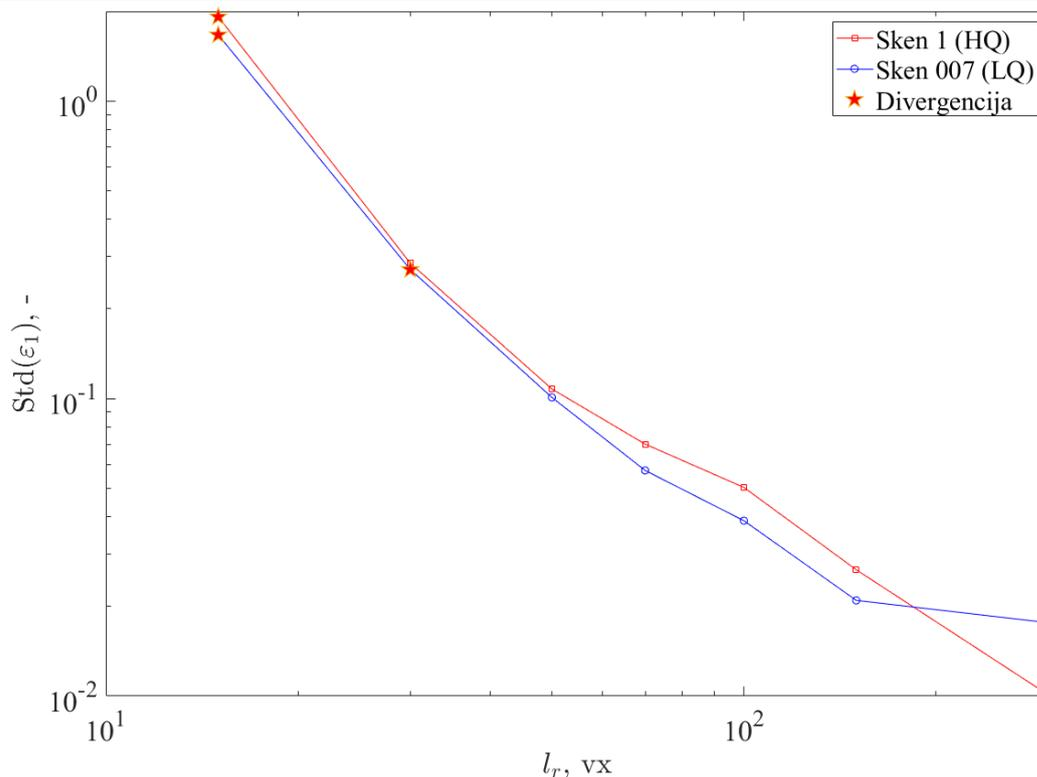
**Slika 44. Standardna devijacija deformacija u ovisnosti o regularizacijskoj duljini i kontrastu. Ovisnost razliĉitih kvaliteta skenova i regularizacijskih duljina o divergenciji DVC analize.**
