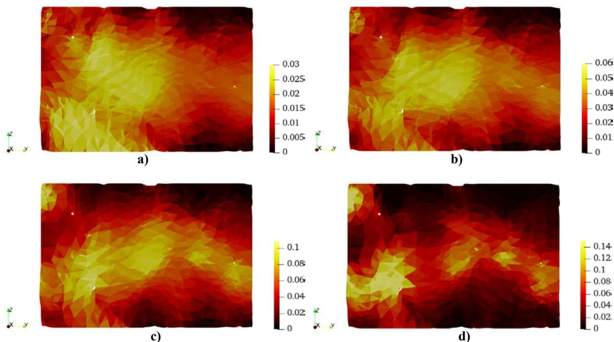
Slika 25. Polja najvećih glavnih deformacija dobivena sa regularizacijskom duljinom: a)  $l_r=100$  vx, b)  $l_r=70$  c) vx,  $l_r=50$  vx i d)  $l_r=30$  vx.
