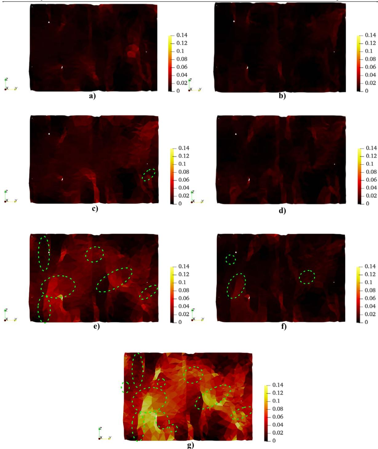
Slika 46. Polja najvećih glavnih deformacija za a) sken 001, b) sken 002, c) sken 003, d) sken 004, e) sken 005, f) sken 006 i g) sken 007. Zelene elipse označuju zone unutar kojih su nastale pukotine.
