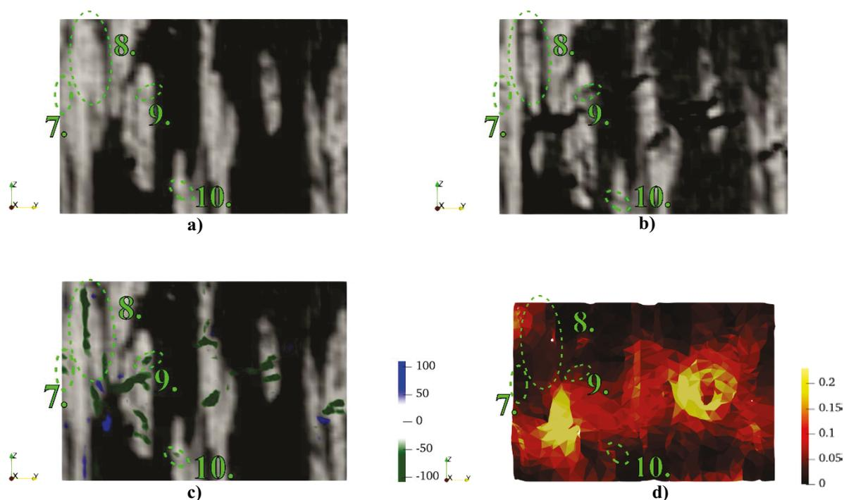
**Slika 42. a) Presjek početnog skena 0, b) presjek deformiranog skena 1, c) korelacijski reziduali preklapljeni sa presjekom skena 0 i d) presjek polja glavnih deformacija. Zelene isprekidane elipse su numerirane 7.-10. i prikazuju zone unutar kojih su nastale pukotine.**
