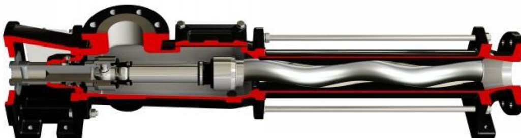
Slika 33. Presjek vijčano-ekscentrične pumpe [31]
