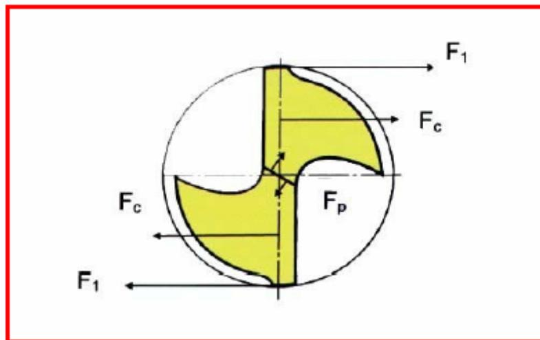
Slika 21. Sile rezanja kod bušenja [14]
