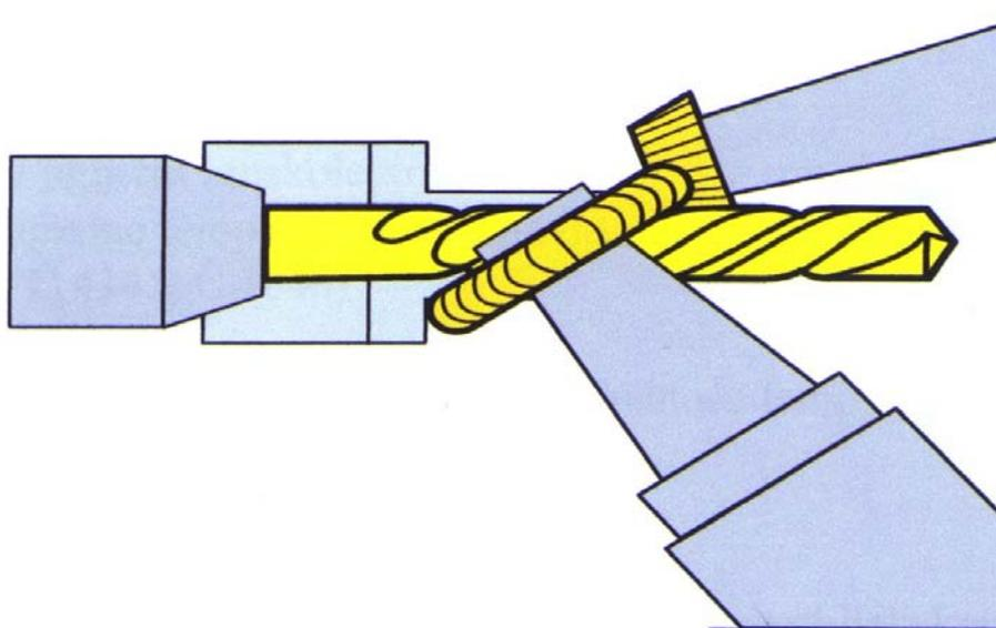
Slika 12. Izrada svrdla glodanjem [14]
