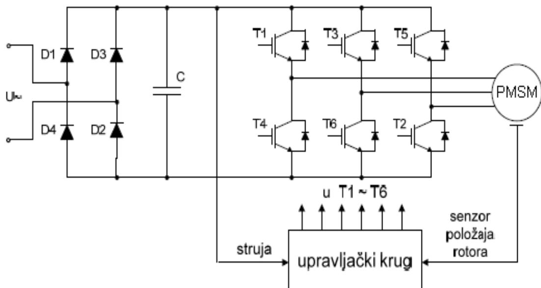
Slika 26. Regulacijski krug sinkronog elektromotora s permanentnim magnetima [20]
