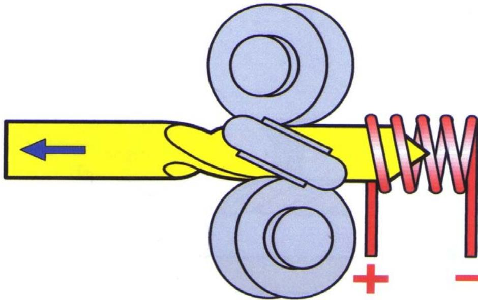
Slika 11. Izrada svrdla valjanjem [14]
