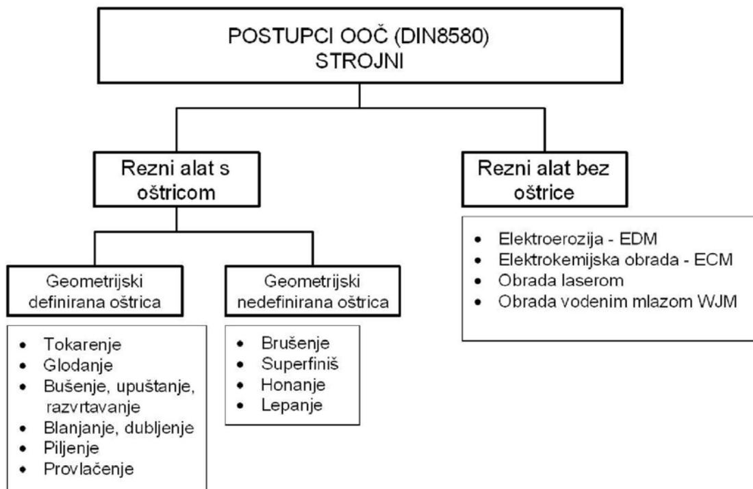
Slika 3. Podjela strojnih postupaka obrade odvajanjem čestica [9]
