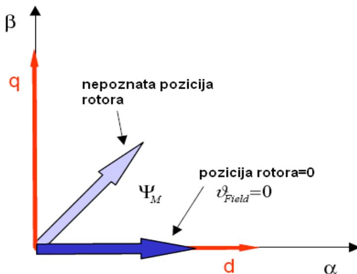
Slika 33. Namještanje rotora [19]
