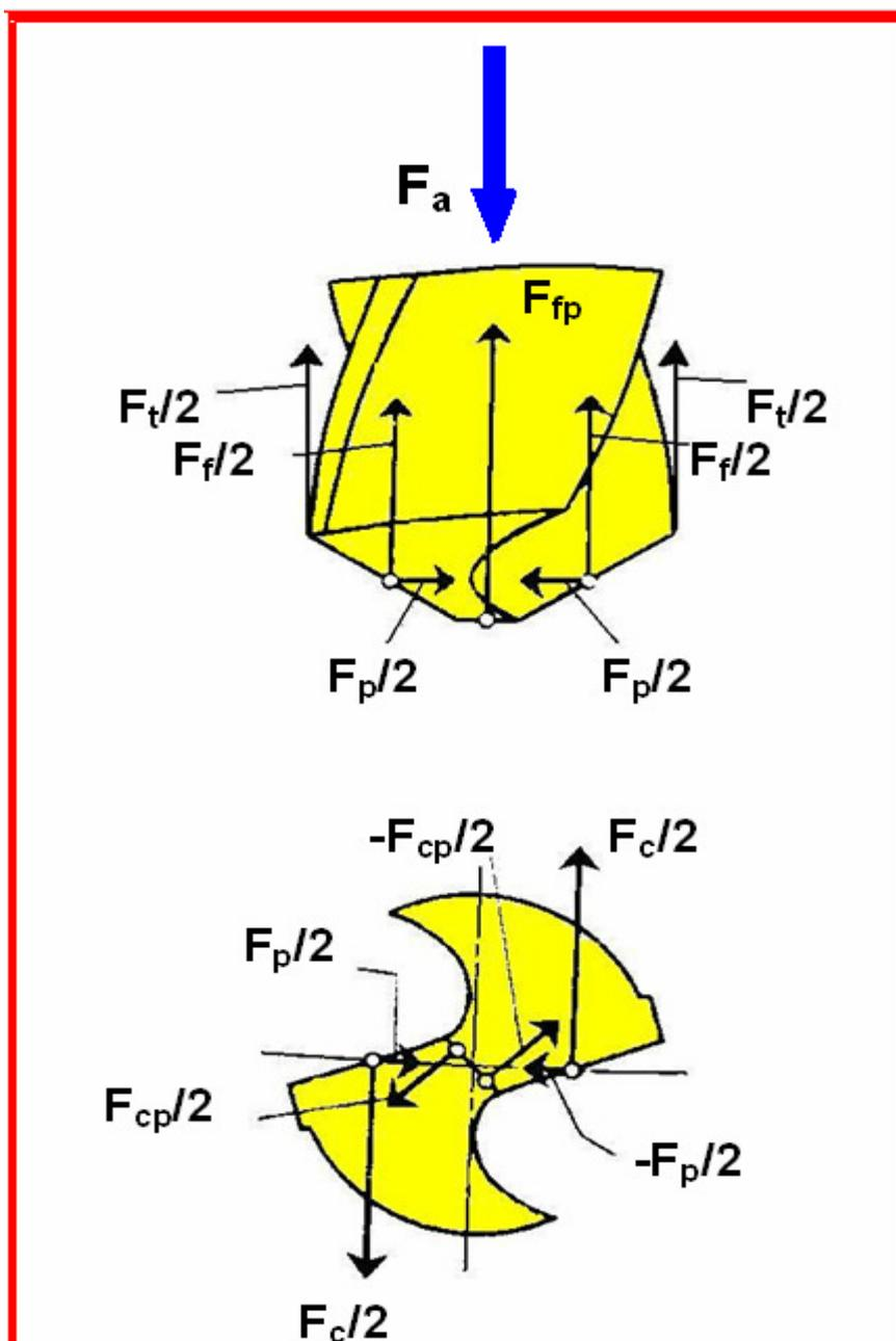
Slika 20. Sile rezanja u procesu bušenja [14]
