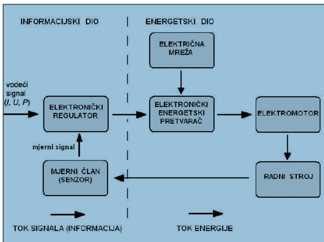
Slika 22. Osnovna struktura upravljanja elektromotornog pogona [17]
