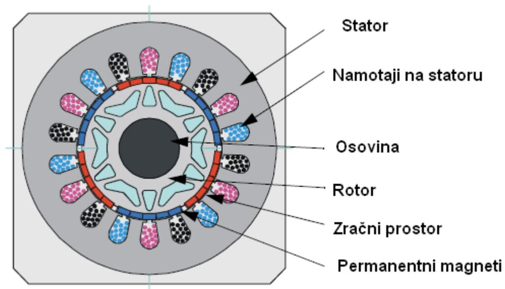
Slika 25. Trofazni elektromotor s permanentnim magnetima [19]
