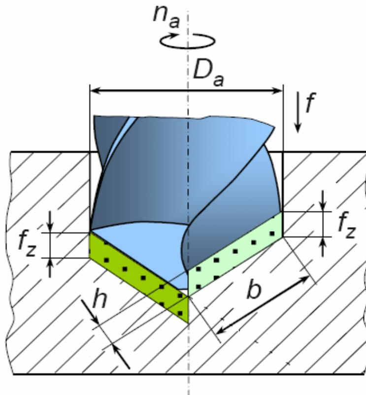
Slika 14. Parametri odvojene čestice kod bušenja [12]
