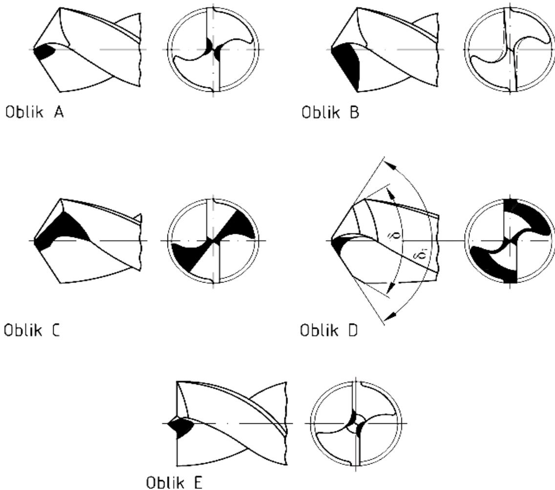
Slika 10. Podjela svrdla prema geometriji oštrice [15]
