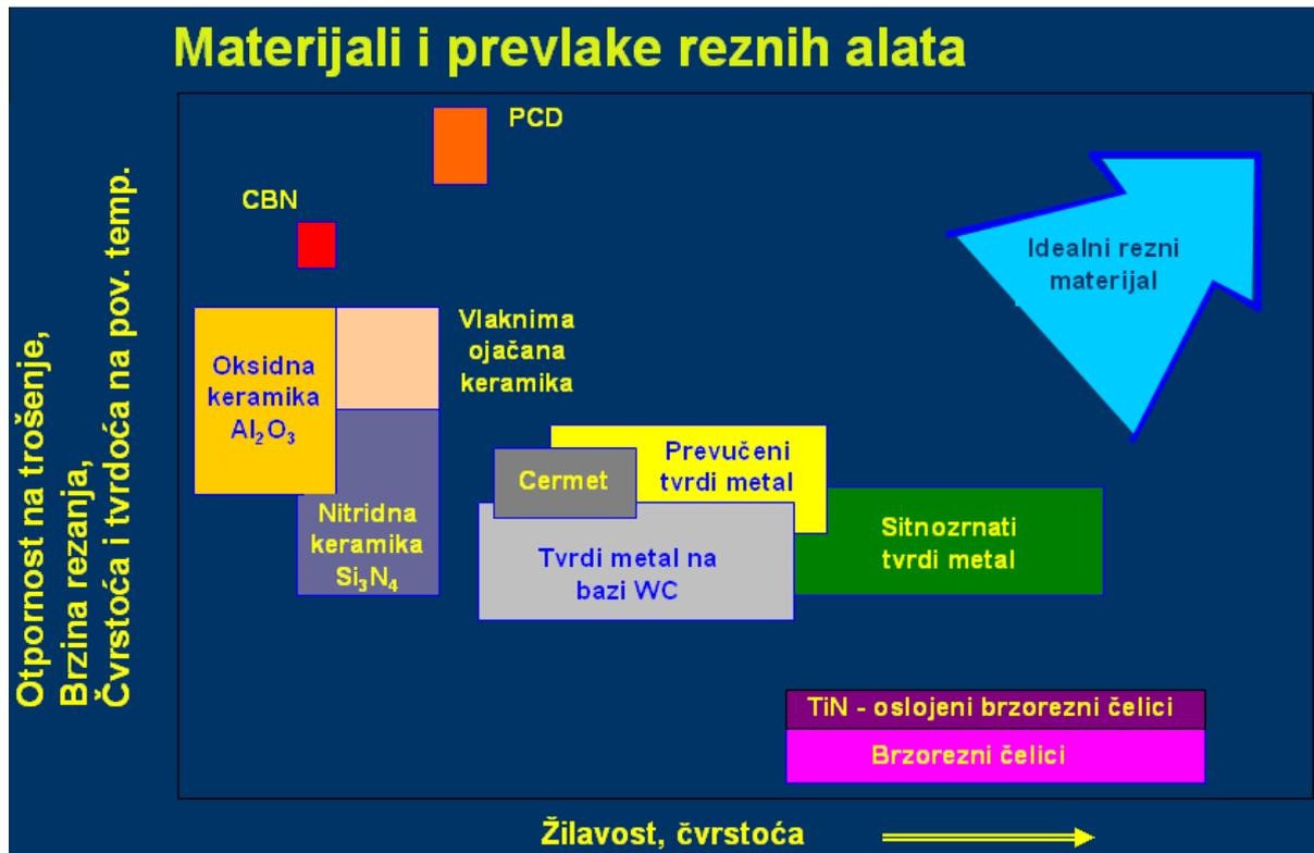
Slika 4. Materijali i prevlake reznih alata [11]
