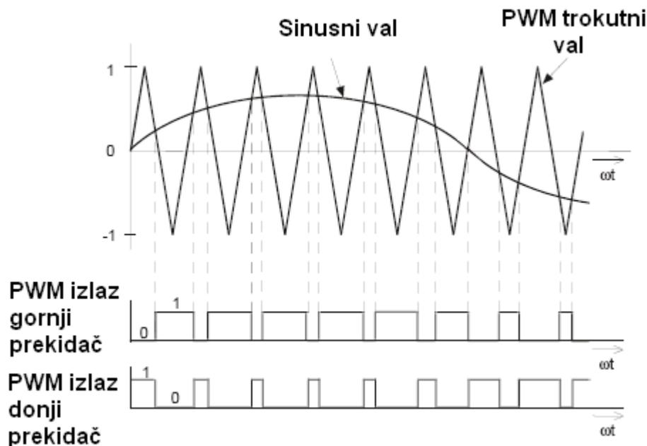
Slika 31. PWM - Pulse Width Modulation (podešavanje širine pulsa) [19]
