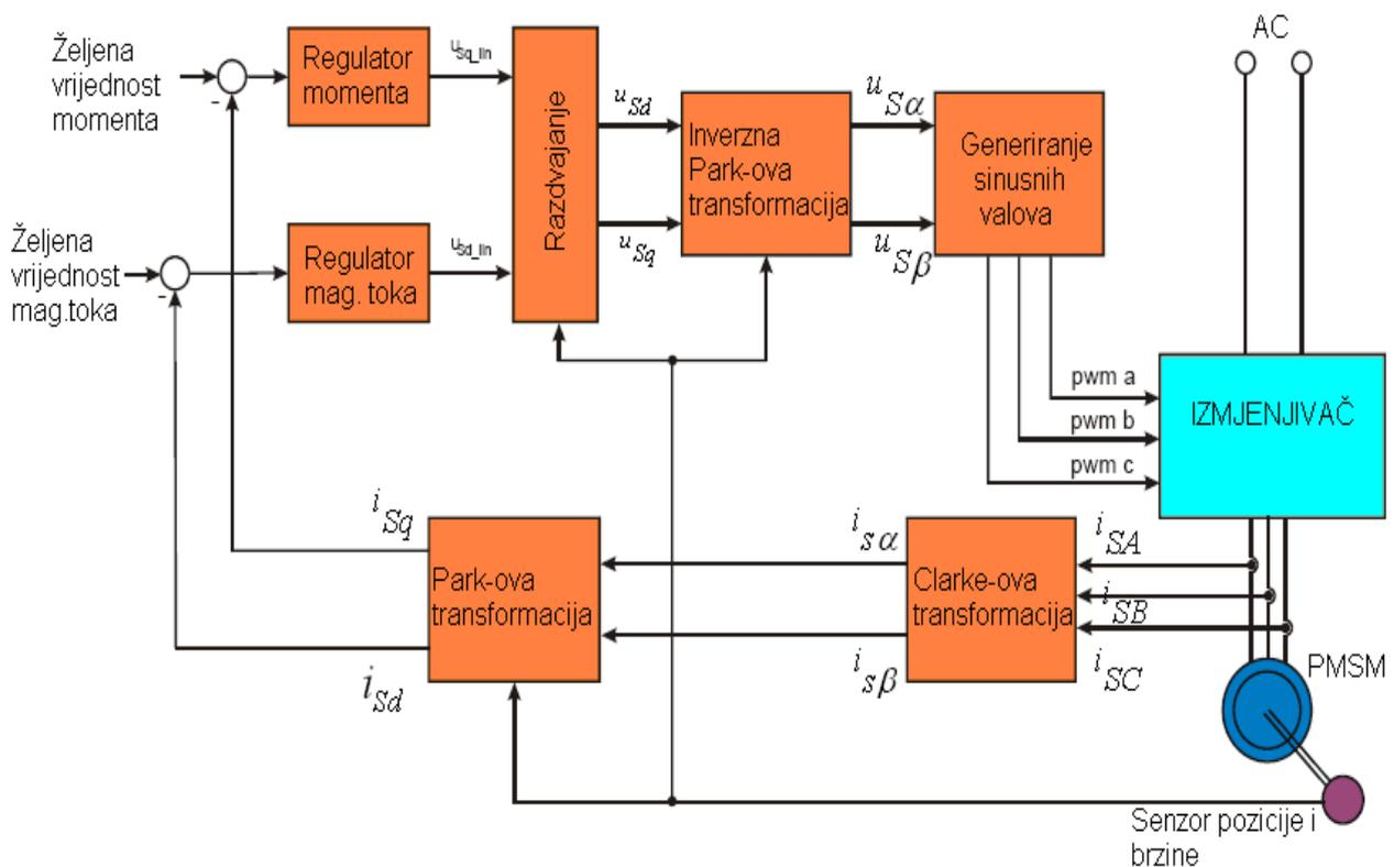
Slika 27. Blok dijagram vektorske kontrole PMSM [19]
