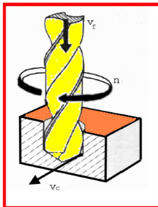
Slika 15. Shematski prikaz bušenja spiralnim svrdlom [9]
