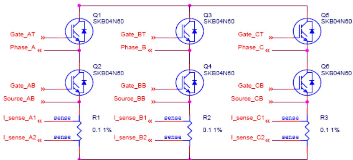
Slika 35. Mjerenje struje preko šantovih otpornika [19]
