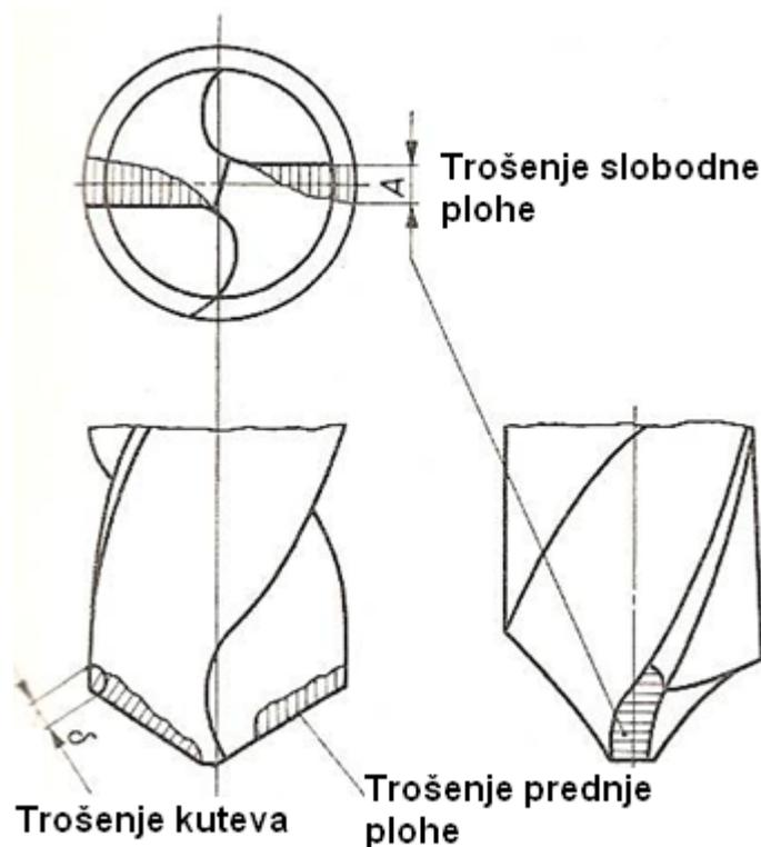
Slika 18. Prikaz trošenja reznih ploha na svrdlu [12]
