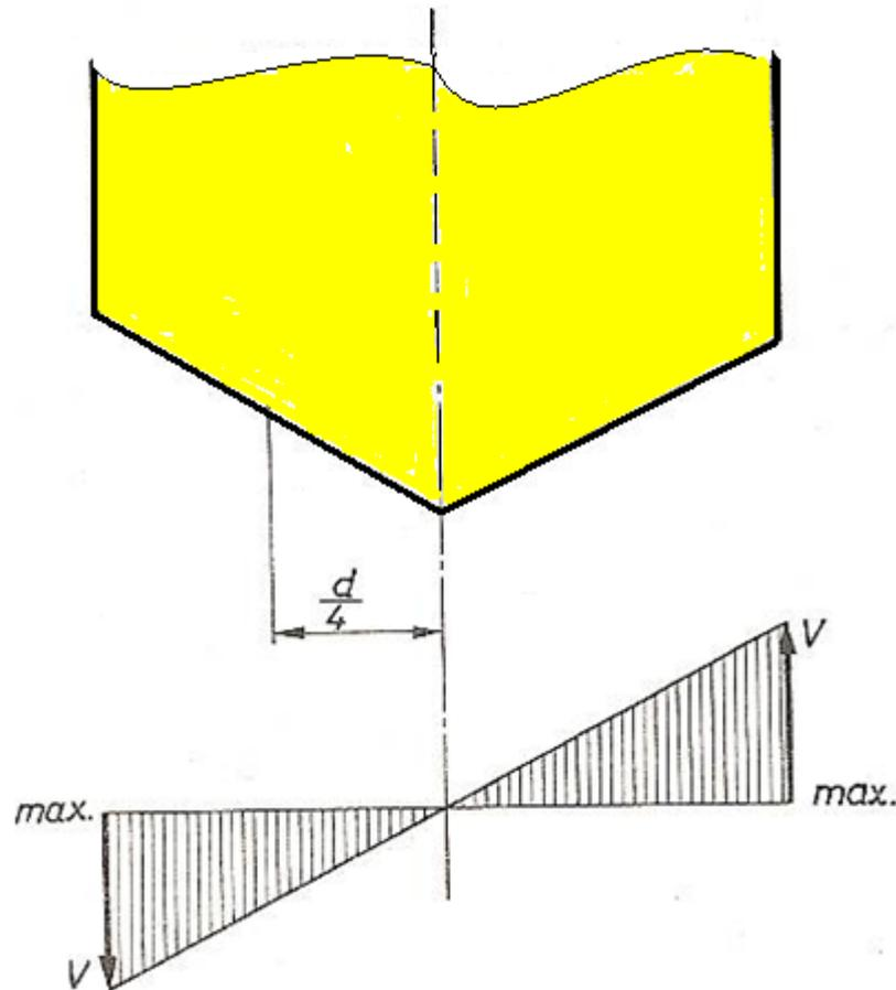
Slika 17. Prikaz raspodjele brzine rezanja po oštrici svrdla [12]
