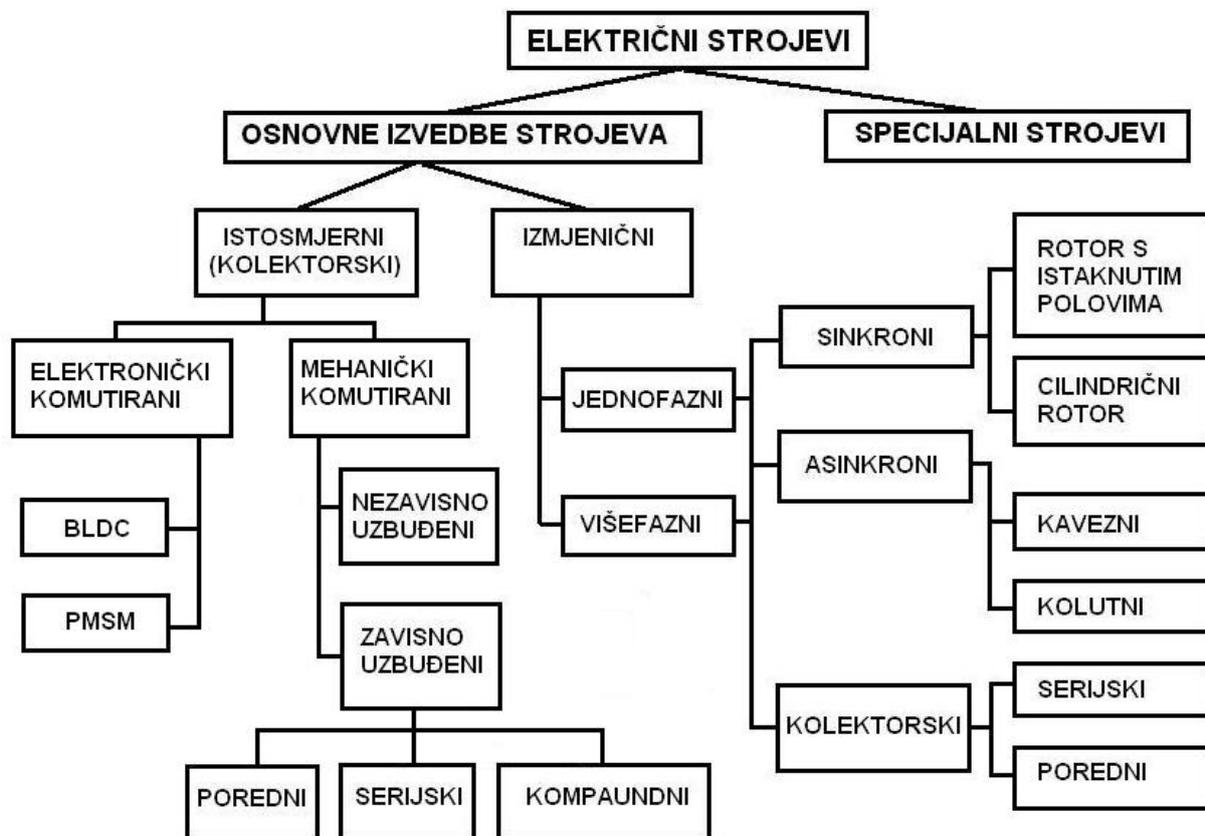
Slika 23. Podjela električnih strojeva [17]
