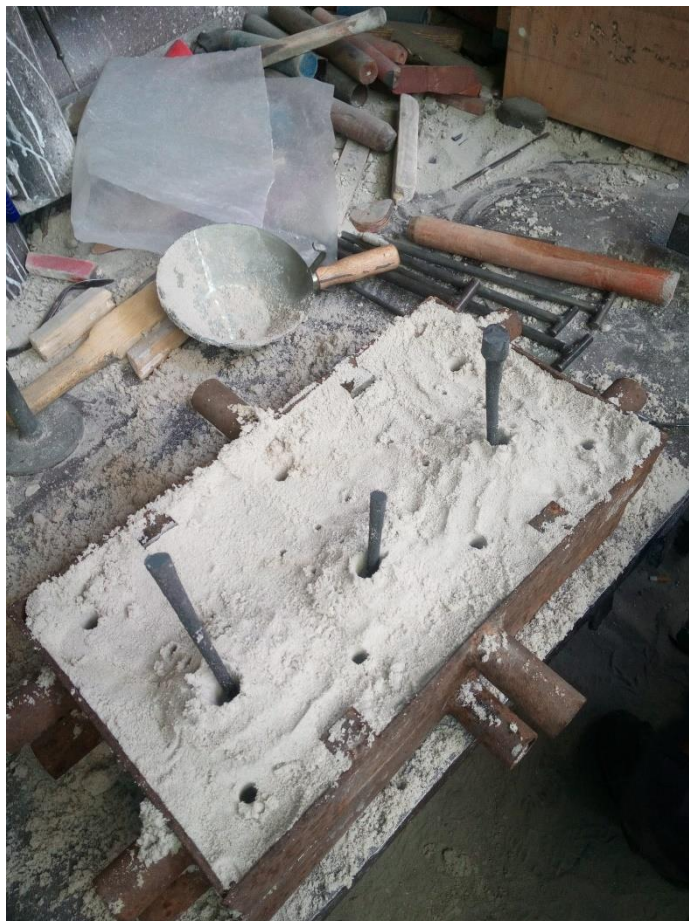
Slika 6.7. Postupak pješčanog lijeva u ljevaonici IMPK
