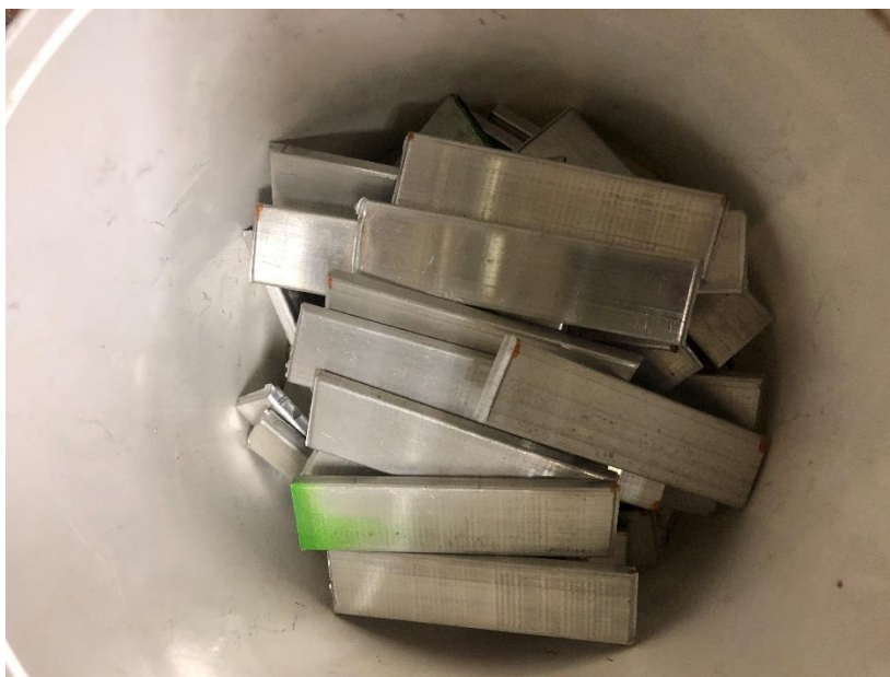
Slika 6.1.1 Korišteni prekursor sastava AlMgSi_{0,6} sa 0,4 mas % TiH_2
