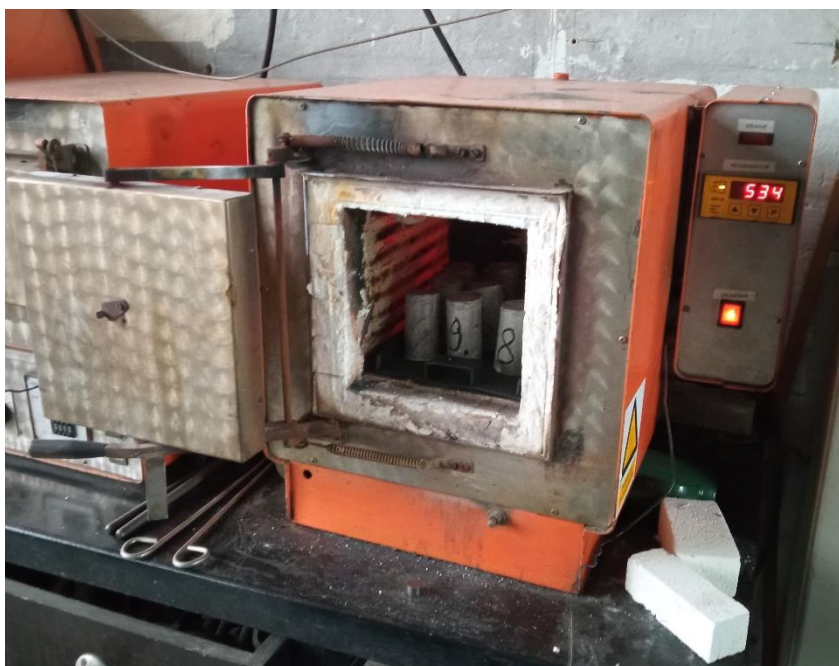
Slika 6.2.3 Komorna elektro peć
