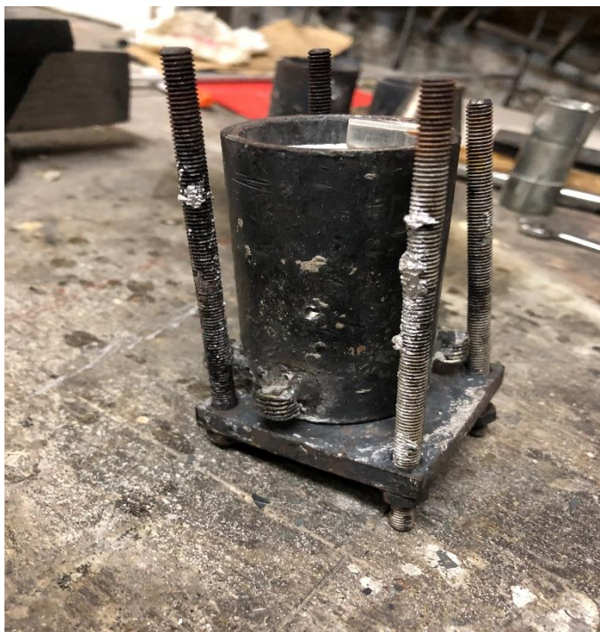
Slika 6.1.3 Rastavljeni kalup sa prekursorom
