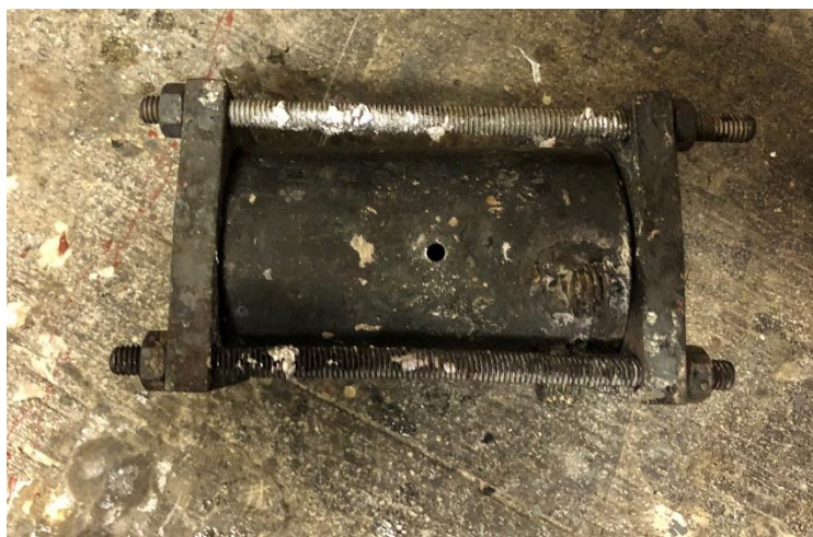
Slika 6.1.4 Sastavljeni kalup sa prekursorom
