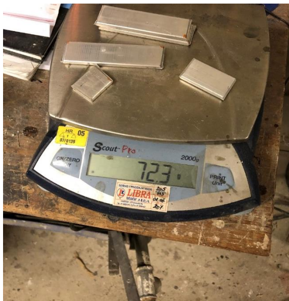
Slika 6.1.2 Vaganje aluminijskog prekursora
