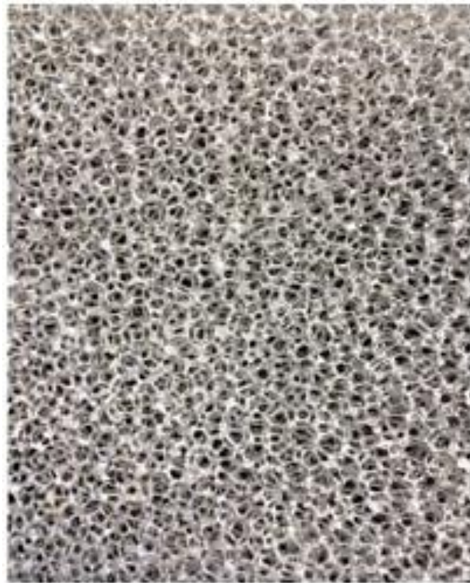
Slika 2.9.2 Prikaz mikrostrukture "ERG-Duocel" metalne pjene [6]
