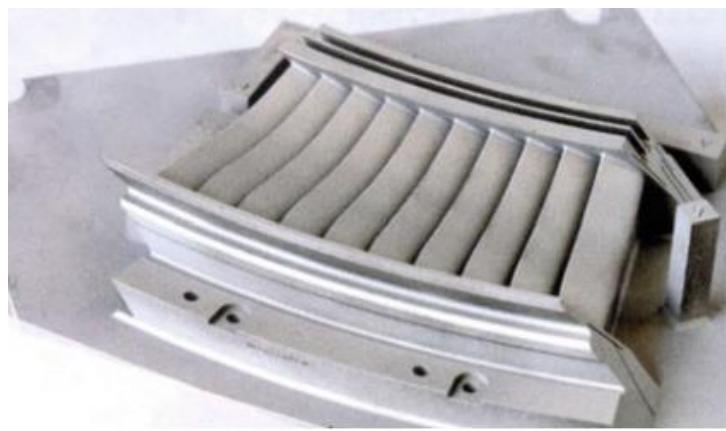
**Slika 5. Snečma – lopatica za stator motora zrakoplova [9]**
