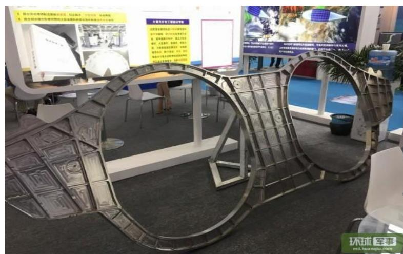
**Slika 6.** Okvir trupa zrakoplova proizведен tehnologijom selektivnog laserskog srašćivanja [10]
