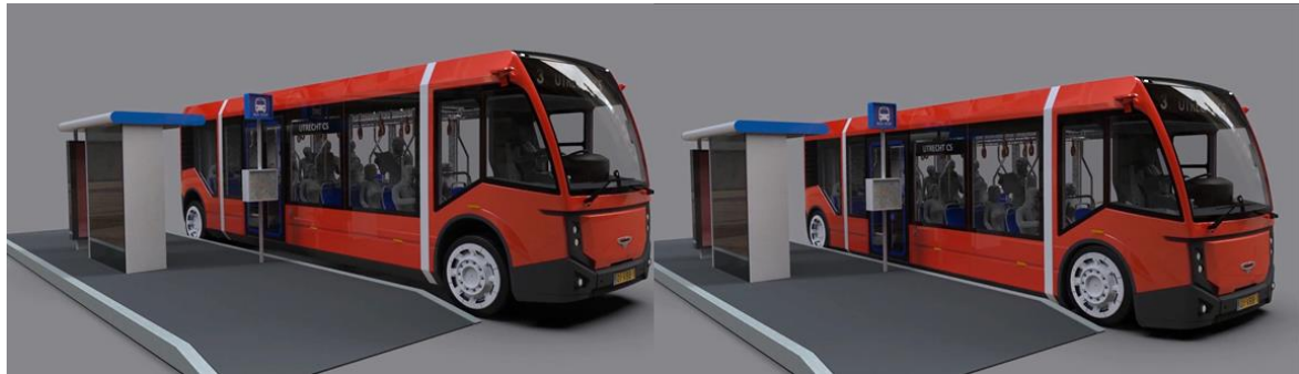
Slika 8. Prikaz spuštanja karoserije prilikom dolaska na stanicu [5]
