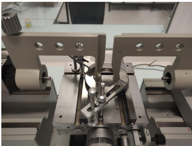
Slika 10. Postavljanje i učvršćivanje referentnog prstena
