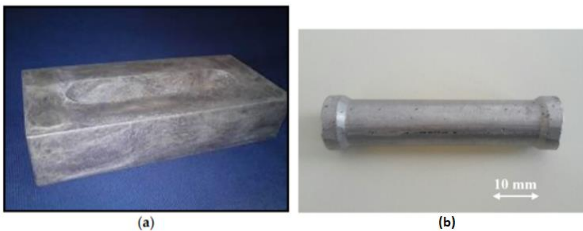
Slika 34. Apsorberi energije kod: (a) Combino tramvaja; (b) Audiya Q7 [13]
