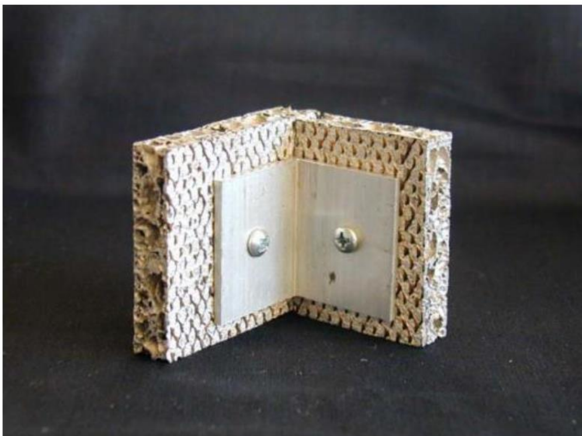
Slika 29. Spajanje metalnih pjena vijcima i kutnim profilom [7]
