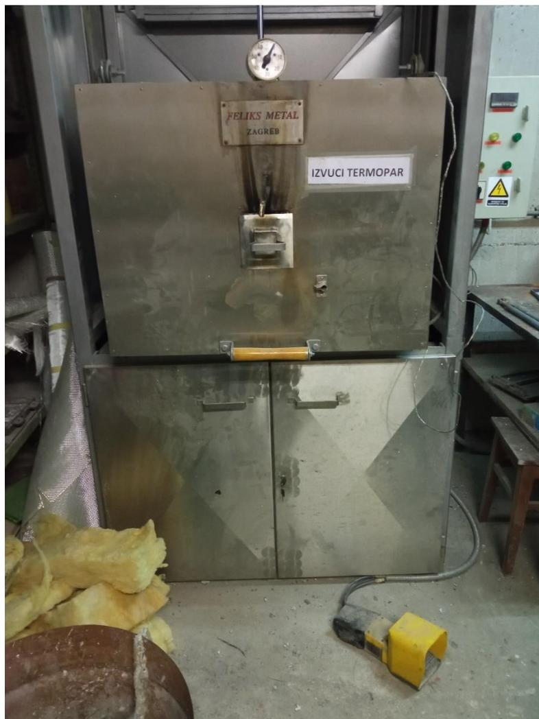
**Slika 38. Elektrootporna zvonasta peć**
