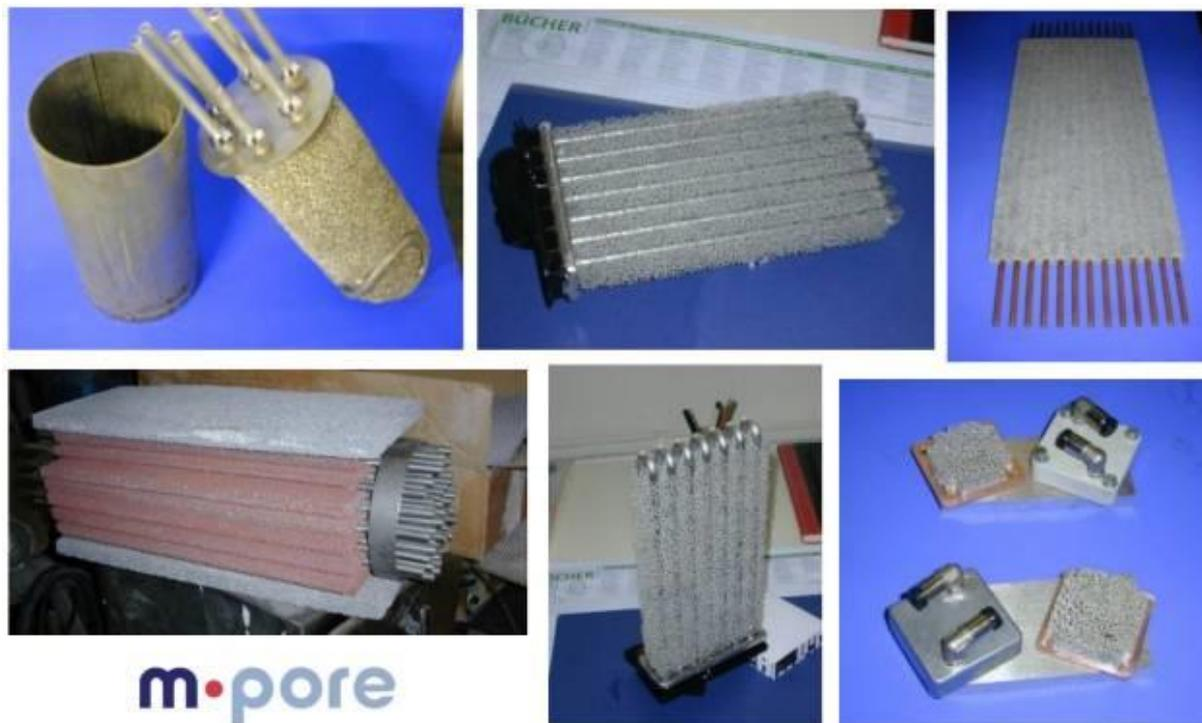
Slika 12. Izmjenjivači toplote od metalnih pjena [13]
