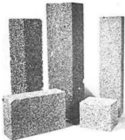
Slika 1. Blokovi od aluminijske pjene proizvedeni u Ethyl korporaciji [2]
