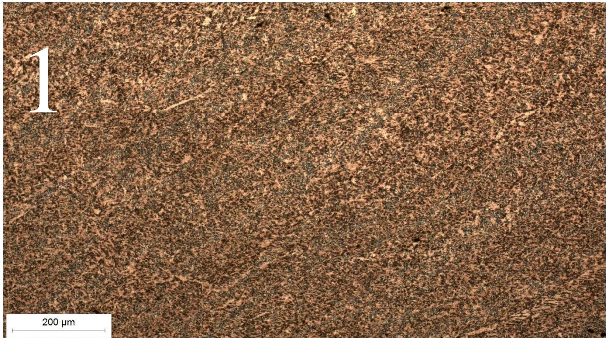
**Slika 51. Mikrostruktura metala zavara, Uzorak 1**
