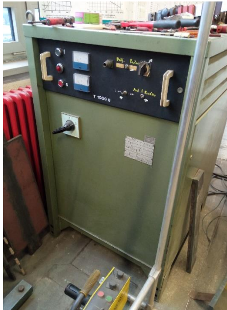
Slika 27. Izvor struje korišten za EPP zavarivanje
