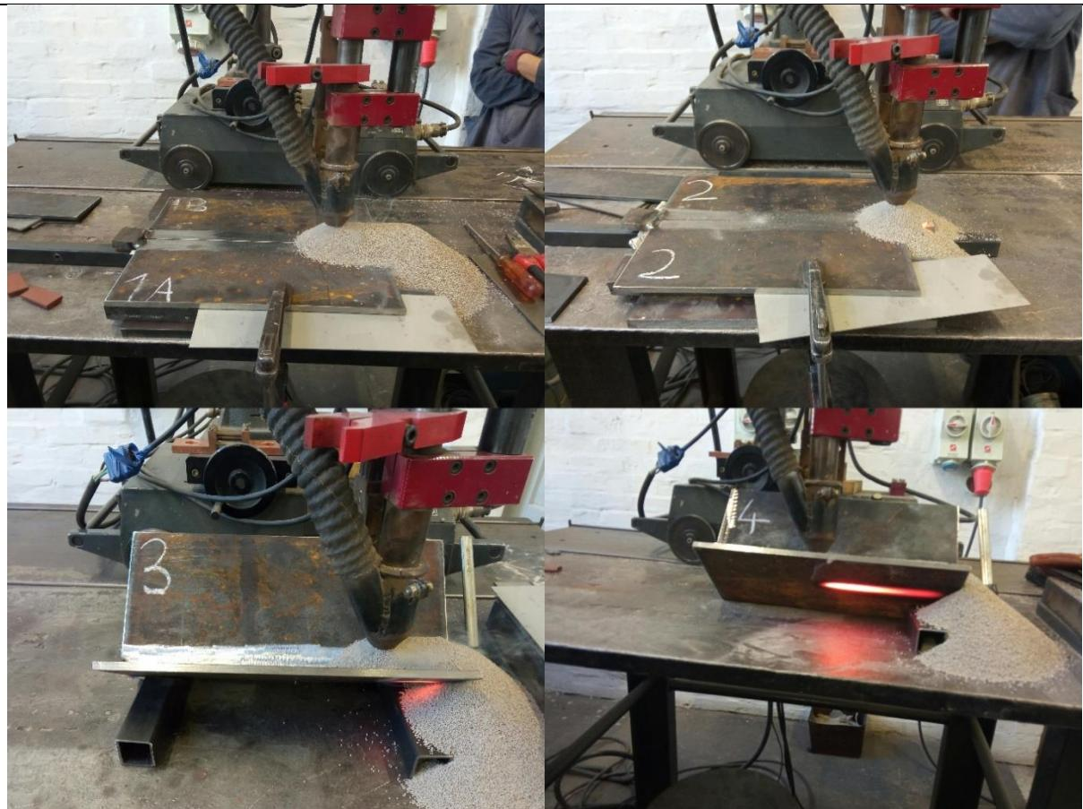
**Slika 36. Postupak EPP zavarivanja 4 ispitna uzorka**
