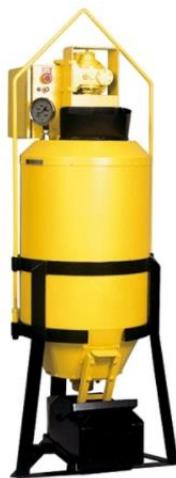
Slika 18. Uređaj za sušenje praška [19]
