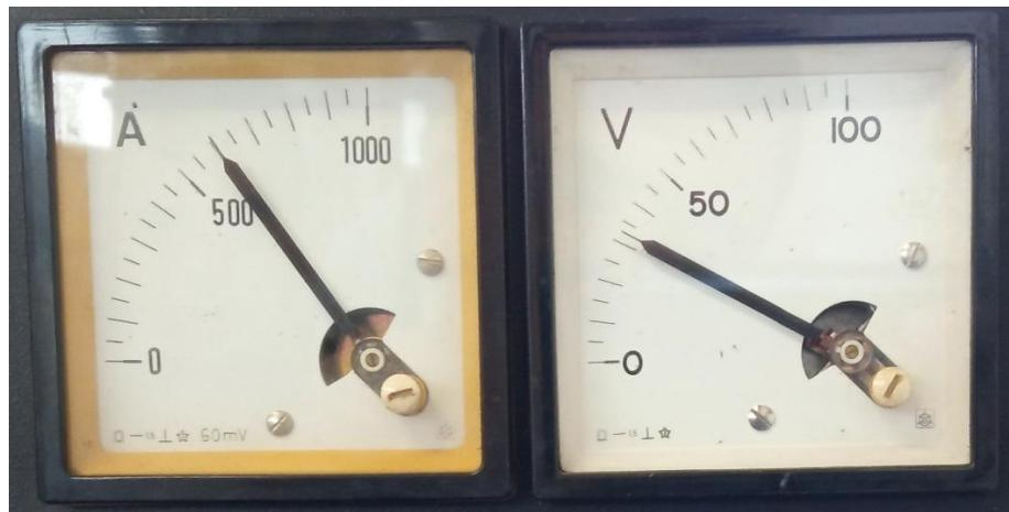
Slika 35. Iznosi struje i napona zavarivanja
