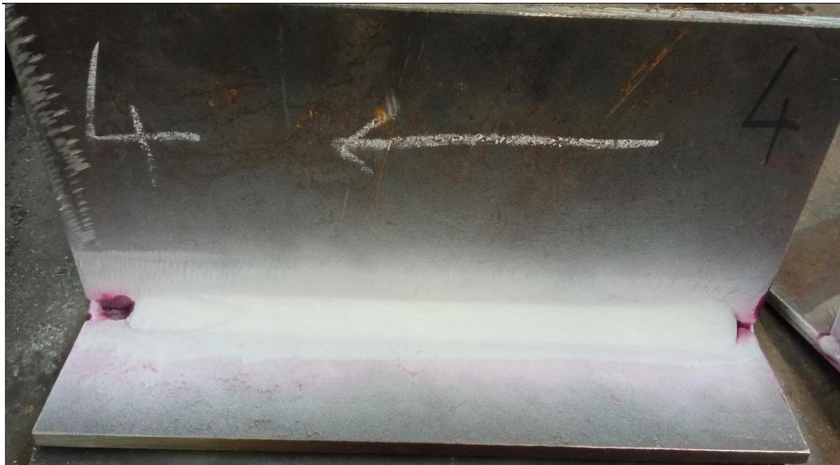
Slika 46. Ispitivanje površinskih pukotina, uzorak 4
