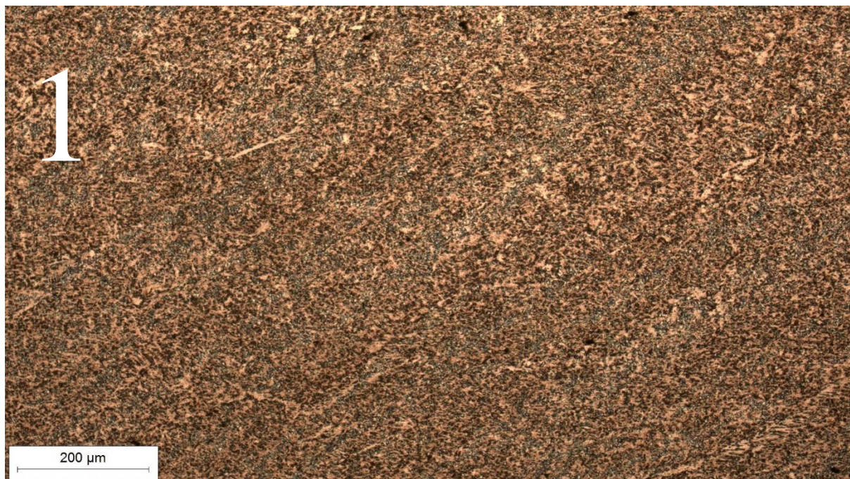
Slika 51. Mikrostruktura metala zavara, Uzorak 1
