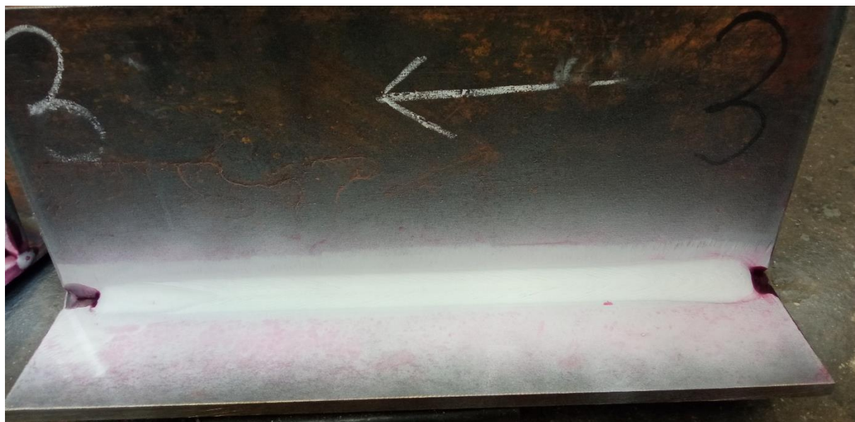
Slika 45. Ispitivanje površinskih pukotina, uzorak 3
