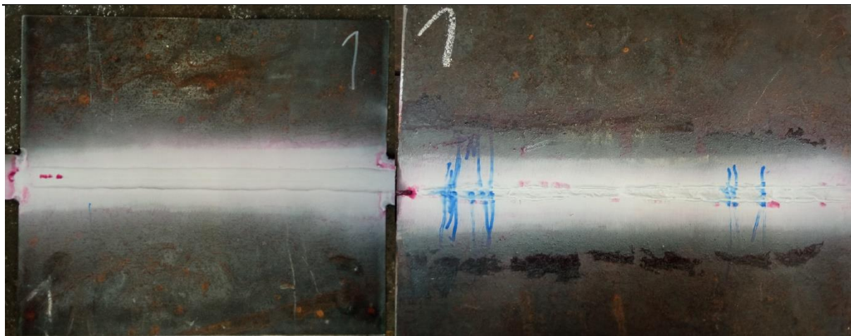
Slika 43. Ispitivanje površinskih pukotina, uzorak 1; lijevo lice, desno korijen
