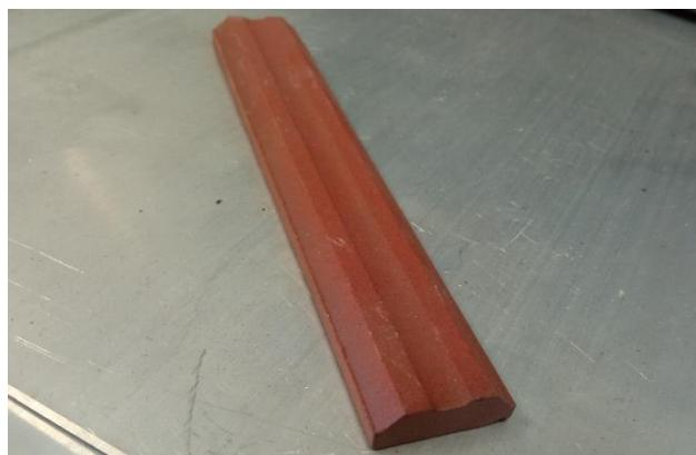
**Slika 31.** Keramička podloga za zavarivanje
