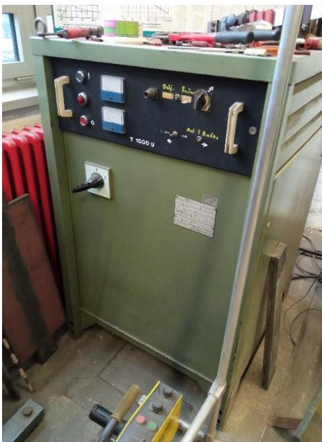
Slika 27. Izvor struje korišten za EPP zavarivanje
