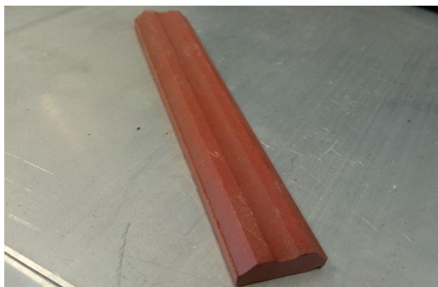
Slika 31. Keramička podloga za zavarivanje
