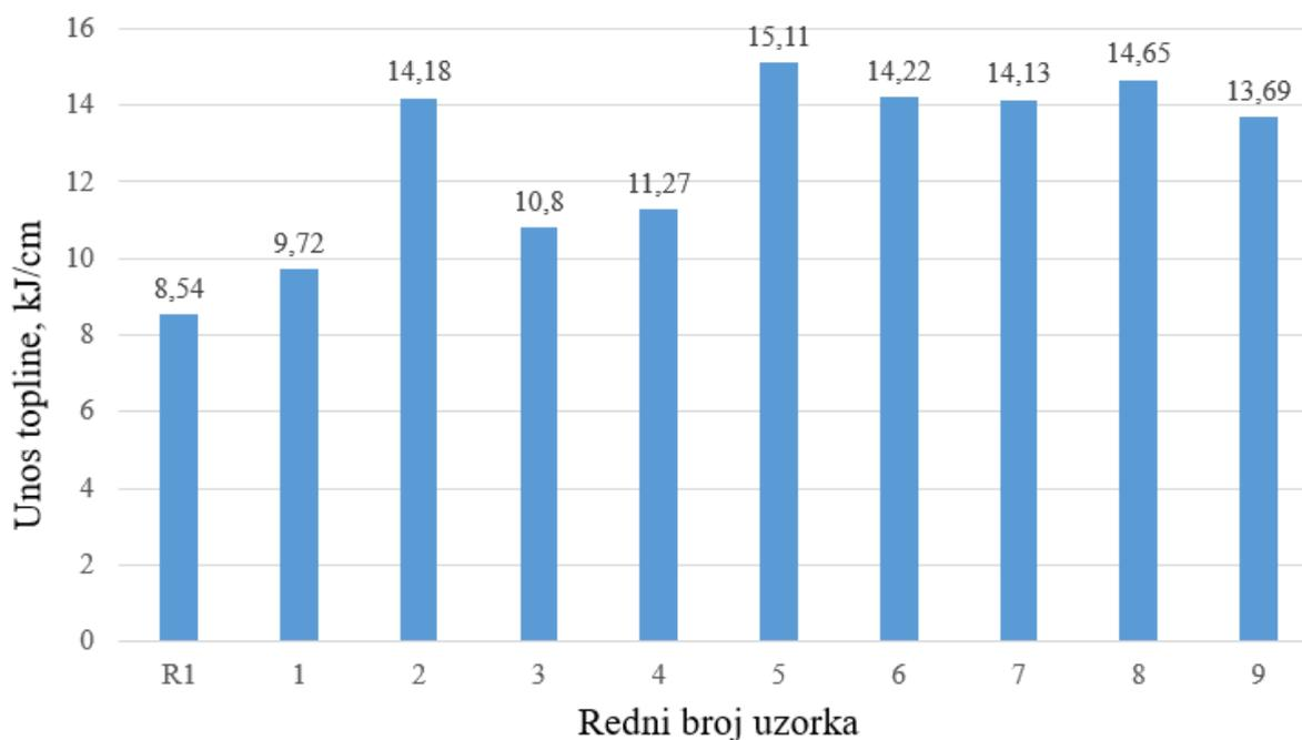
Slika 61. Grafički prikaz iznosa unosa topline pojedinog uzorka
