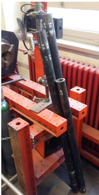
Slika 54. Cijevi čelika P91 korištene u postupku zavarivanja
