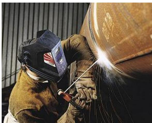
Slika 43. REL postupak zavarivanja [22]
