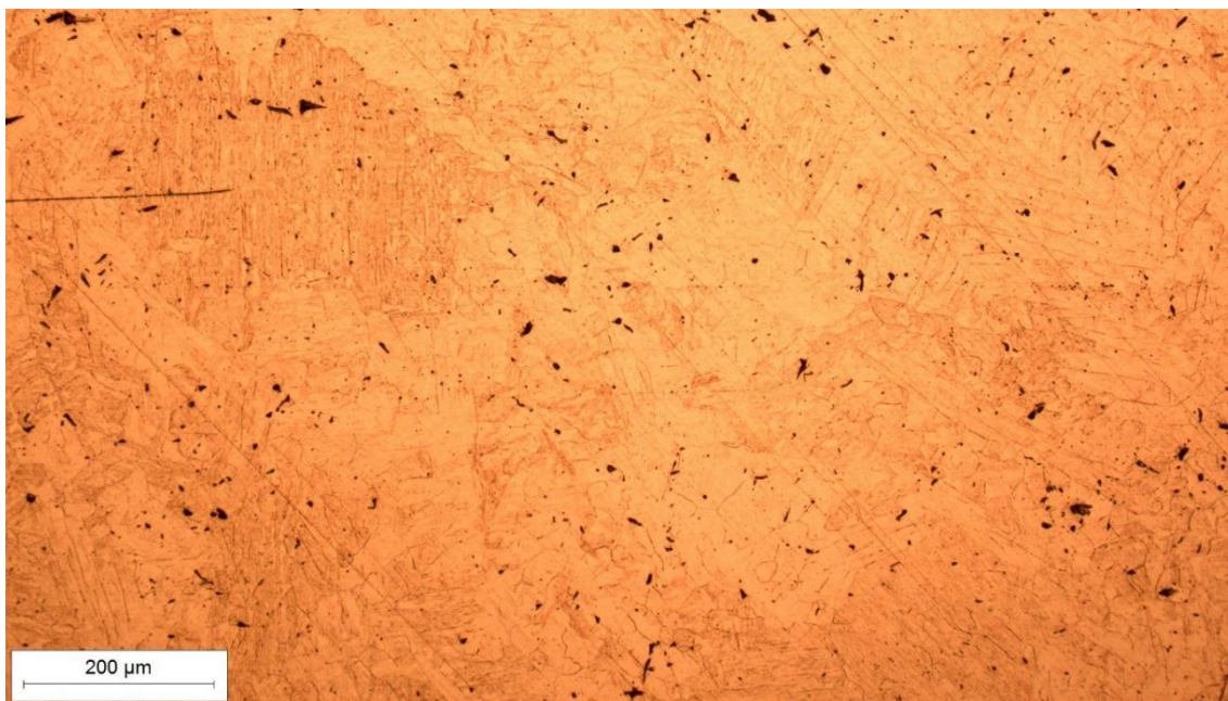
Slika 87. Mikroskopska snimka zone taljenja ispitnog uzorka 8 pod uvećanjem 100 puta
