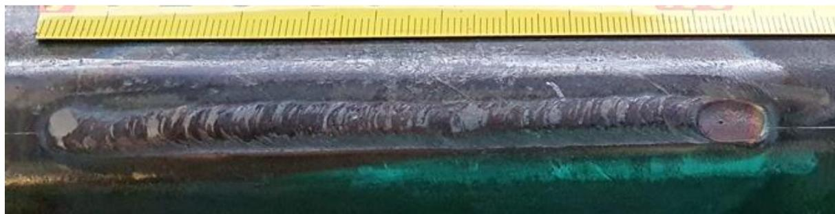
Slika 60. Referentni uzorak R1 pretaljivan istosmjernom strujom
