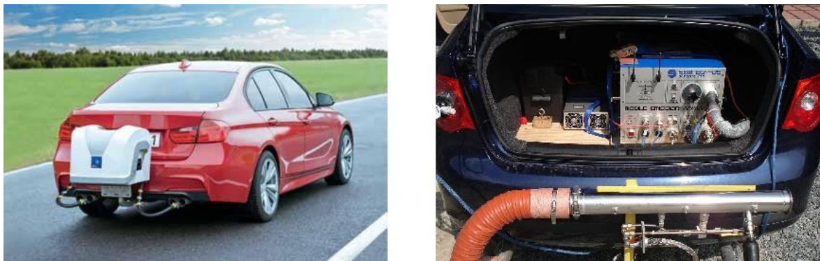
Slika 14. PEMS uređaj ugrađen na auto kuki (lijevo) i u prtljažniku (desno) [11]
