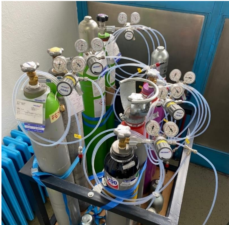
Slika 36. Plinovi korišteni za kalibraciju mjernog sustava
