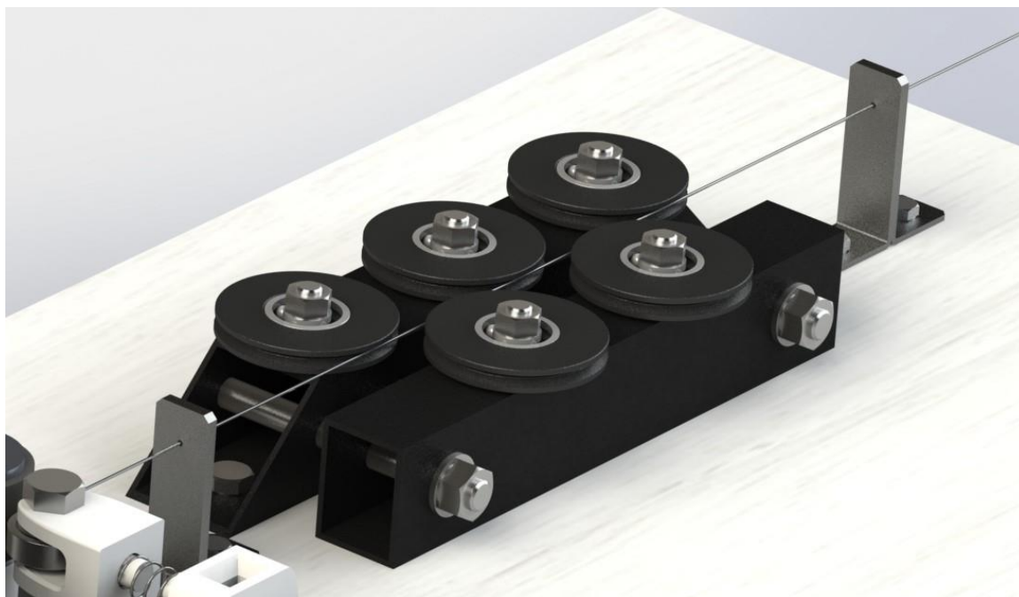
Slika 26. Mehanizam ravnjanja i vođenja žice
