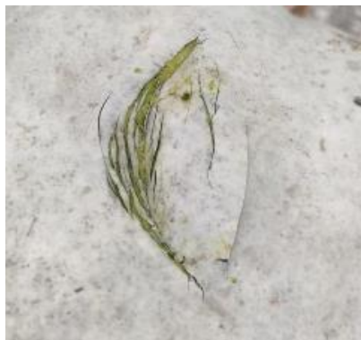
Slika 34. Oštećenje na bundevi nakon ispuštanja utega mase 2 kg s visine 2 m
