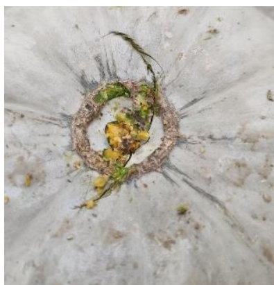
Slika 33. Oštećenje na bundevi nakon ispuštanja utega mase 2 kg s visine 1 m
