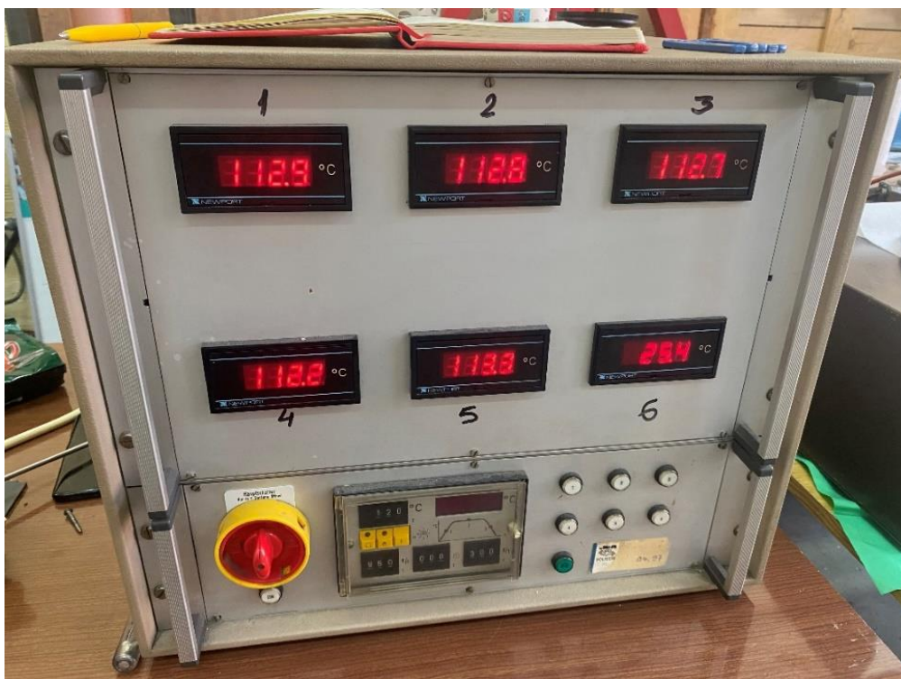
Slika 5.2. Uređaj za prikaz temperatura u uljnoj kadi
