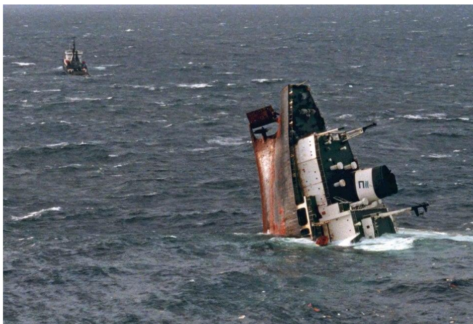
Slika 8. Havarija tankera Erika uslijed korozije [14]
