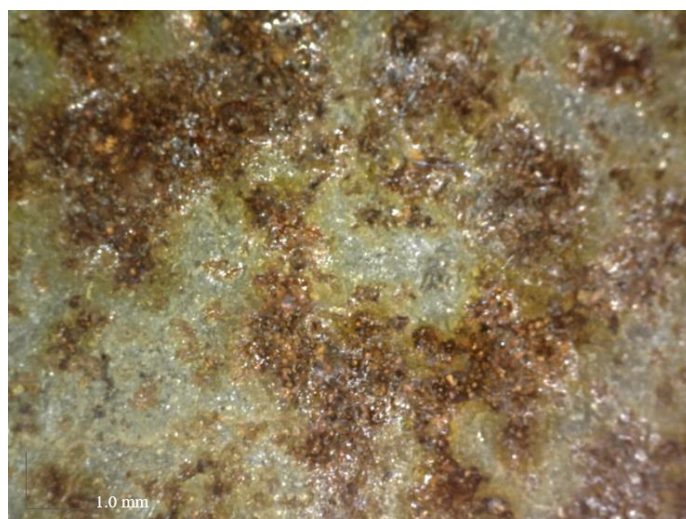
Slika 40. Površina uzorka tretiranog destiliranom vodom nakon 6 mjeseca
