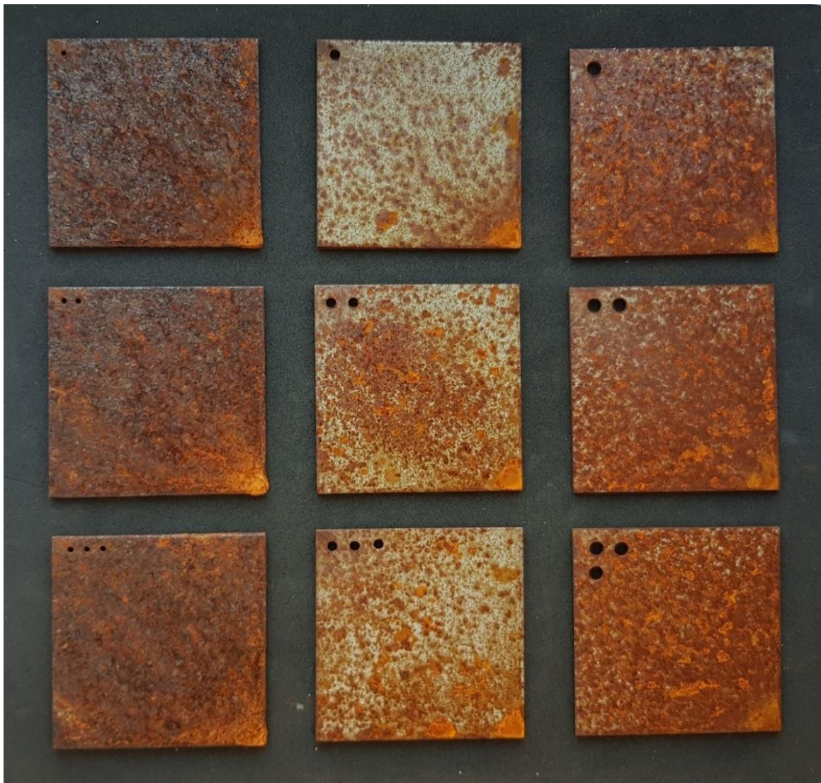
Slika 26. Površina uzoraka nakon 2 mjeseca ispitivanja
