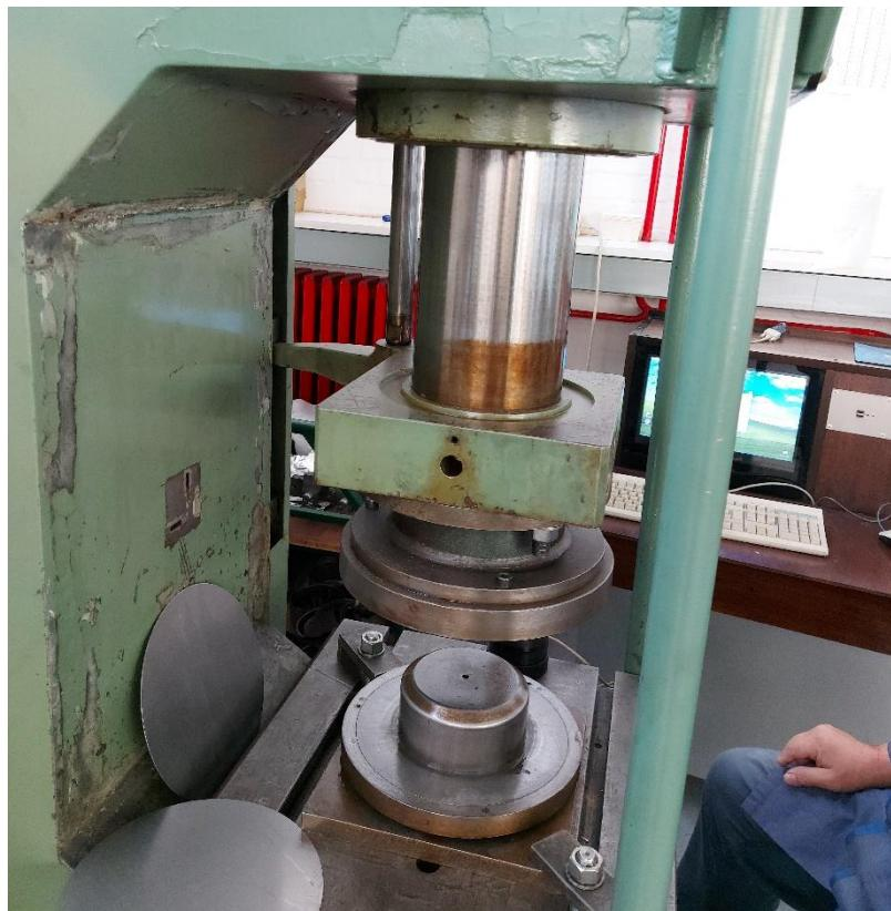
**Slika 34. Alat hidrauličke preše za duboko vučenje**
