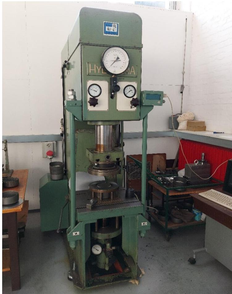
Slika 33. Hidraulička preša za duboko vučenje
