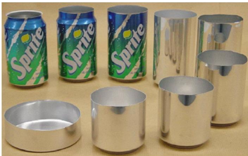
Slika 22. Proizvodnja limenke u više faza [17]
