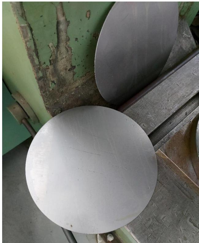
**Slika 35. Rondela za eksperimentalni postupak dubokog vučenja**
