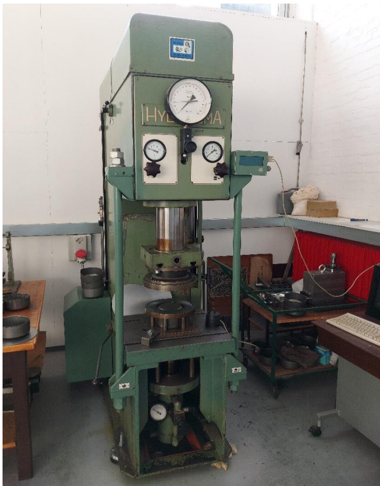
Slika 33. Hidraulička preša za duboko vučenje
