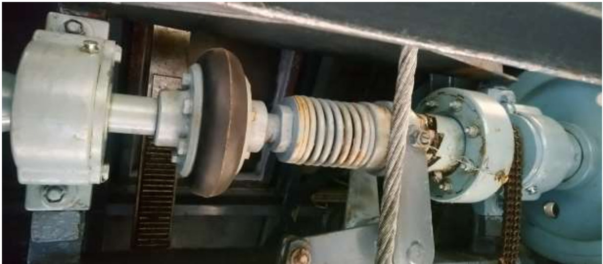
Slika 18 Sklop vanjskog i unutarnjeg vratila - 25.10.2021.
