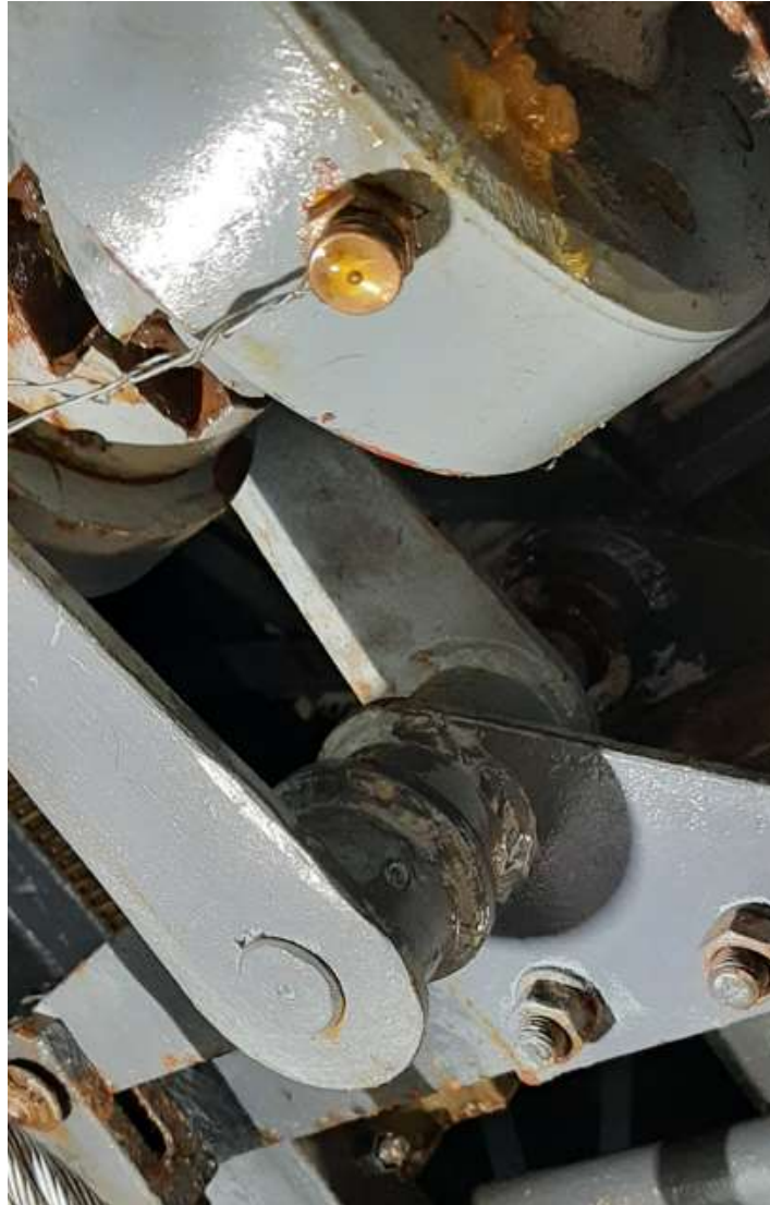
Slika 45 Aktiviranje kandžaste spojke - slika sa servisa 25.10.2021.
