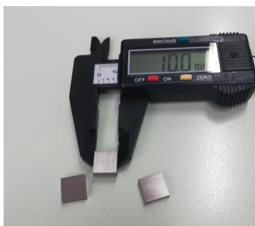
Slika 26. Izgled uzoraka za nitiranje i vanjska dimenzija
