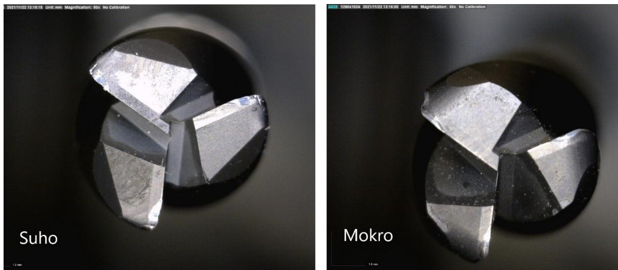
**Slika 69** Prikaz trošenja stražnje površine glodala s radijusom pod mikroskopom
