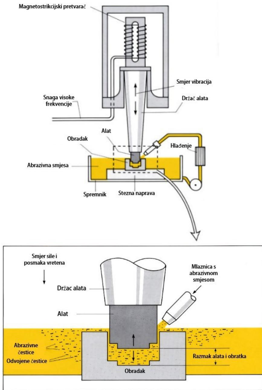
**Slika 7    Shematski prikaz sustava za obradu ultrazvukom [10]**
