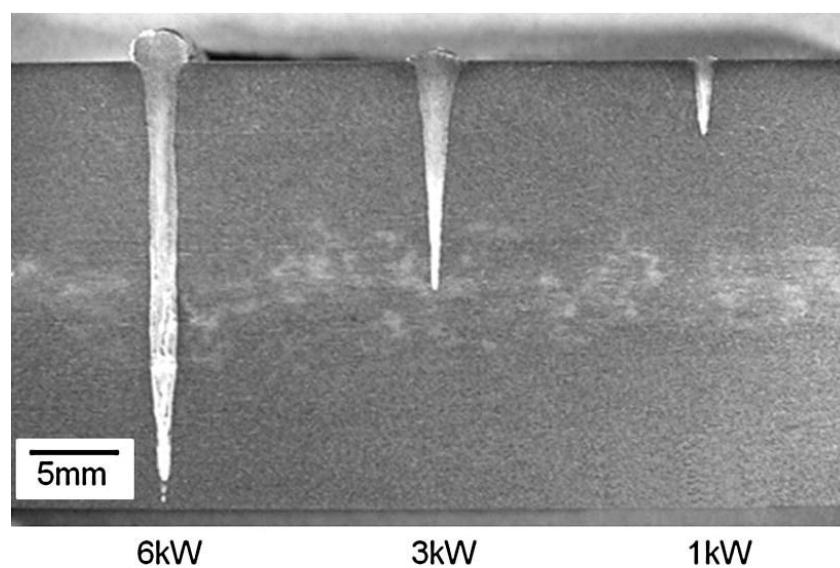
**Slika 43 Poprečni presjek zavara u aluminiju [29]**
