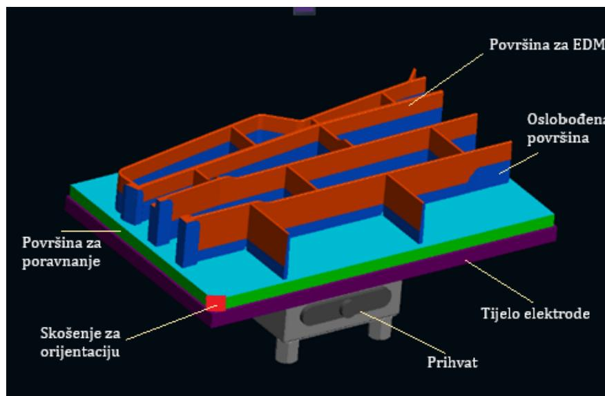
**Slika 59 3D model kreirane elektrode s osnovnim elementima**
