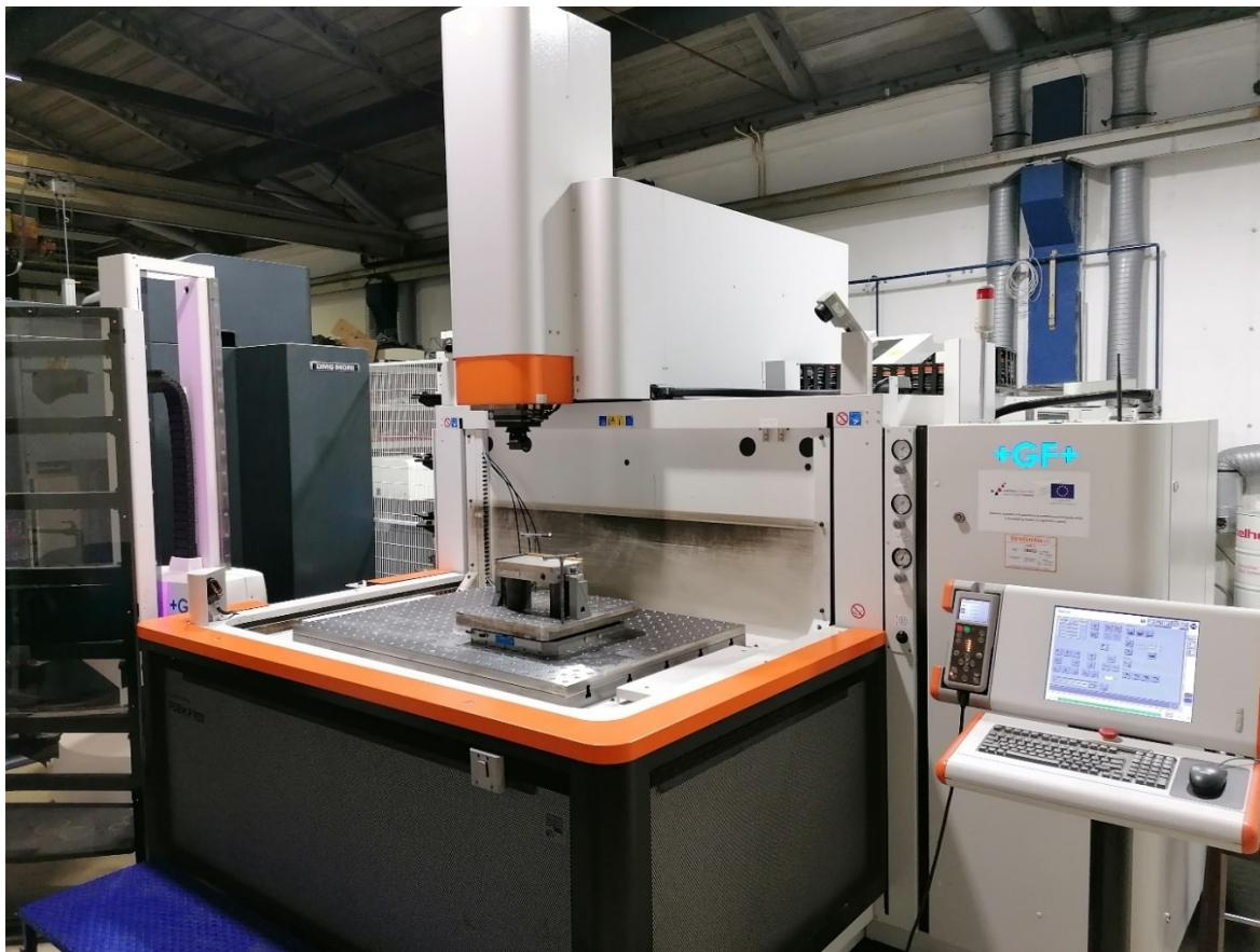
**Slika 13 Primjer stroja za obradu elektroerozijom**
