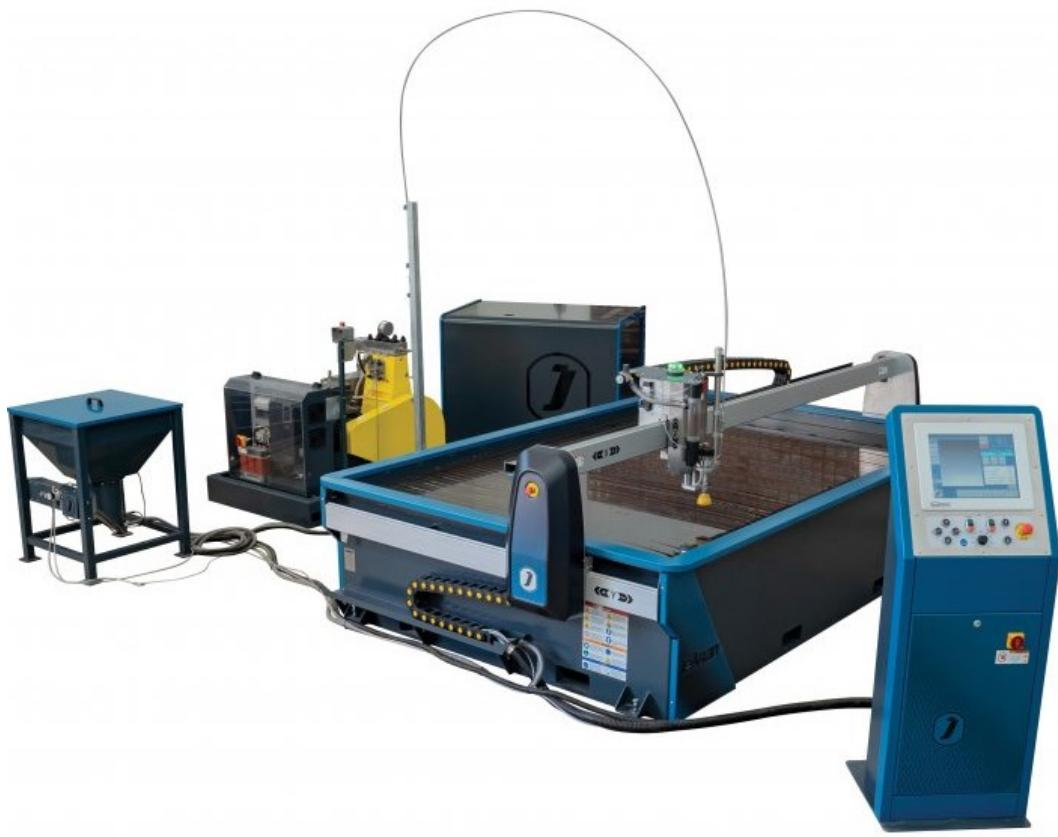
**Slika 4 Stroj za obradu vodenim mlazom [5]**
