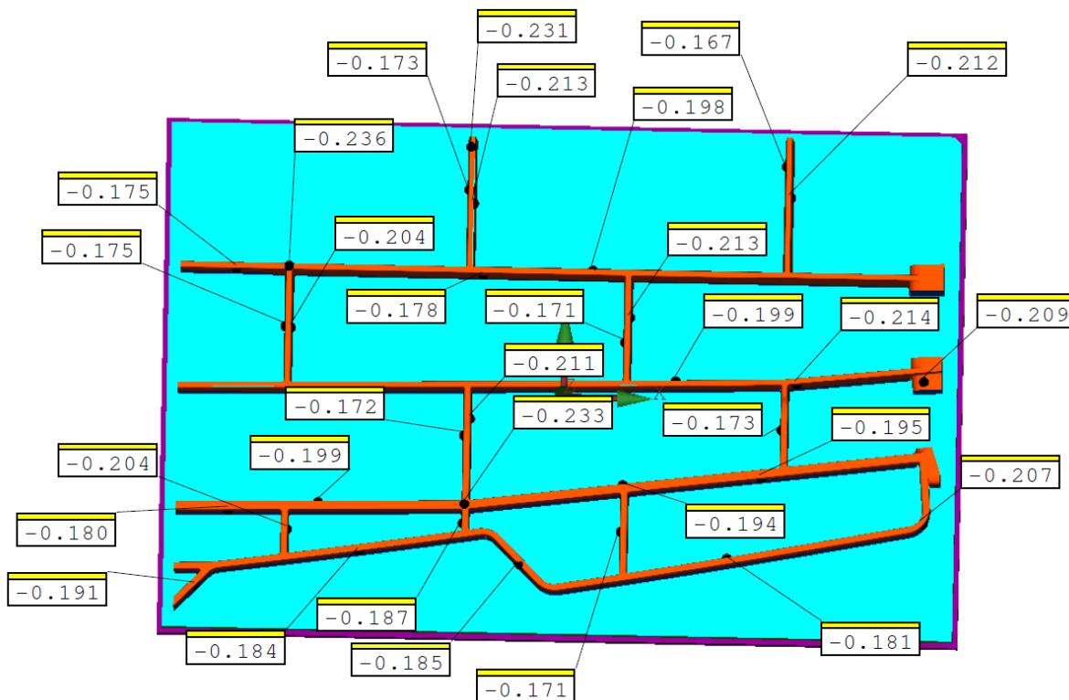
**Slika 75 Rezultati mjerena elektrode na CMM uređaju**
