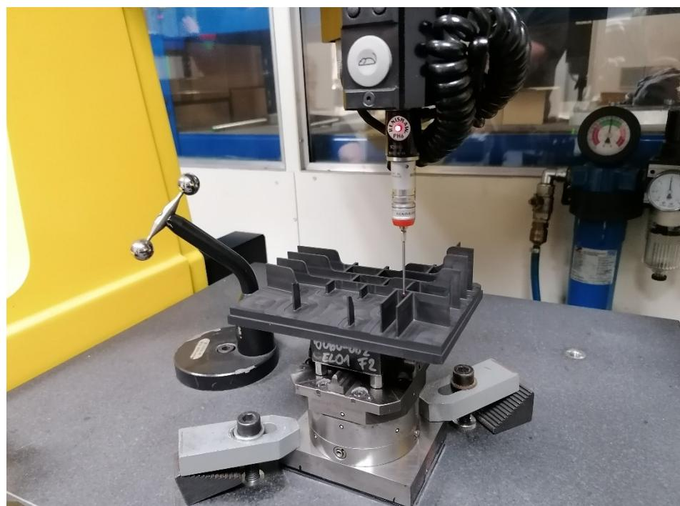
Slika 74 Mjerena elektrode na CMM uređaju
