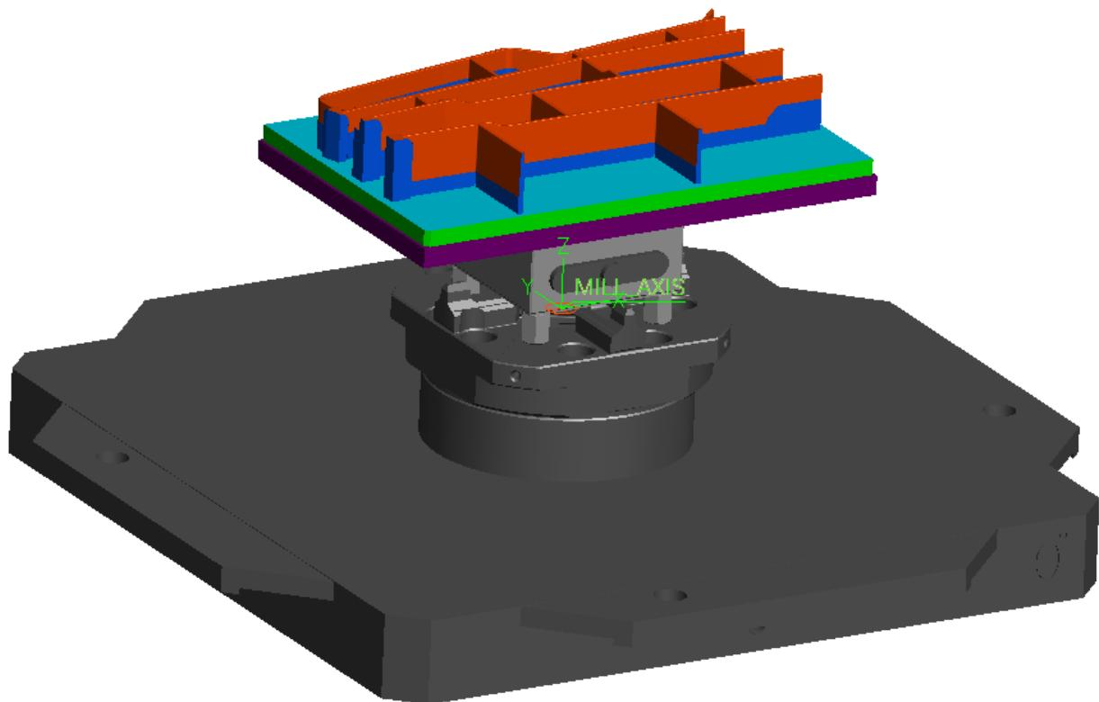
Slika 63 Elektroda stegnuta u napravu za stezanje
