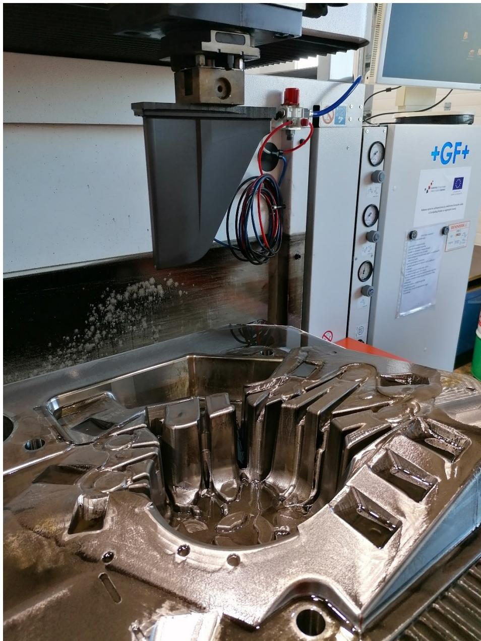
**Slika 24 Primjer EDM obrade utora kod izrade kalupa**
