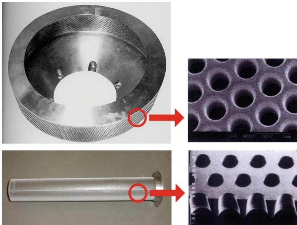
**Slika 42 Primjer obratka s provrtima malih promjera [29]**
