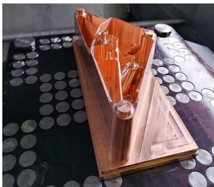
Slika 50 Primjer složene bakrene elektrode
