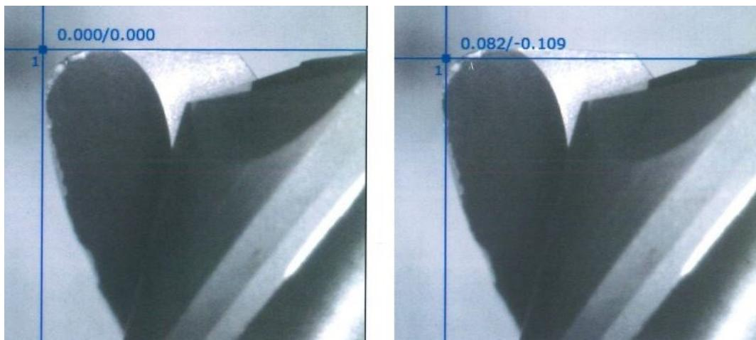
**Slika 72 Prikaz oštećenja nakon mokrog glodanja grafita**
