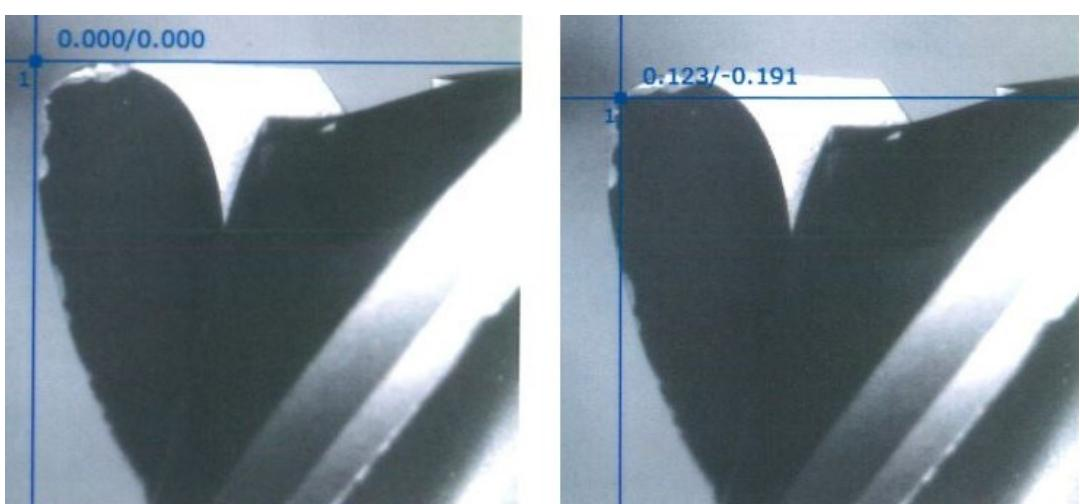
**Slika 71** Prikaz oštećenja nakon suhog glodanja grafita
