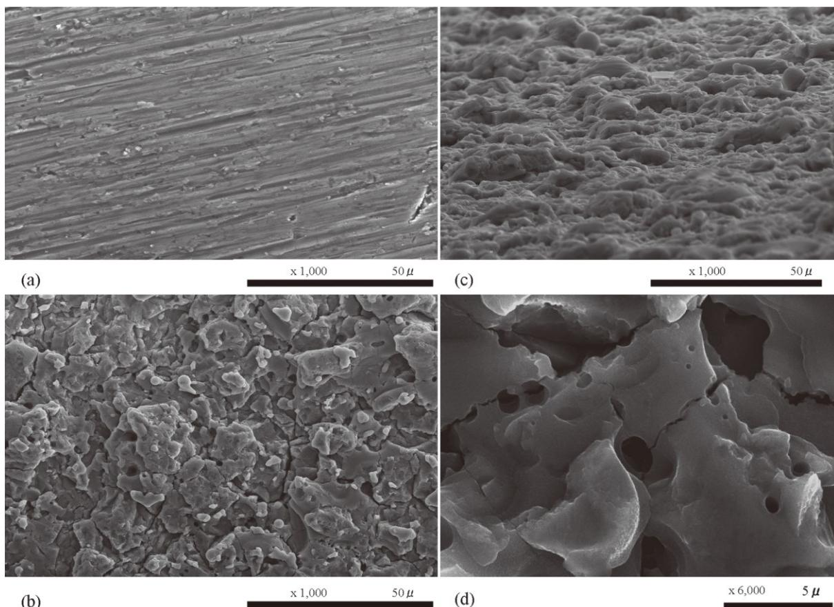
**Slika 23 Površina nakon EDM obrade promatrana elektronskim mikroskopom [17]**
