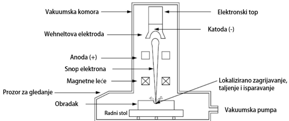
Slika 40 Shema sustava za obradu snopom elektrona [4]
