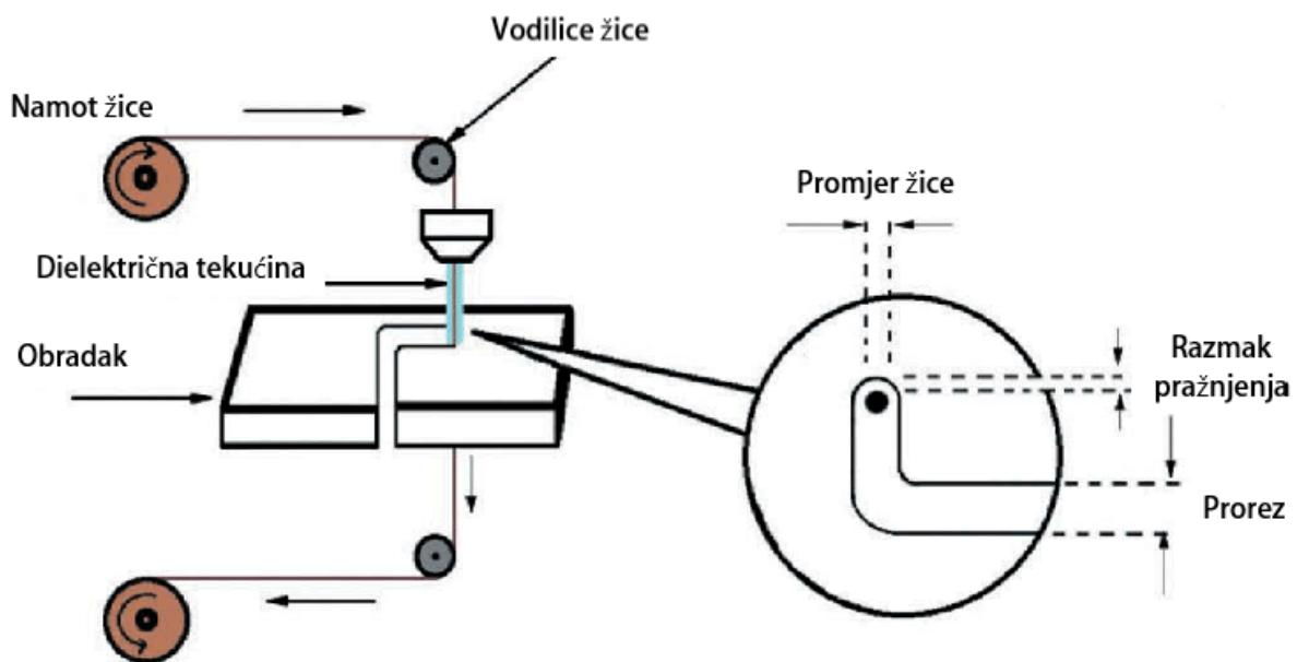
Slika 26 Shematski prikaz WEDM obrade [18]
