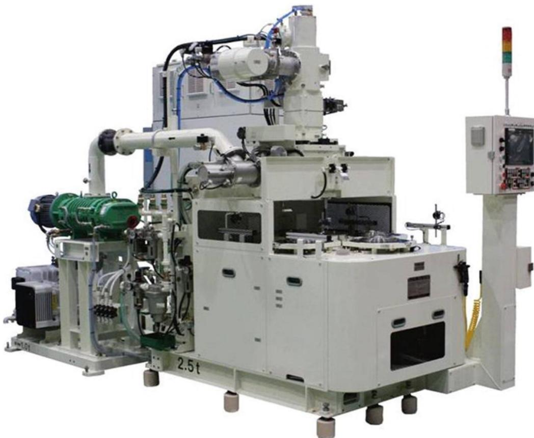
**Slika 41 Stroj za obradu snopom elektrona [29]**
