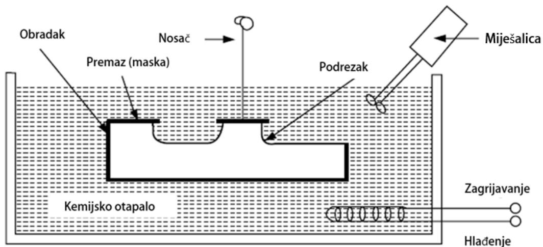
Slika 45 Shema postupka obrade kemijskog glodanja [4]
