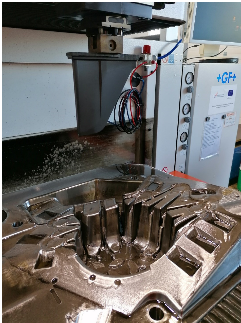
Slika 24 Primjer EDM obrade utora kod izrade kalupa
