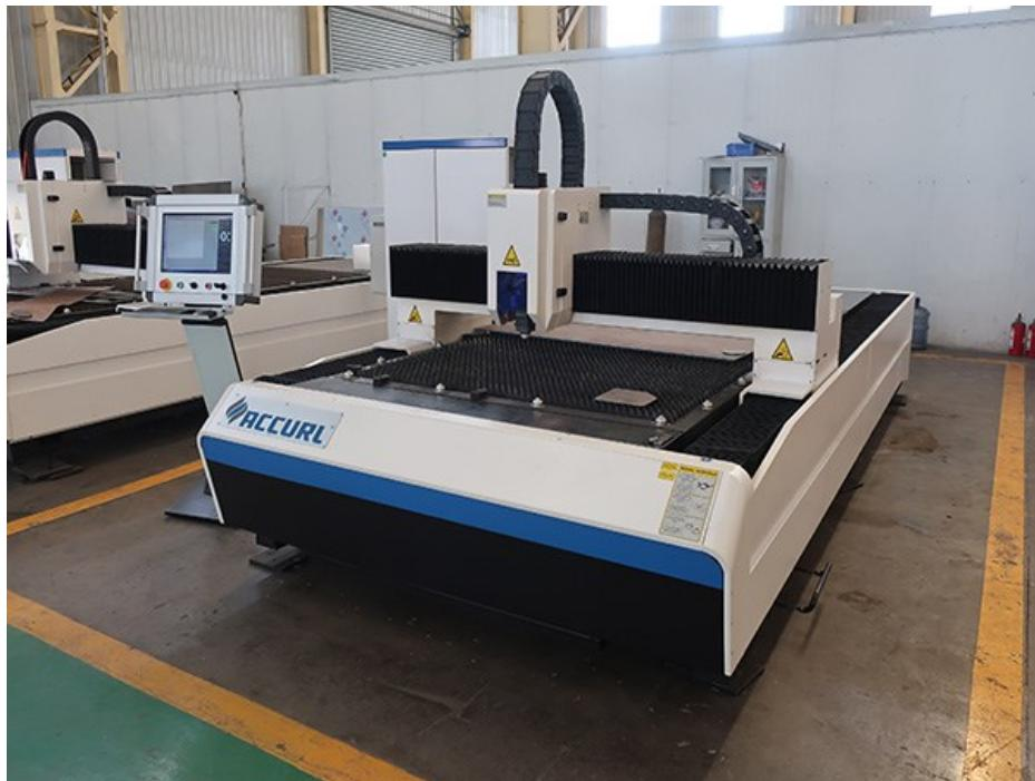
**Slika 35 CNC stroj za rezanje laserom [25]**
