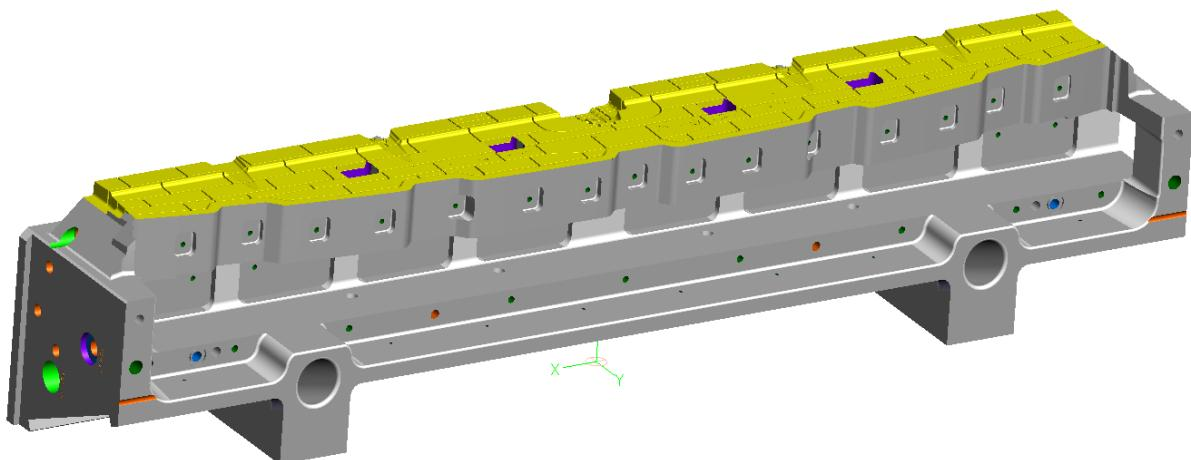
**Slika 53 Kalup za injekcijsko prešanje polimera**
