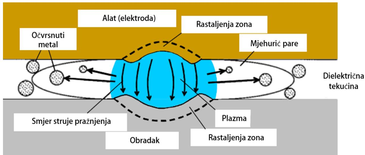
Slika 11 Proces električnog pražnjenja između elektrode i obratka [13]
