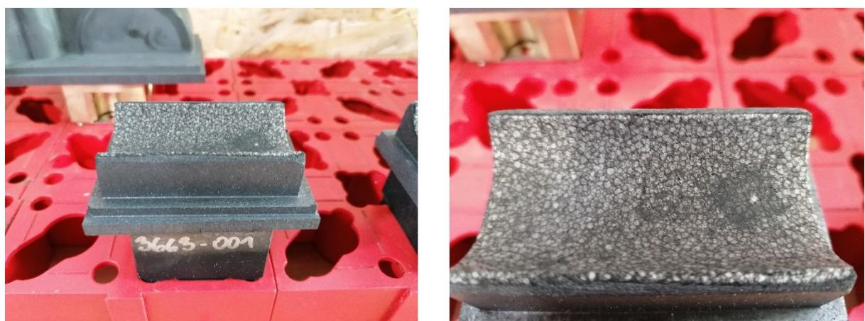
Slika 21 Površina elektrode nakon obrade na veliki  $R_a$
