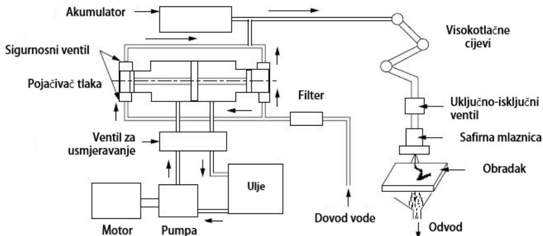
Slika 3    Shema sustava za obradu vodenim mlazom [4]
