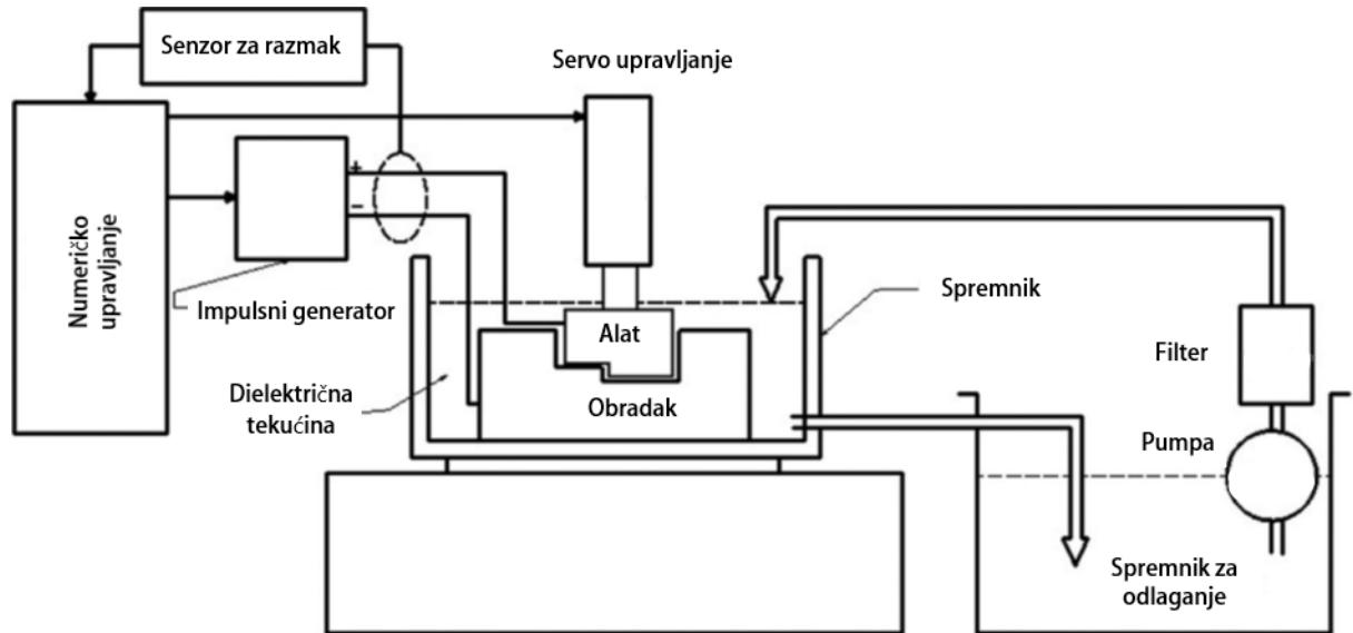
Slika 12 Shema sustava za elektroerozijsku obradu žigom [12]
