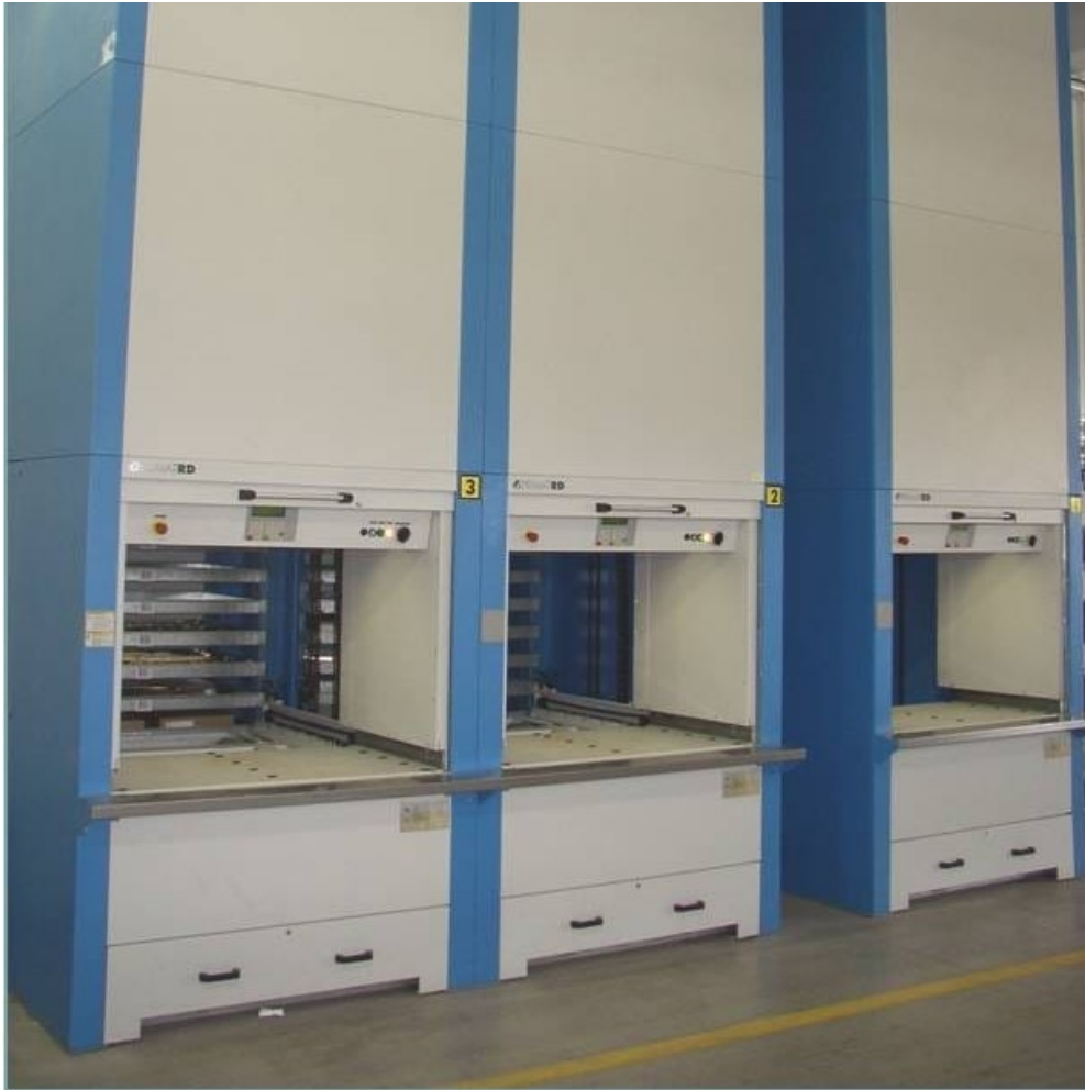
Slika 35. Vertikalni podizni moduli [21]
