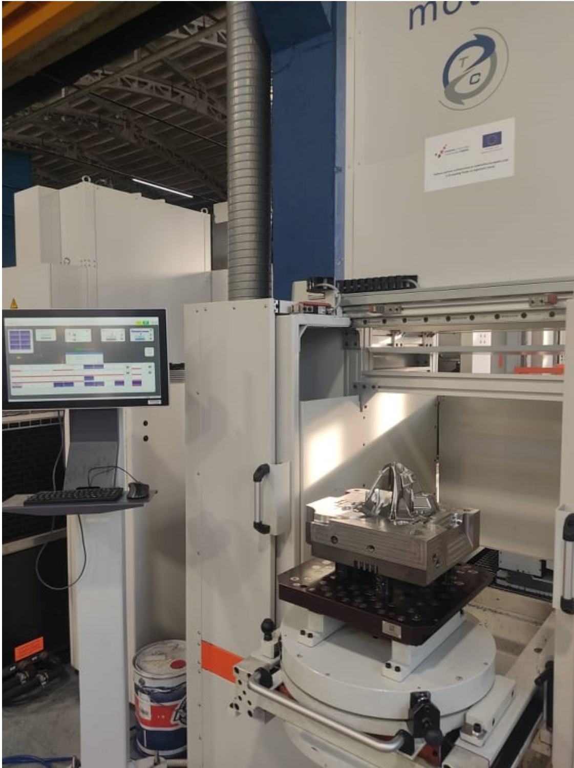
Slika 48. Kalupni uložak na set up stationu
