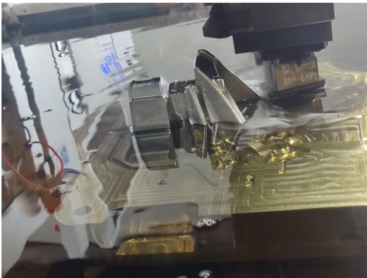
Slika 55. Proces obrade kalupnog uložka
