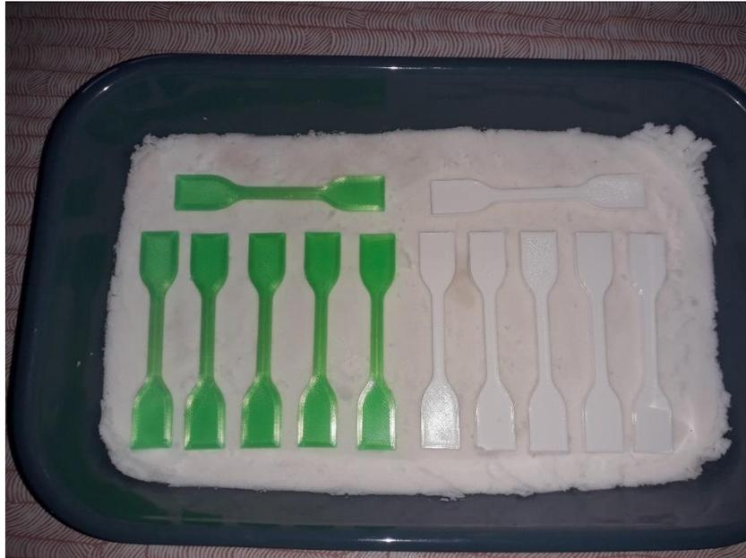
**Slika 5.9. Raspored epruveta u posudi za žarenje**
