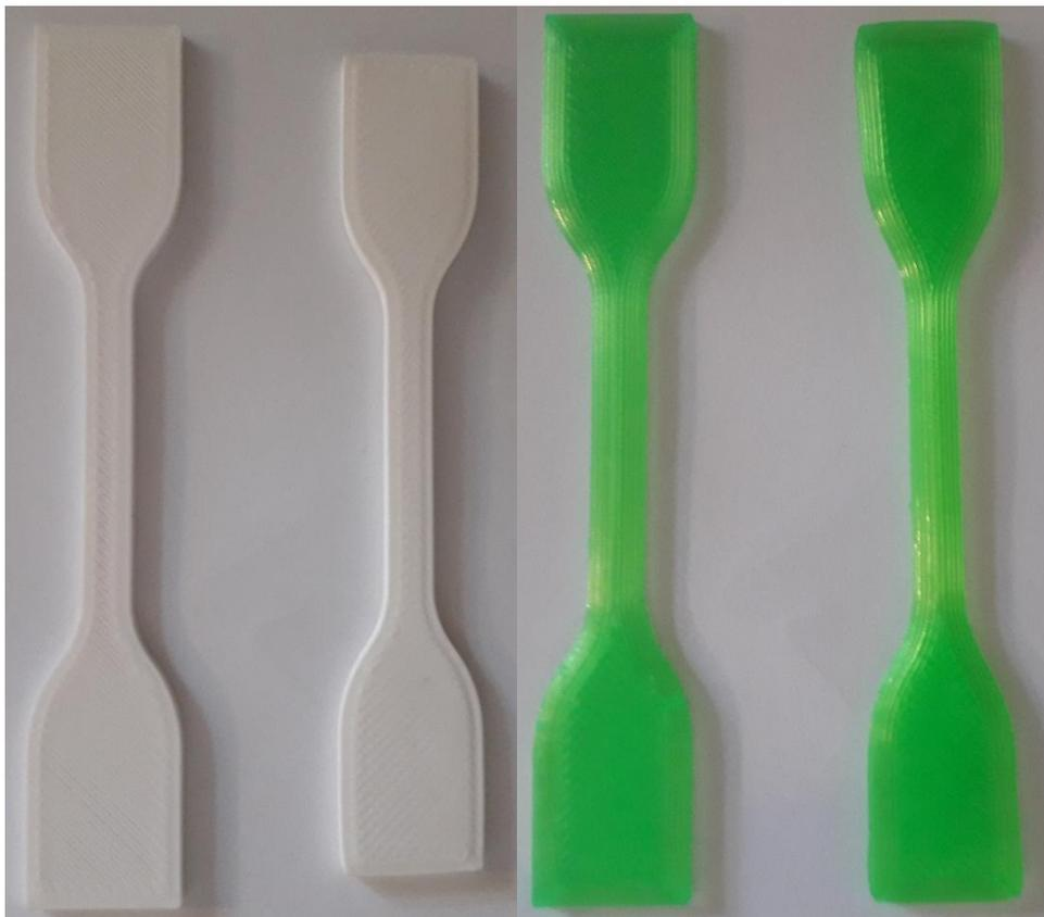
**Slika 5.14. Epruvete žarene na 100°C**
