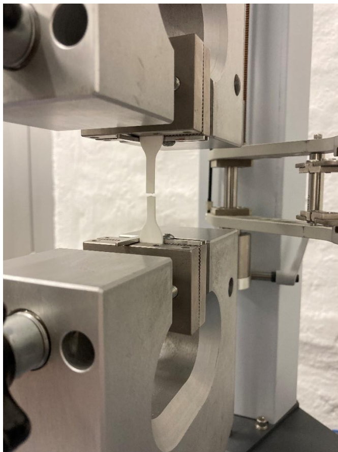
Slika 5.24. Lom referentne epruvete od PLA
