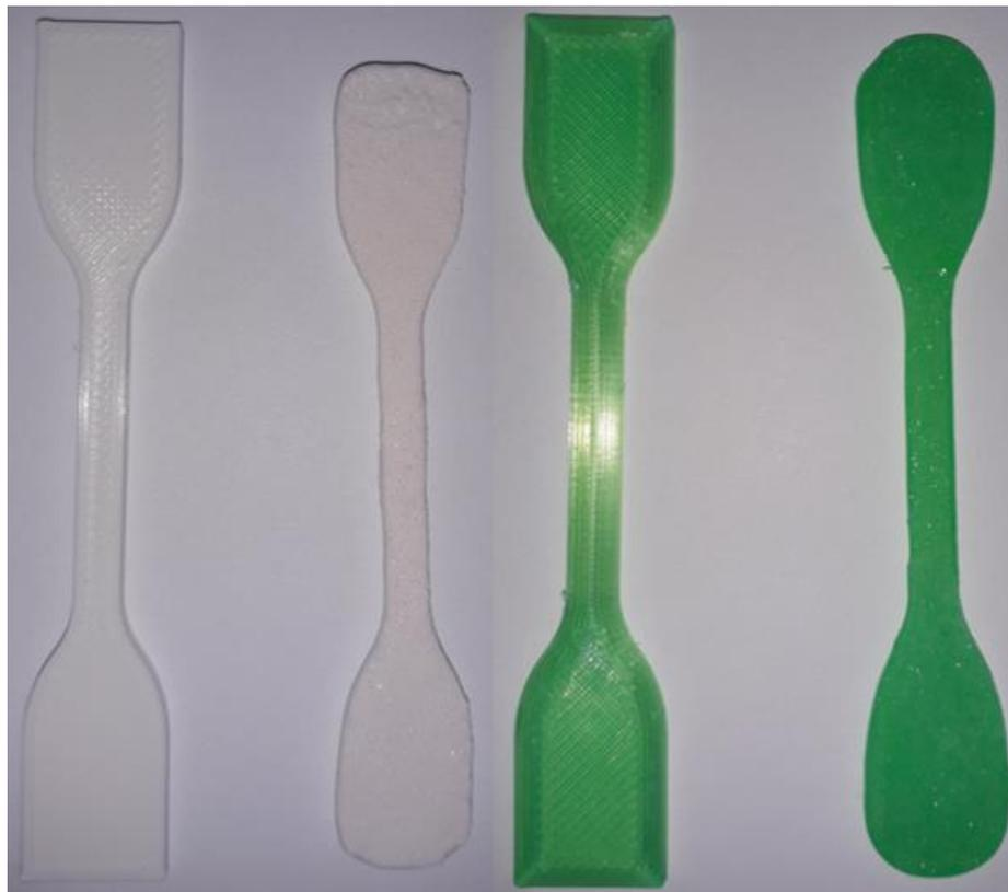
**Slika 5.21. Epruvete žarene na 160°C**
