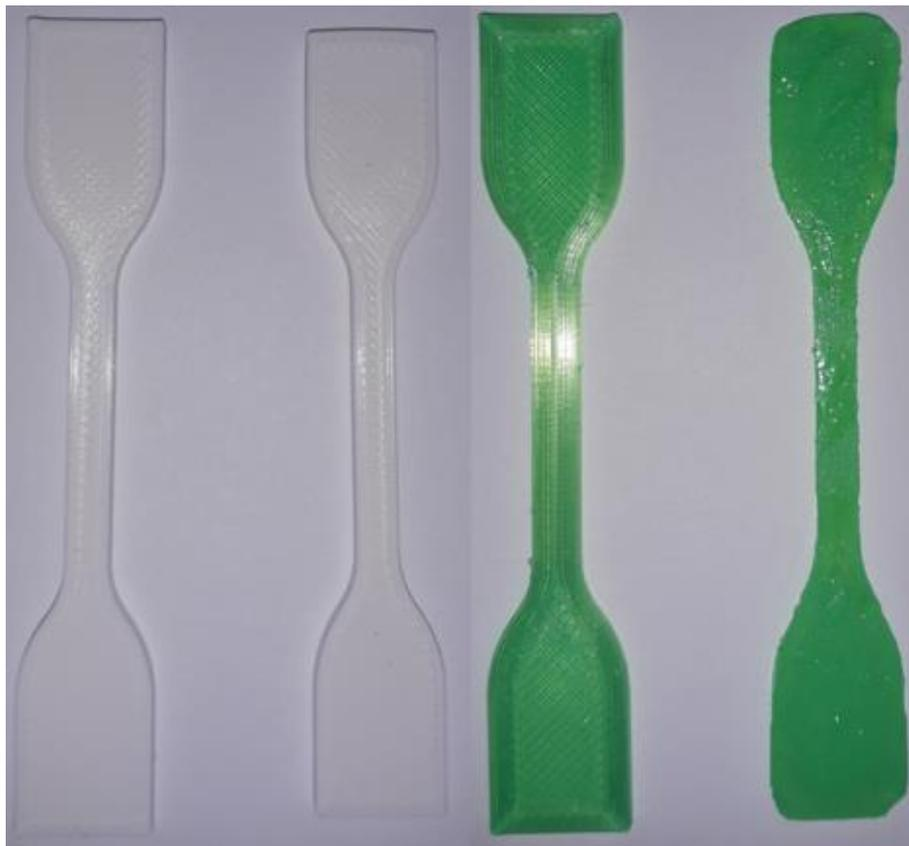
**Slika 5.19. Epruvete žarene na 140°C**
