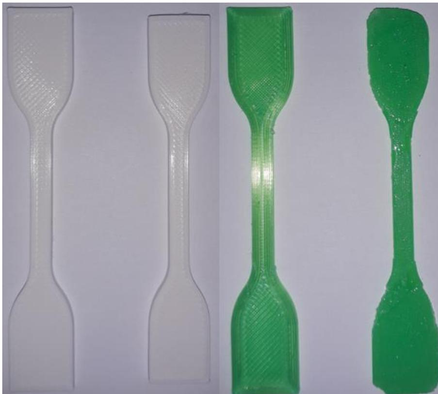
**Slika 5.20. Epruvete žarene na 150°C**
