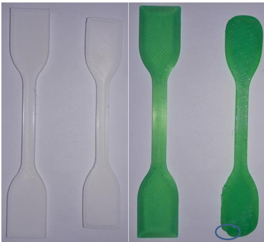
**Slika 5.17. Epruvete žarene na 120°C**
