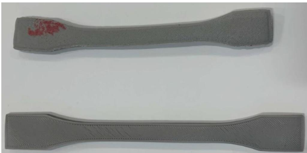
Slika 4.11. Deformacije ispitnog tijela od Al-ASA nakon žarenja [16]
