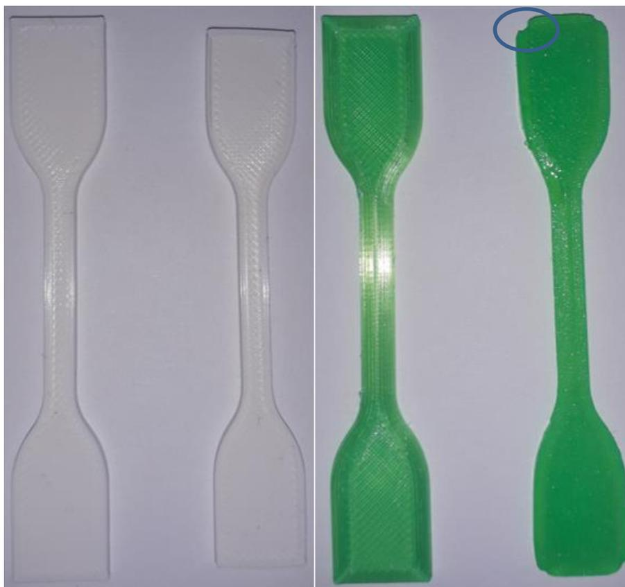
**Slika 5.18. Epruvete žarene na 130°C**
