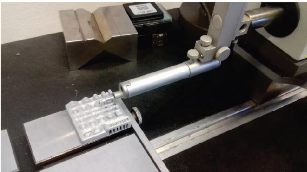
**Slika 3.12. Uređaj za mjerenje površinske hrapavosti [10]**
