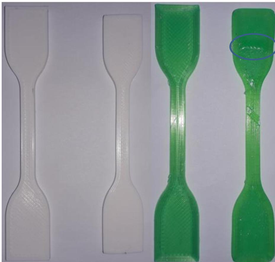
**Slika 5.16. Epruvete žarene na 110°C**
