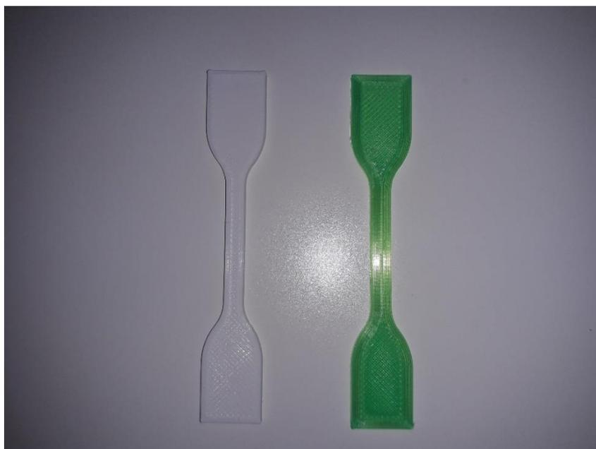
**Slika 5.2. Epruvete za ispitivanje rastezne čvrstoće**
