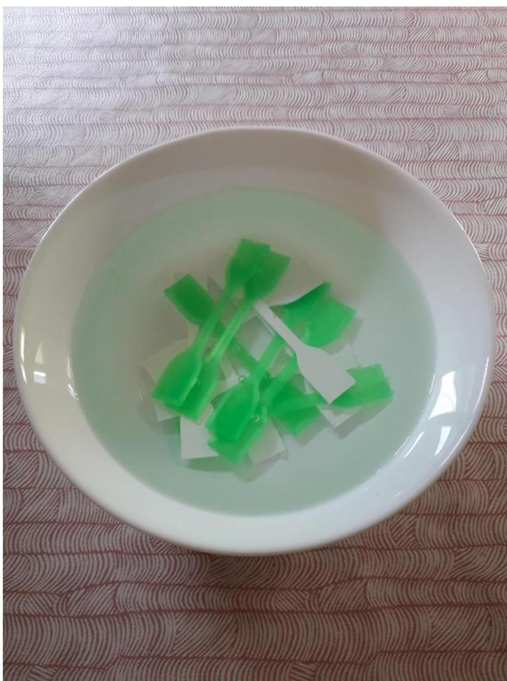
**Slika 5.13. Otapanje viška soli s površine epruveta**
