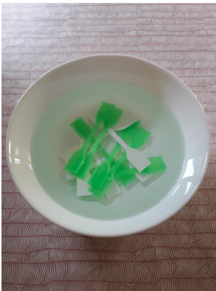
Slika 5.13. Otapanje viška soli s površine epruveta
