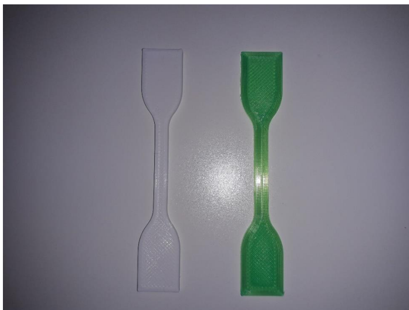
Slika 5.2. Epruvete za ispitivanje rastezne čvrstoće
