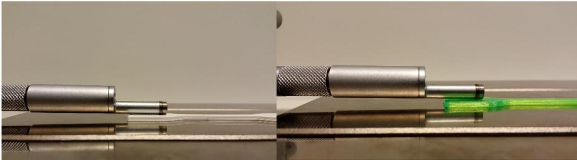
Slika 5.37. Mjerenje hrapavosti epruveta od PLA (lijevo) i PETG (desno)
