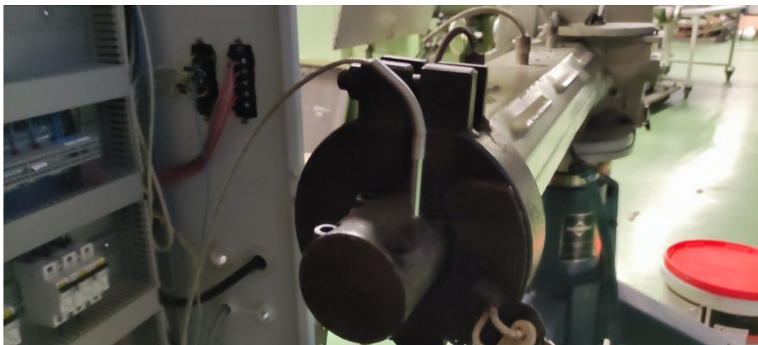
Slika 30. PT 100 sonda montirana u alat ekstrudera
