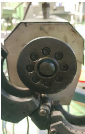
Slika 42. Dodatno stezanje alata
