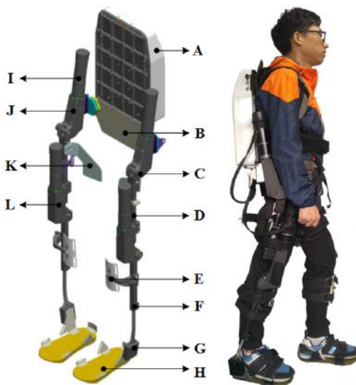
Slika 19. Egzoskelet SIAT. A: ruksak s kontrolerom i baterijom; B: dio struka; C: dekoderi; D: podesivi segment; E: pregrada koljenog zgloba; F: podesivi segment potkoljenice; G: zglob gležnja; H: nosive cipele; I: DC motor; J: zglob kuka; K: stražnja pregrada; L: zglob koljena [10]
