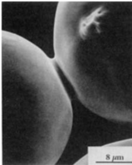
Slika 11. Stvaranje "vrata" na mjestu kontakta između čestica [4].
