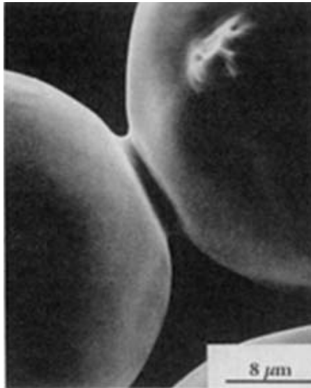
Slika 11. Stvaranje "vrata" na mjestu kontakta između čestica [4].
