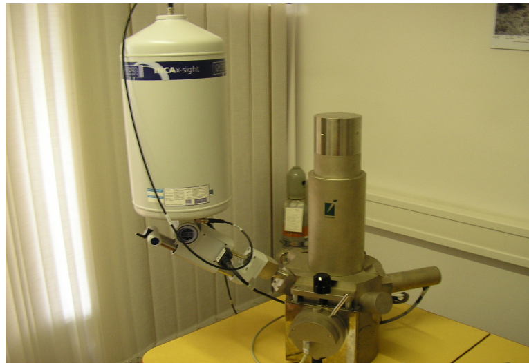
Slika 26. Pretražni elektronski mikroskop Tescan Vega TS5136LS.
