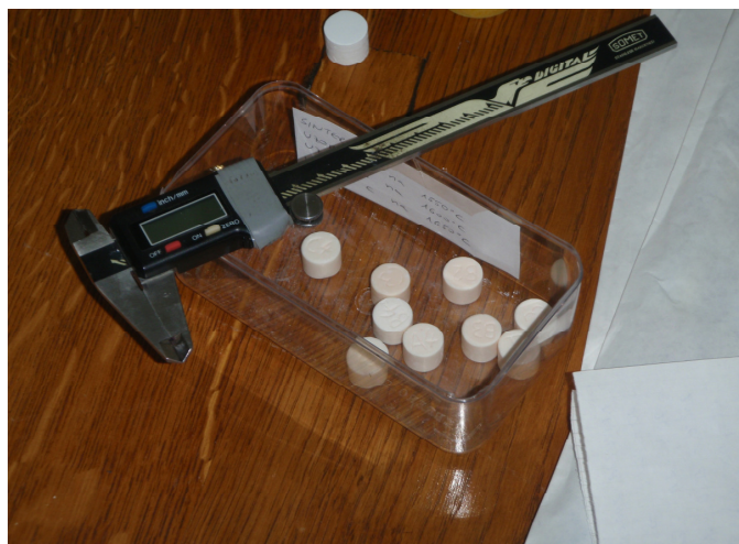
Slika 20. Pomična mjerka korištena za određivanje dimenzija uzoraka.
