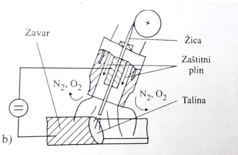
**Slika 6. Shematski prikaz MIG MAG postupka [6]**
