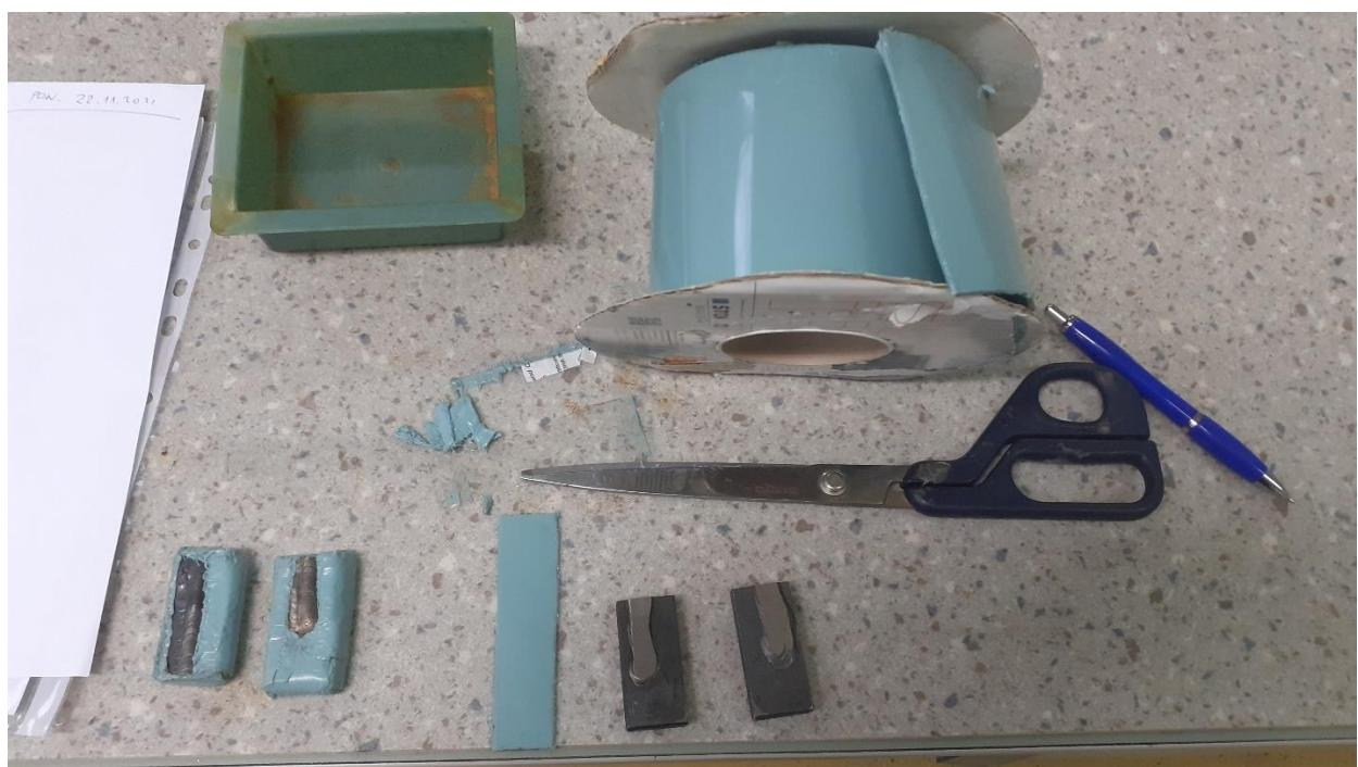
**Slika 34. Postupak izolacije osnovnog materijala [23]**
