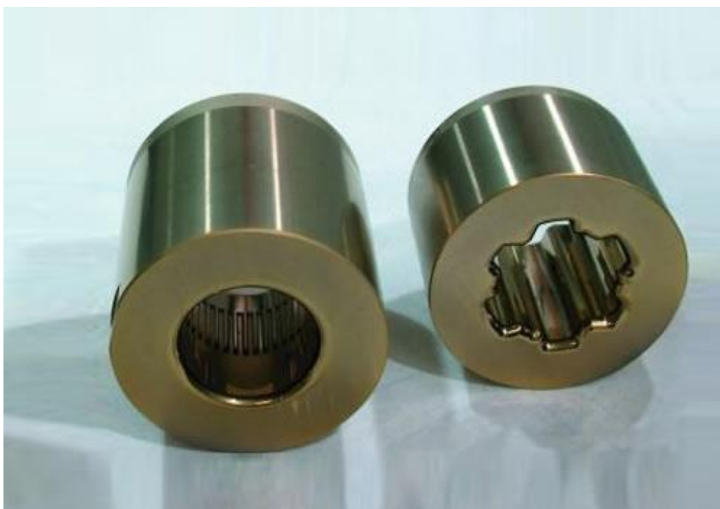
Slika 3. Strojni dijelovi prevučeni PACVD postupkom [5]
