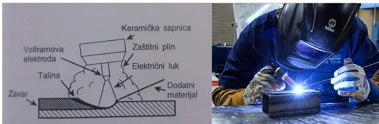
Slika 15. Shematski prikaz TIG postupka lijevo i TIG zavarivanje u provedbi [2],
