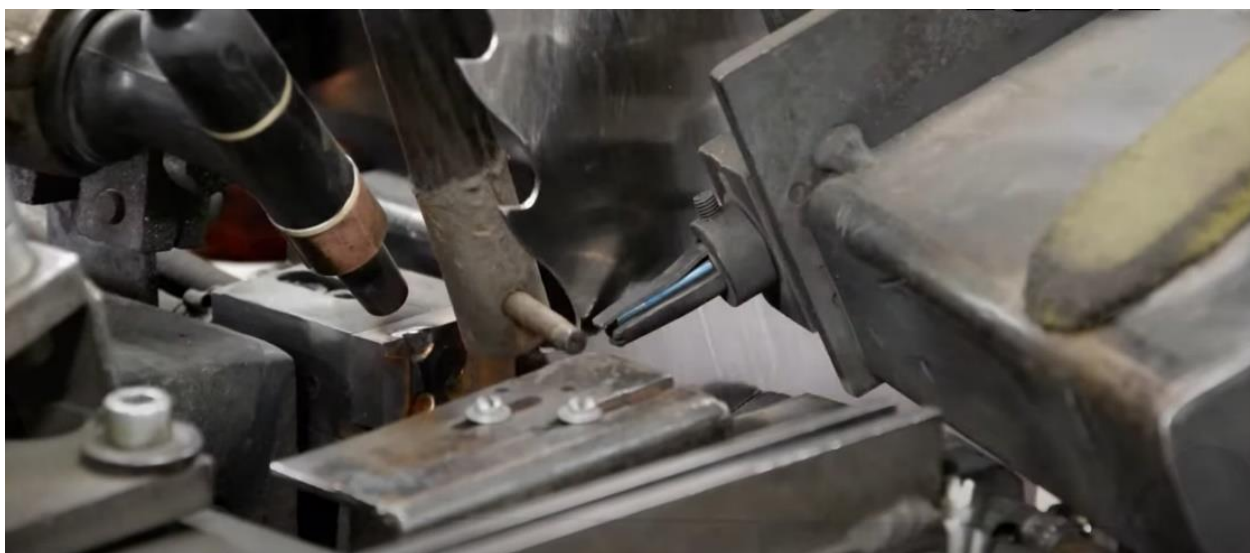
Slika 24. Automatsko stelitiranje tračnih pila [12]
