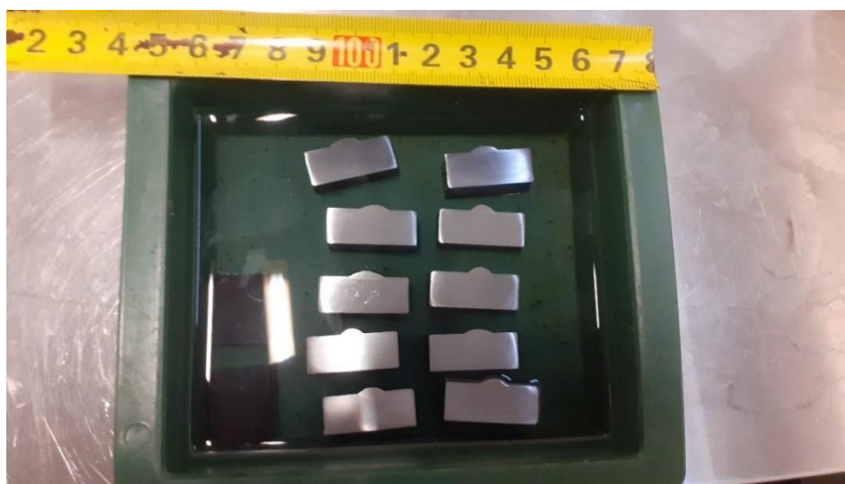
Slika 33. Čišćenje uzoraka u medicinskom alkoholu
