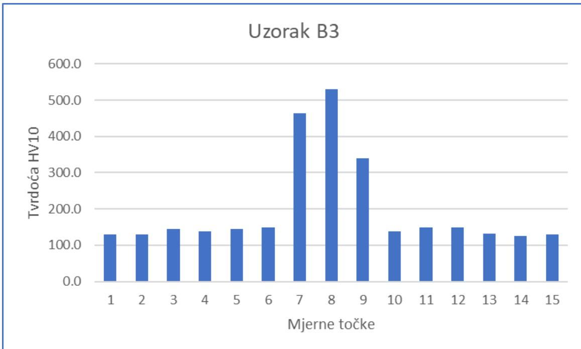
**Slika 52.** Grafički prikaz kretanja tvrdoće uzorka B3**Tablica 22.** Vrijednost tvrdoće uzorka B4
