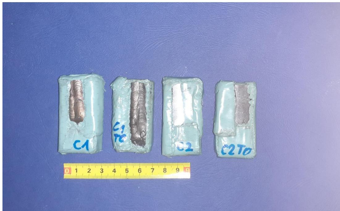
Slika 35. Izolirani uzorci stelita
