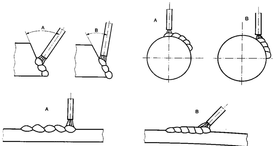
**Slika 19. Primjeri ispravne B i pogrešne A tehnike rada kod navarivanja [6]**
