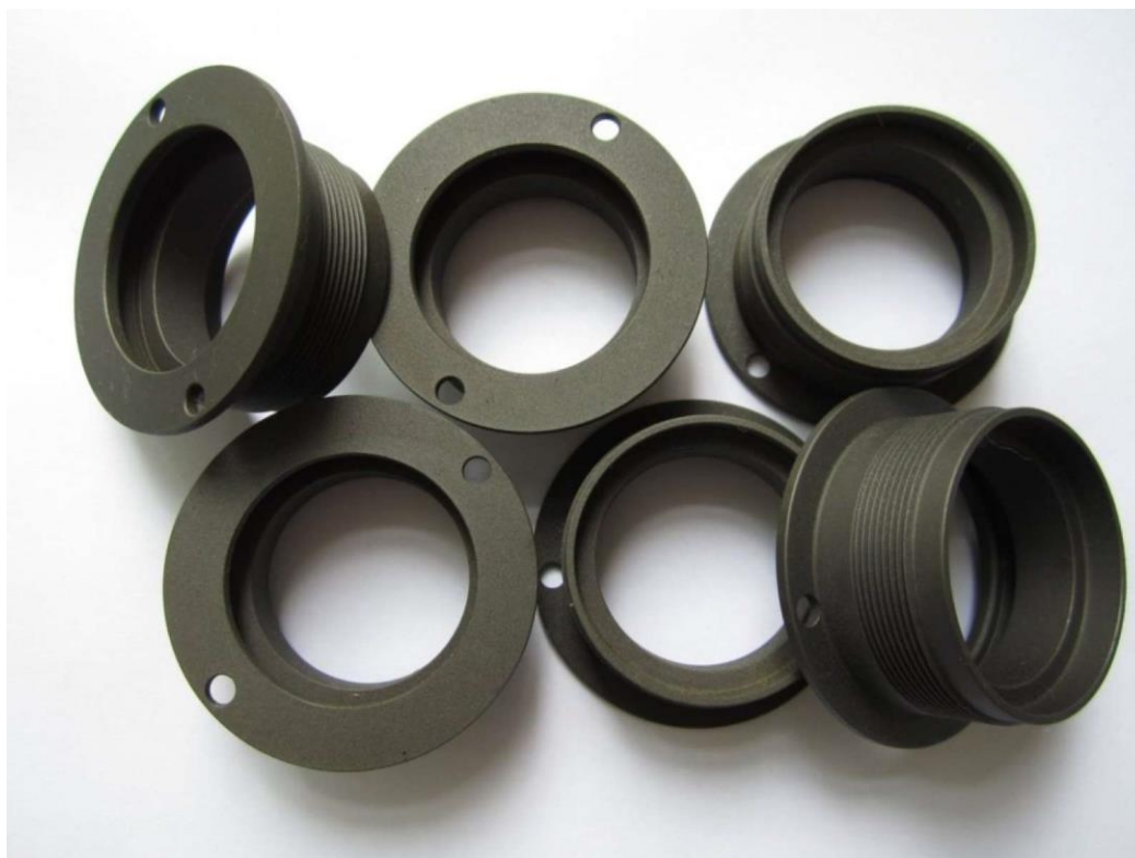
Slika 2. Prirubnice nakon postupka fosfatiranja [3]
