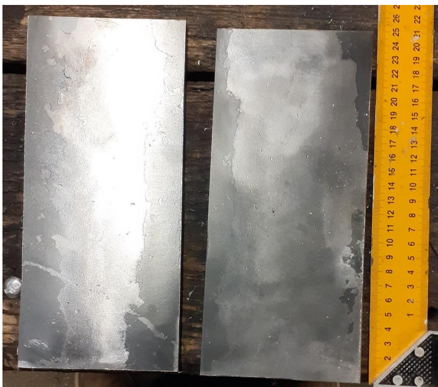
Slika 26. Ploče dodatnog materijala prije rezanja
