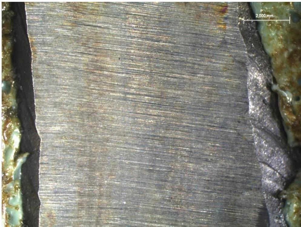
**Slika 42. C2TO uzorak nakon korozije**
