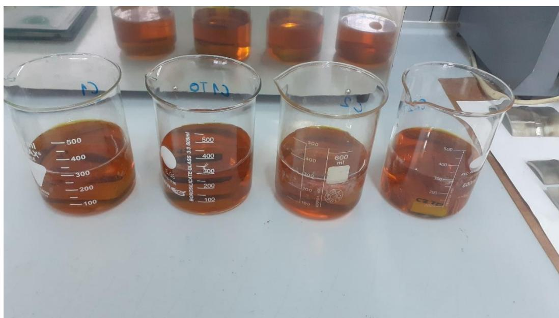
Slika 36. Korozijsko ispitivanje na rupičastu koroziju
