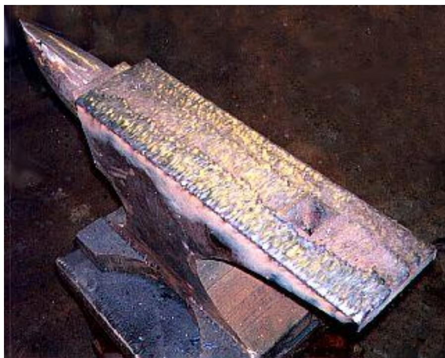
Slika 10. Navarivanje nakovnja tvrdim metalom [10]
