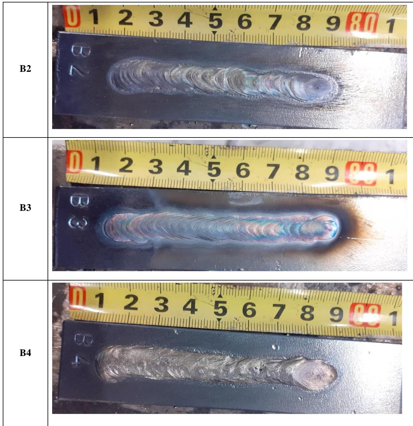
Iz tablice 11, vidljiva su lica navarenih slojeva. Uzorci A1, A3 te B1 i B3 na kojima je korištena istosmjerna struja, imaju bolju estetiku navara, dok se na uzorcima gdje je korištena izmjenična struja (AC) vidi gruba površina lica zavara. Prema riječima zavarivača, na uzorcima koji su navarivani u zaštiti plinske mješavine 5% H i 95% Ar, električni luk ponašao se mirnije.
