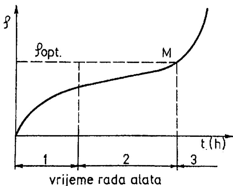
Slika 23. Krivulja trošenja oštice [11]
