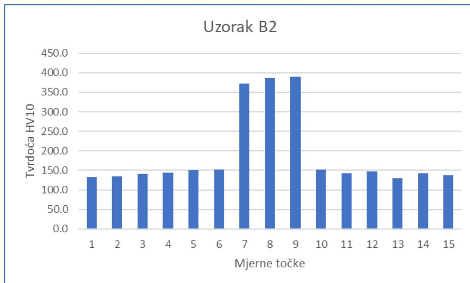
**Slika 51. Grafički prikaz kretanja tvrdoće uzorka B2****Tablica 21. Vrijednost tvrdoće uzorka B3**
