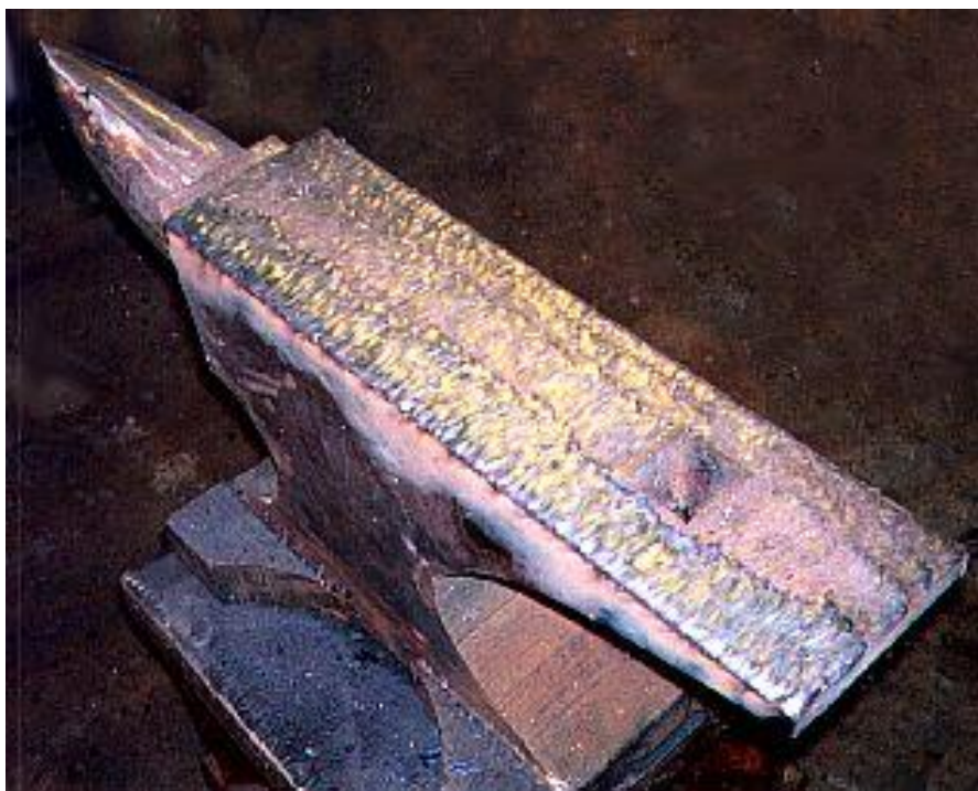
Slika 10. Navarivanje nakovnja tvrdim metalom [10]
