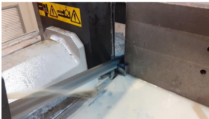
Slika 32. Rezanje uzoraka na tračnoj pili
