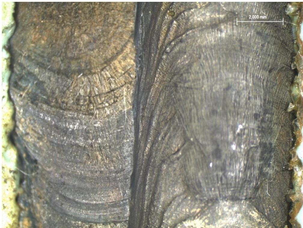
**Slika 40. C1TO uzorak nakon korozije**
