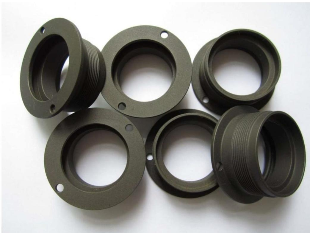
**Slika 2. Prirubnice nakon postupka fosfatiranja [3]**
