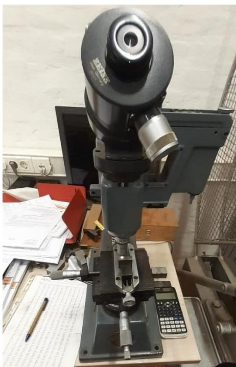
**Slika 44. Uređaj za mjerjenje tvrdoće po Vickersu**
