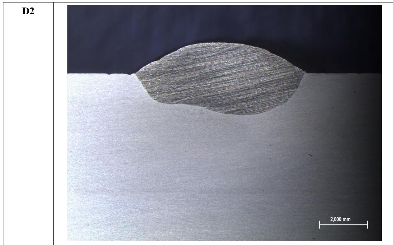
Na uzorcima koji nisu prethodno predgrijani (A1 , A2 , A3 , A4 i D1), jasno je vidljiva makrostruktura ZUTa, dok se linija staljivanja između metala zavara i ZUT-a jasno vidi na svim makroizbruscima. Unos topline uzrokovao je slabiju uočljivost zone utjecaja topline kod uzoraka B1, B2, B3, B4.
