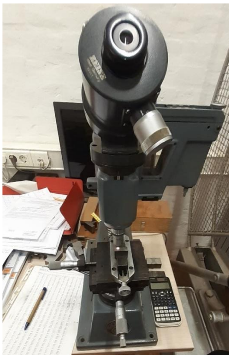
Slika 44. Uređaj za mjerenje tvrdoće po Vickersu
