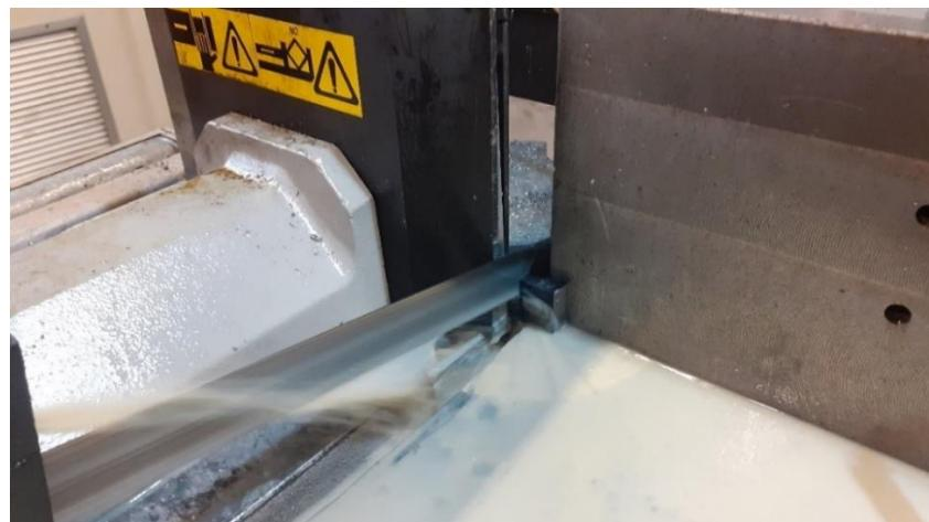
Slika 32. Rezanje uzorka na tračnoj pili
