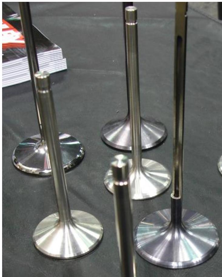
**Slika 13. Ventili motora nakon navarivanja stelitom i brušenja [13]**
