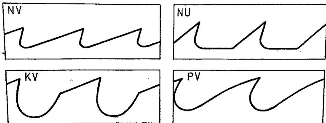
**Slika 22. Osnovni oblici nazubljenja tračnih pila [11]**
