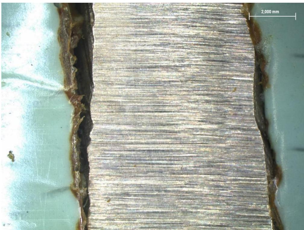
**Slika 41. C2 uzorak nakon korozije**
