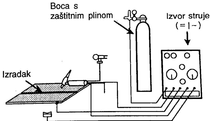
**Slika 16. Standardna oprema za TIG postupak [6]**
