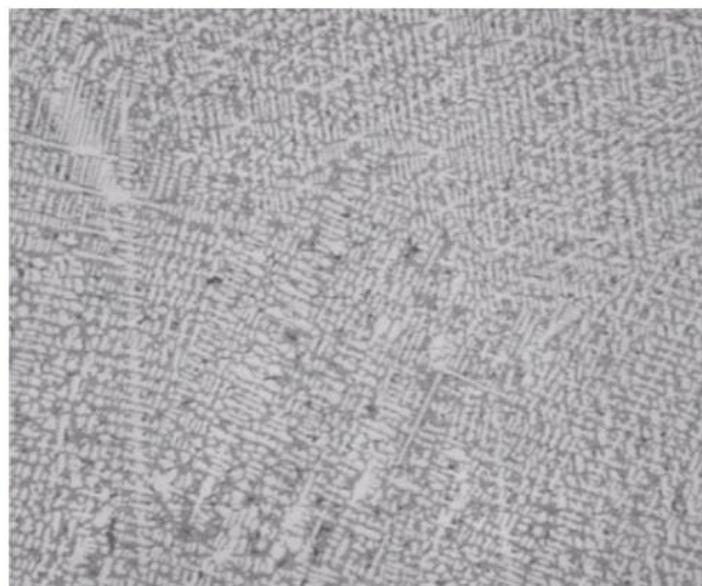
**Slika 14. Mikrostruktura stelita 12 s povećanjem 500x [14]**
