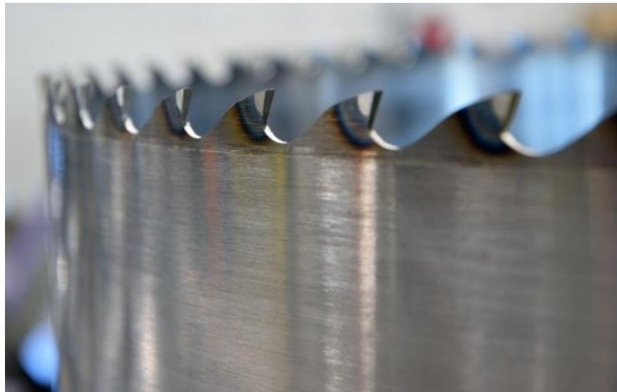
**Slika 12. Stelitirana tračna pila za drvo [12]**
