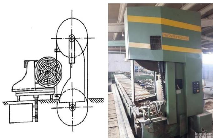
Slika 21. Tračna pila trupčara – pilana [11]
