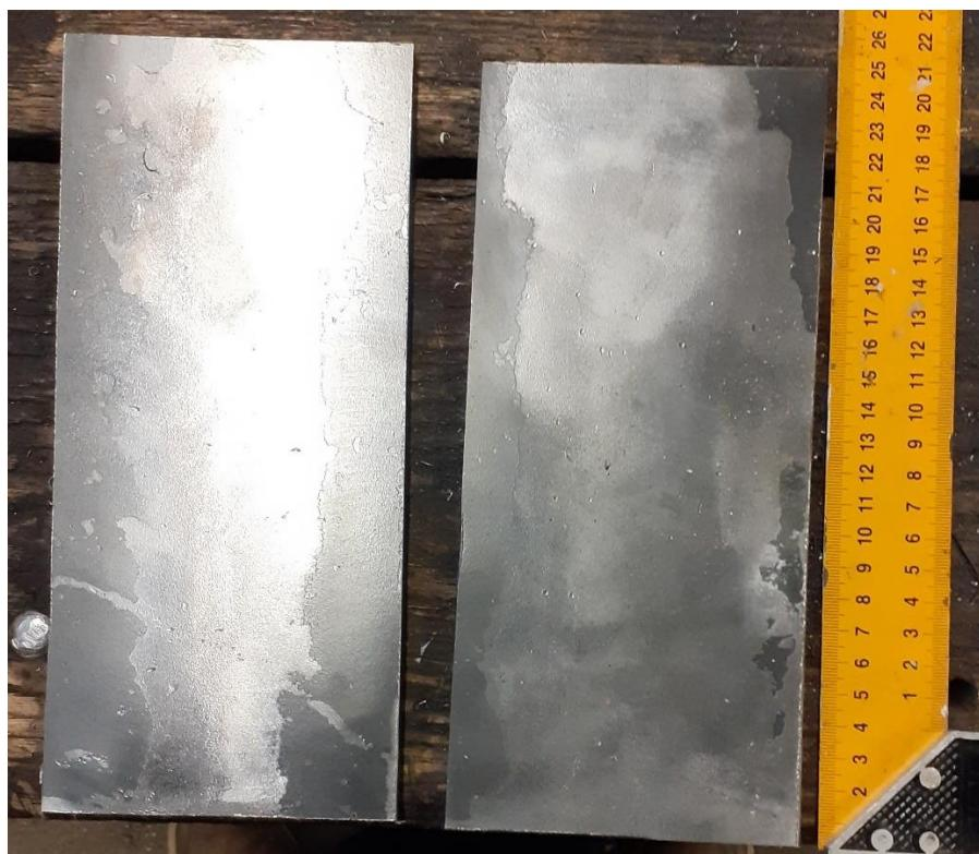
**Slika 26. Ploče dodatnog materijala prije rezanja**
