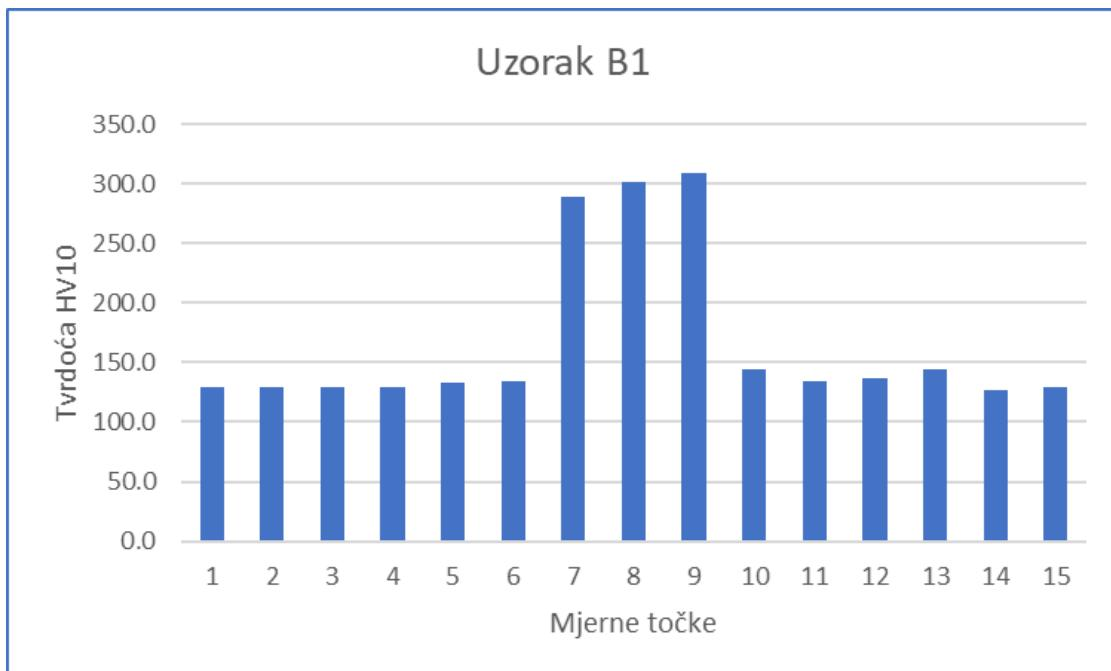
**Slika 50.** Grafički prikaz kretanja tvrdoće za uzorak B1**Tablica 20.** Vrijednost tvrdoće uzorka B2
