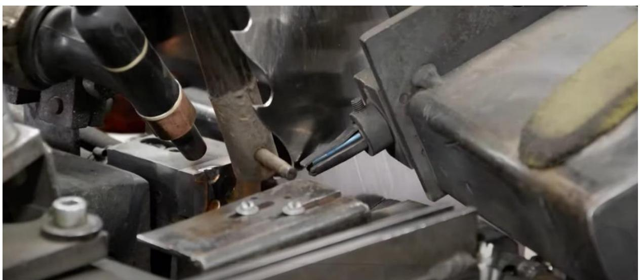
Slika 24. Automatsko stelitiranje tračnih pila [12]
