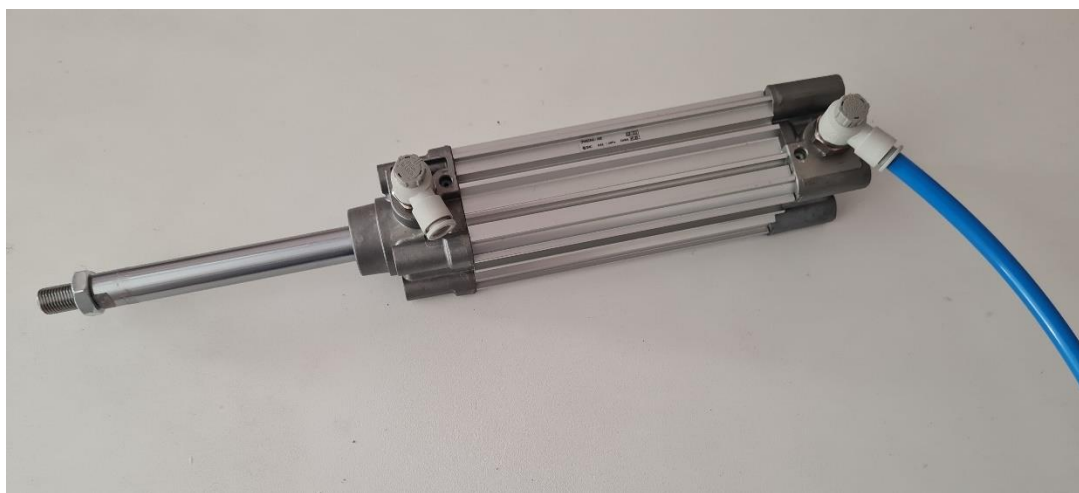
Slika 40. Test cilindra – izlaz klipnjače
