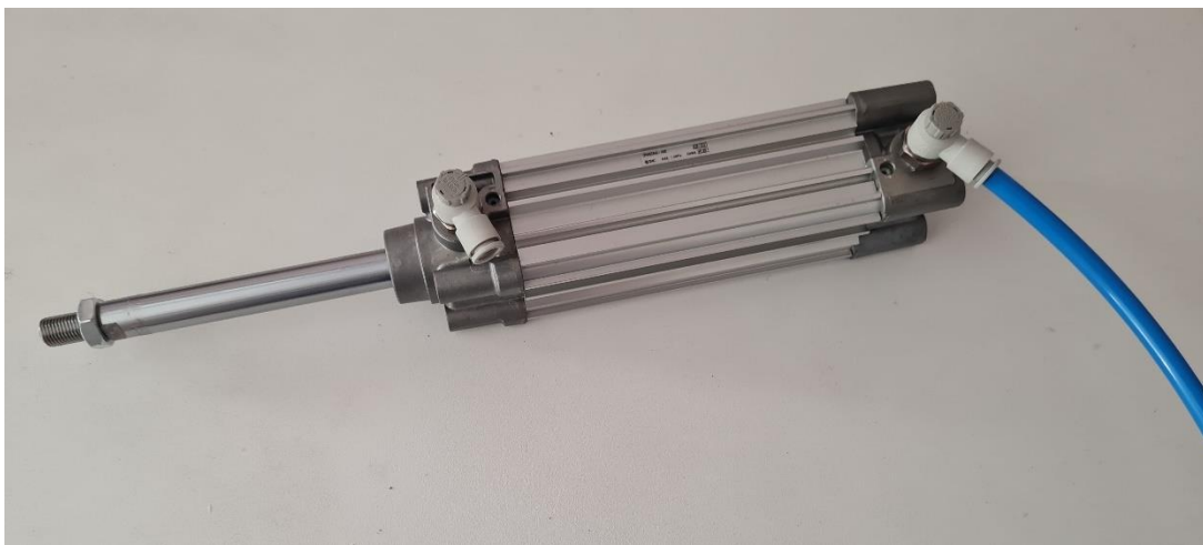
Slika 40. Test cilindra – izlaz klipnjače
