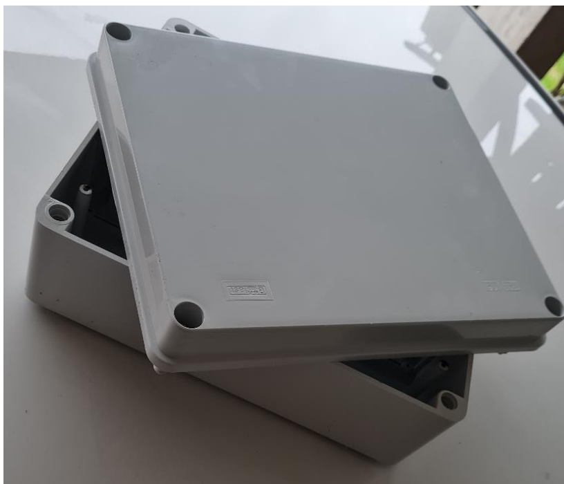
Slika 35. Kutija za smještaj upravljačkog sustava i elektronike
