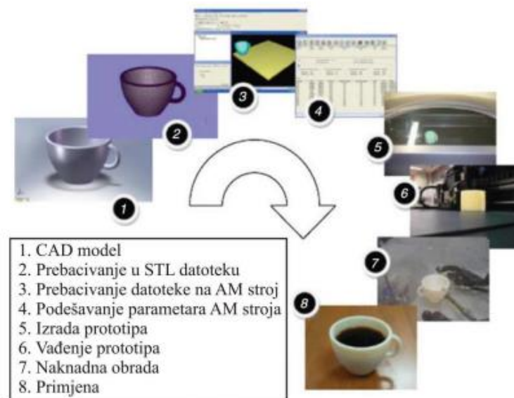
Slika 14. Faze aditivne proizvodnje [17]
