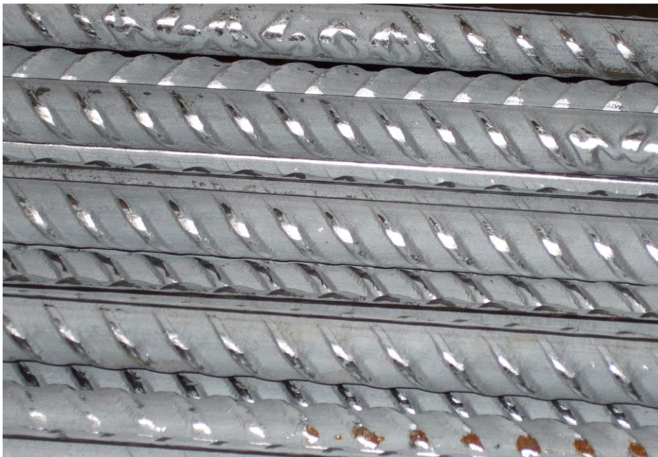
Slika 11. Armatura proizvedena od dupleks čelika [6]
