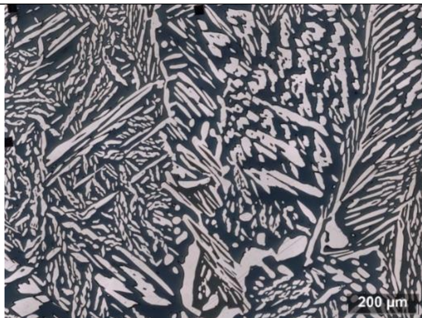
Slika 2. Mikrostruktura dupleks čelika, tamno obojan ferit, a svijetlo obojan austenit [8]
