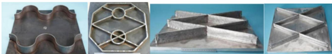
Slika 17. Proizvodi proizvedeni WAAM postupkom [20]
