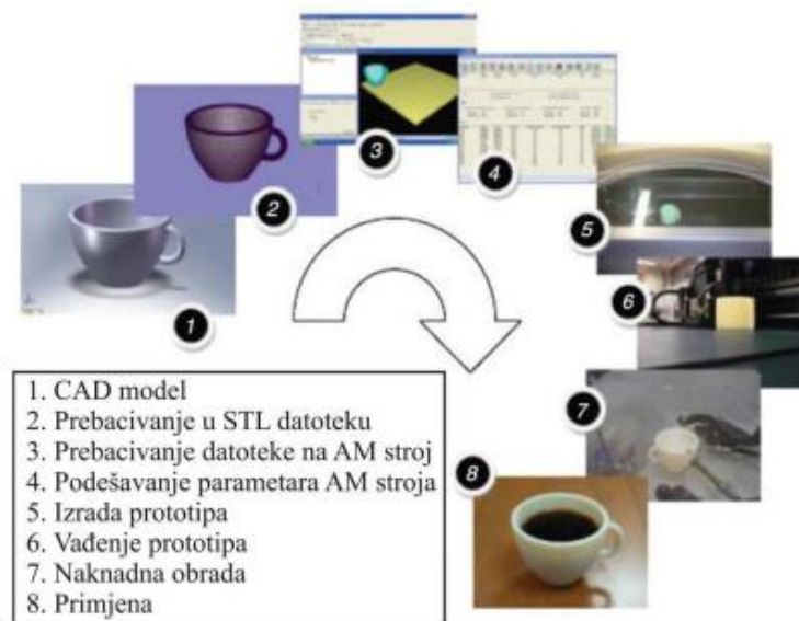
Slika 14. Faze aditivne proizvodnje [17]
