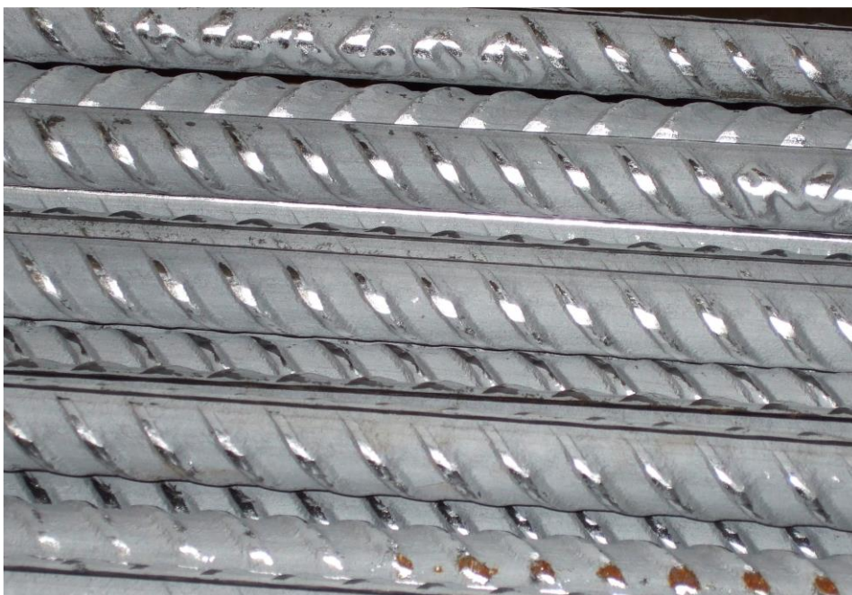
Slika 11. Armatura proizvedena od dupleks čelika [6]
