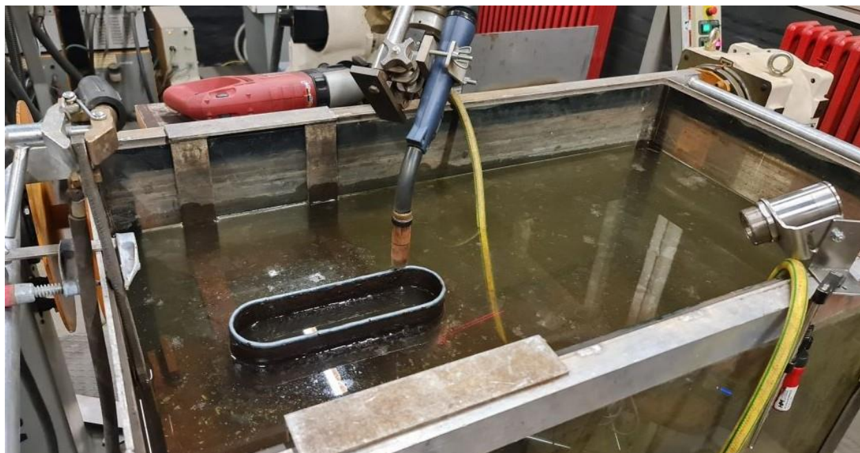
Slika 36. Predforma nakon završetka taloženja
