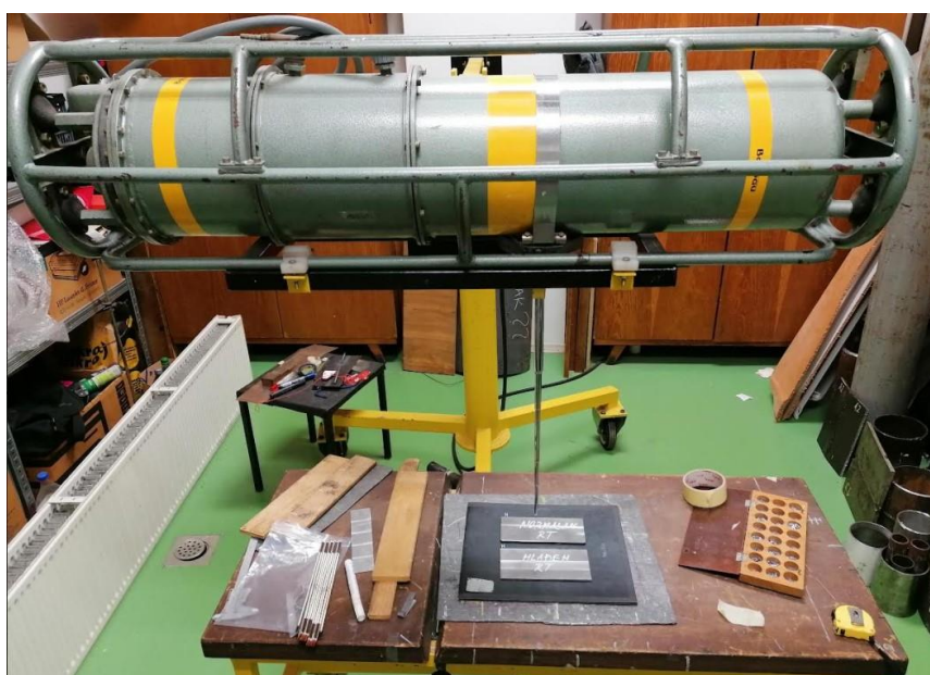
Slika 47. Oprema za rendgensko snimanje
