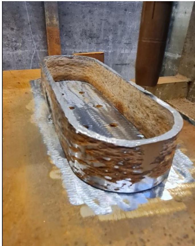
Slika 30. Poligon (podloga) za taloženje predforme
