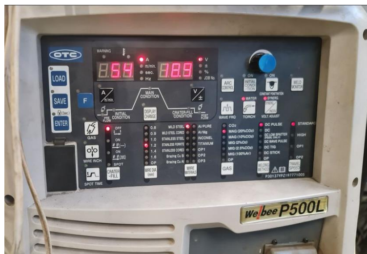
Slika 29. Parametri struje i napona pred kraj taloženja
