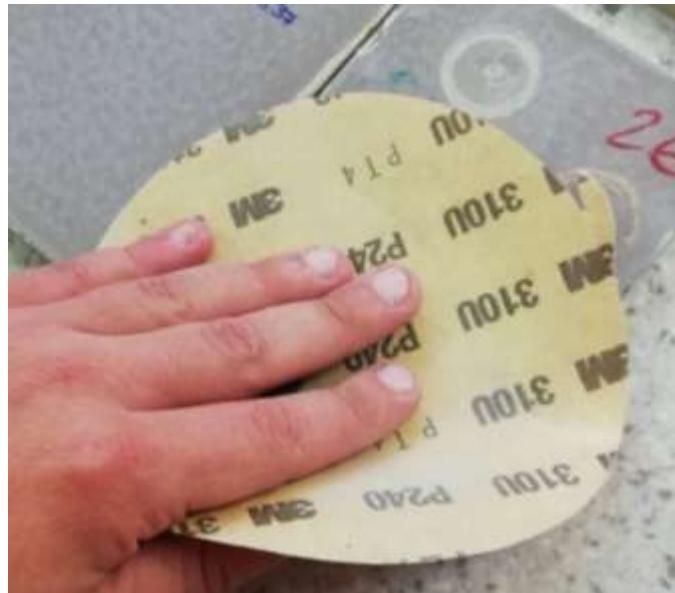
**Slika 25. Brušenje ispitnih uzoraka prije nanosa prvog sloja ekspandirajućeg premaza**
