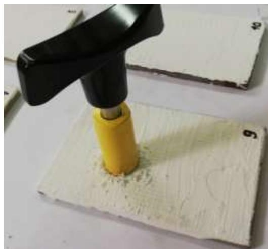
Slika 37. Strugač za pripremu uzorka prije ispitivanje prionjivosti
