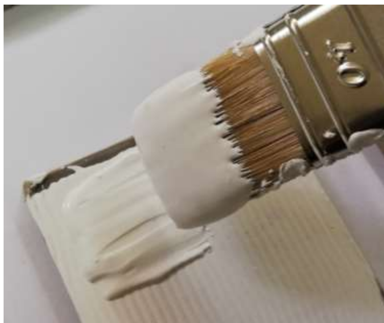
Slika 28. Tehnika nanošenja premaza kistom
