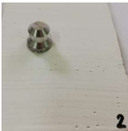
Slika 36. Ispitivanje prionjivosti na ispitnim uzorcima
