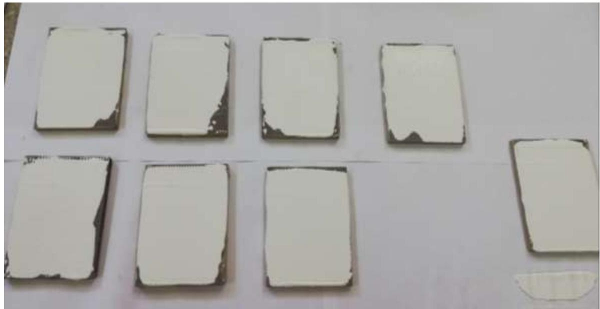
**Slika 27. Uzorci s nanesenim prvim slojem ekspandirajućeg premaza**
