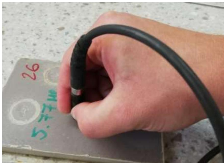
Slika 23. Prikaz tehnike mjerjenja debljine premaza
