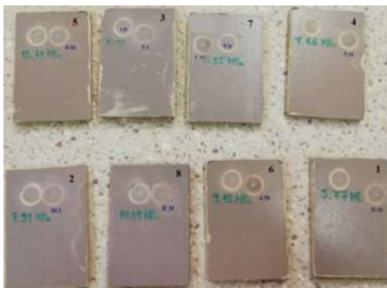
Slika 21. Uzorci s nanesenim epoksi temeljnim premazom i izmjerene početne vrijednosti prionjivosti
