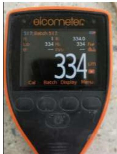
Slika 22. Uredaj za mjerjenje debljine premaza „Elcometer 456“
