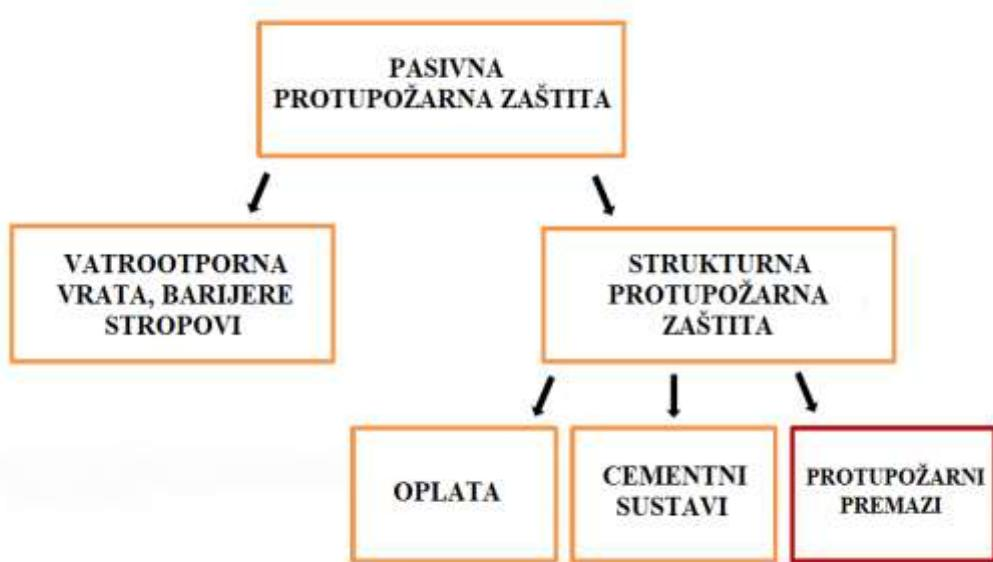
Slika 7. Shematski prikaz pasivne protupožarne zaštite [18]
