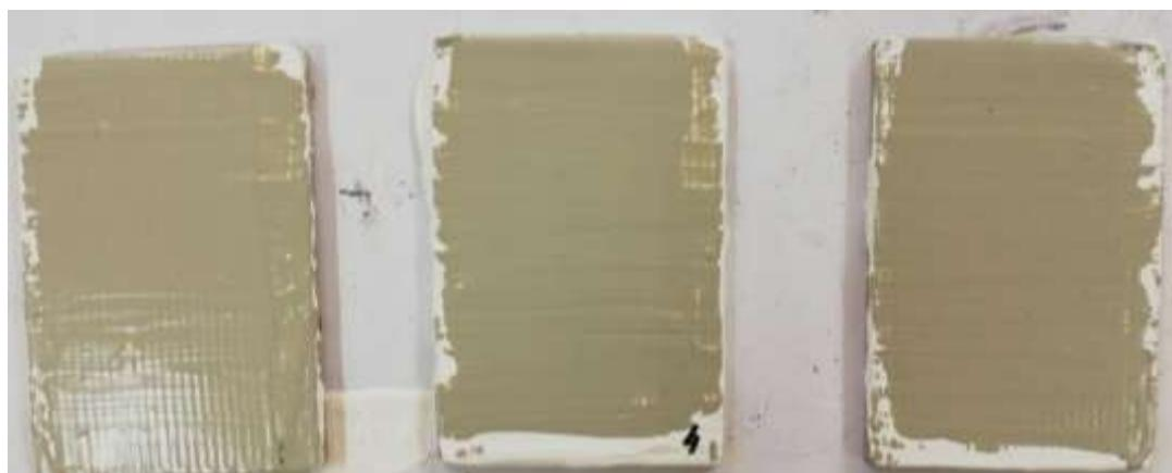
Slika 31. Uzorci premazani poliuretanskim premazom
