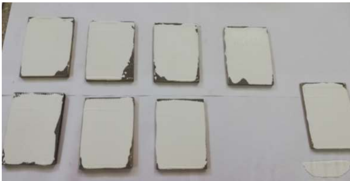
Slika 27. Uzorci s nanesenim prvim slojem ekspandirajućeg premaza
