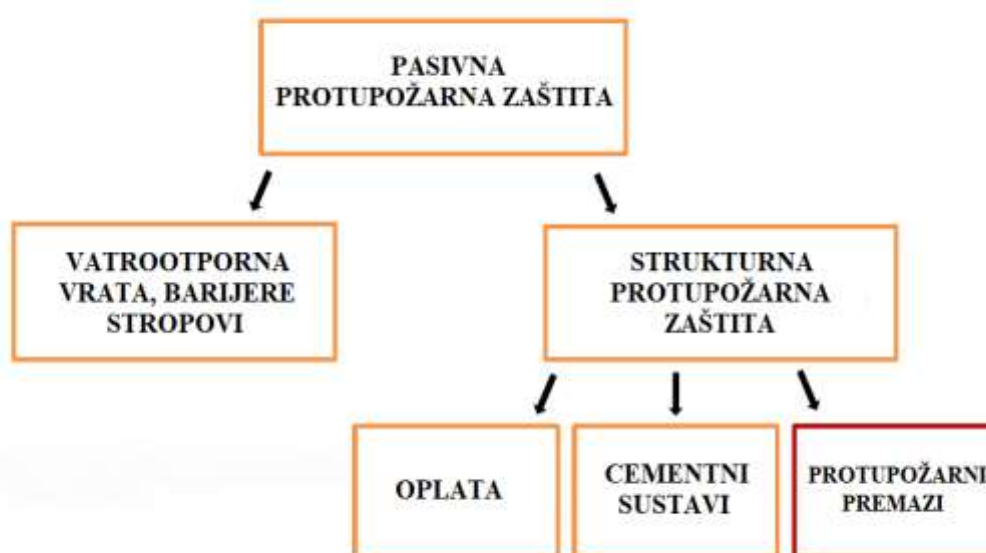
Slika 7. Shematski prikaz pasivne protupožarne zaštite [18]
