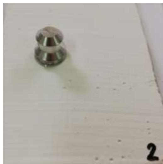
Slika 36. Ispitivanje prionjivosti na ispitnim uzrocima
