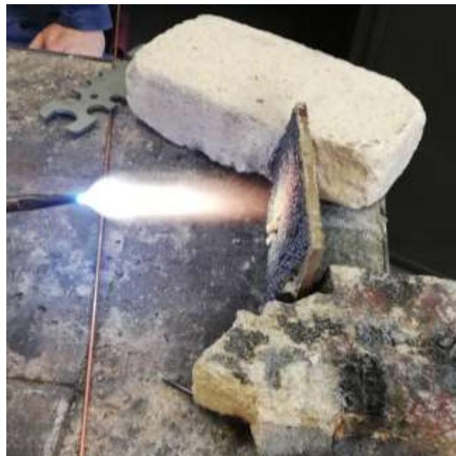
Slika 42. Provodenje eksperimenta paljenja uzorka
