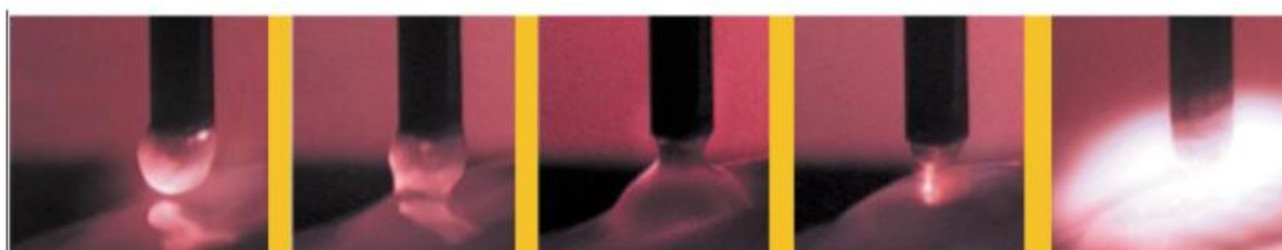
Slika 27. Dinamička karakteristika STT postupka [17]
