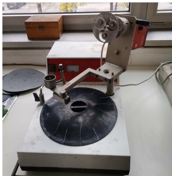
Slika 50. Uređaj za poliranje uzoraka
