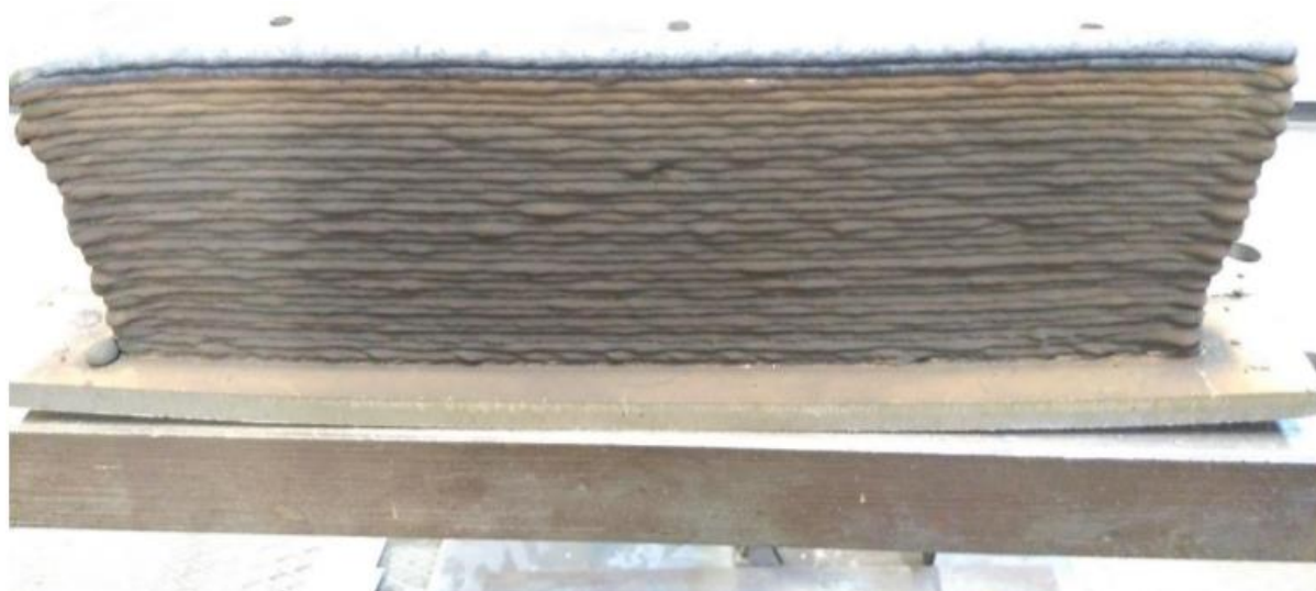
Slika 39. Zid izrađen postupkom coldArc [25]
