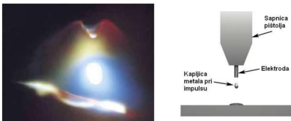
Slika 23. Prijenos metala impulsnim strujama [13]
