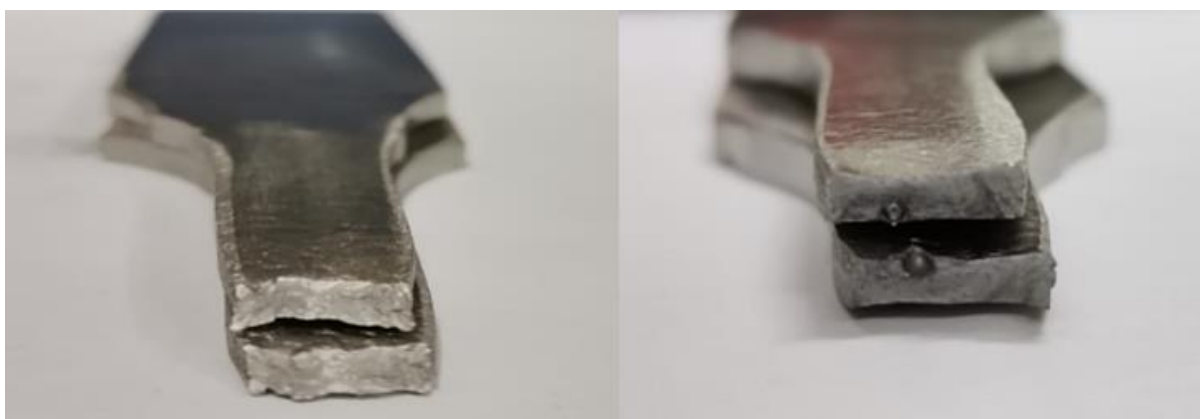
Slika 77. Poprečni presjek epruvete H (lijevo) i HT (desno) nakon kidanja
