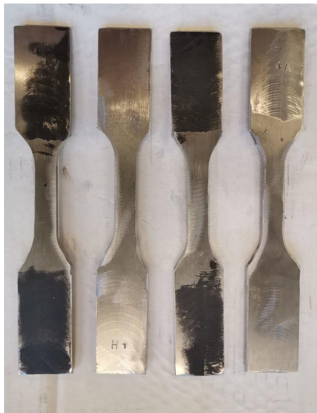
Slika 71. Izrađene epruvete pravokutnog poprečnog presjeka
