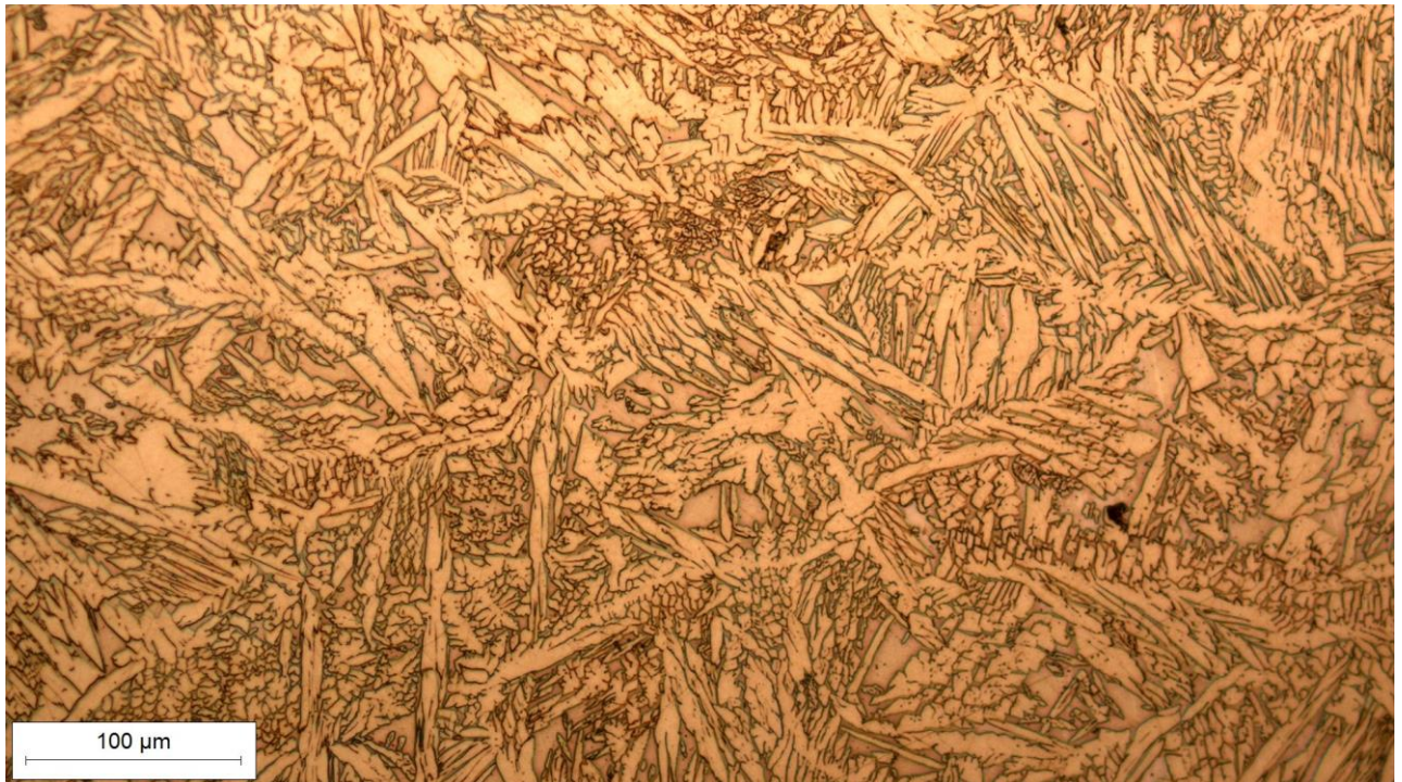
Slika 53. Mikrostruktura uzorka u pogledu T
