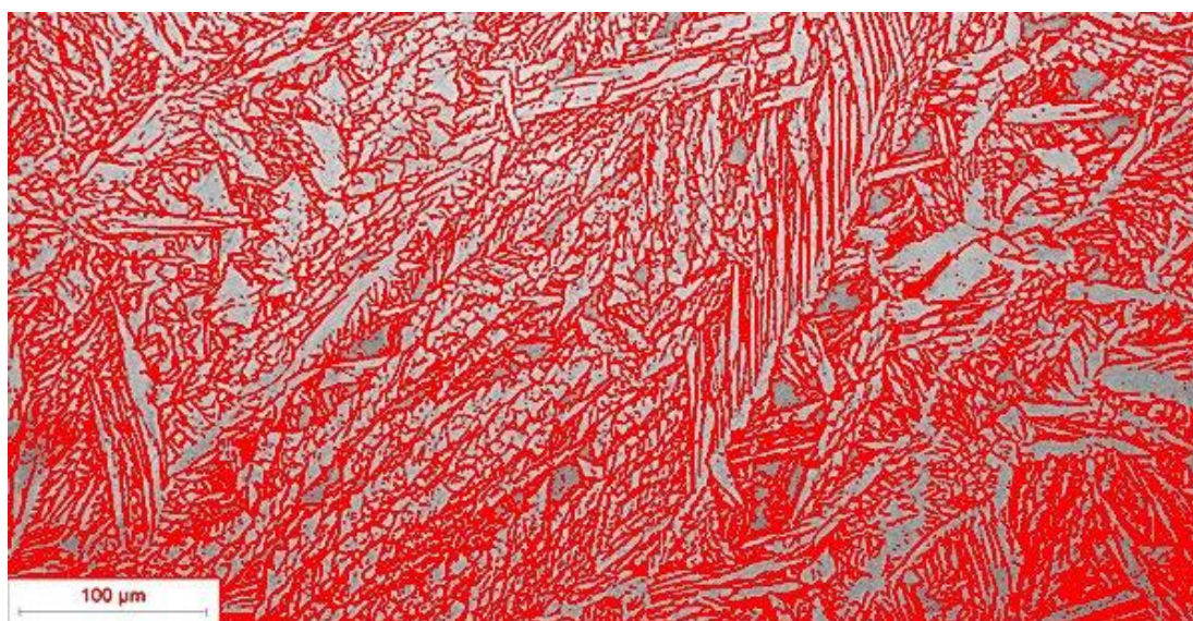
Slika 82. Određivanje postotnog udjela ferita i austenita pomoću programa ImageJ
