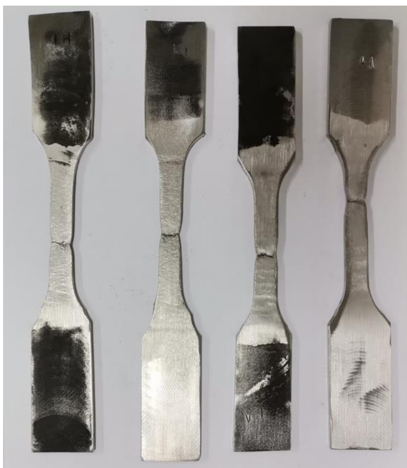
Slika 75. Epruvete nakon statičko vlačnog pokusa
