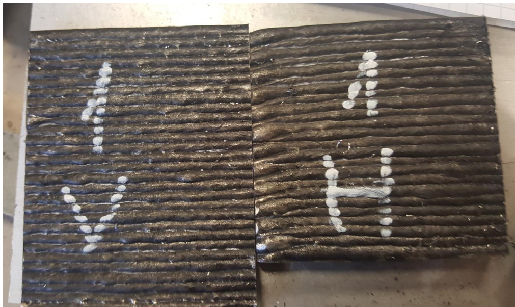
Slika 65. Izrezani uzorci za statičko vlačno ispitivanje
