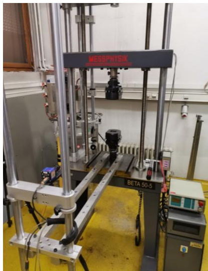
Slika 72. Kidalica MESSPHYSIK BETA 50-5
