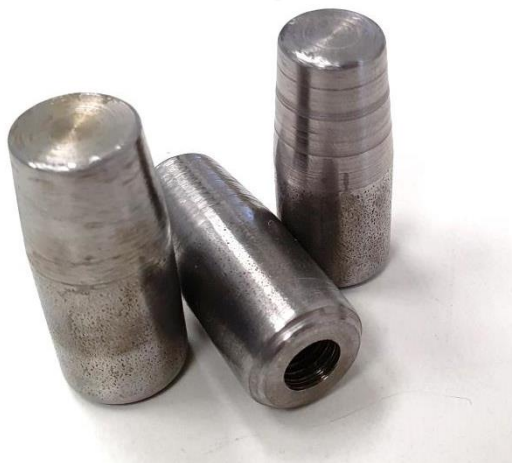
Slika 7.20. Izrađeni trnovi za centriranje
