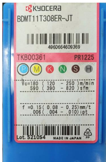
Slika 7.17. Režimi alata na poledini pakovanja alata
