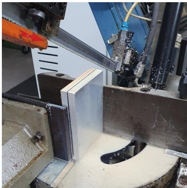
Slika 7.18. Piljenje sirovca pilom u svrhu uštede materijala
