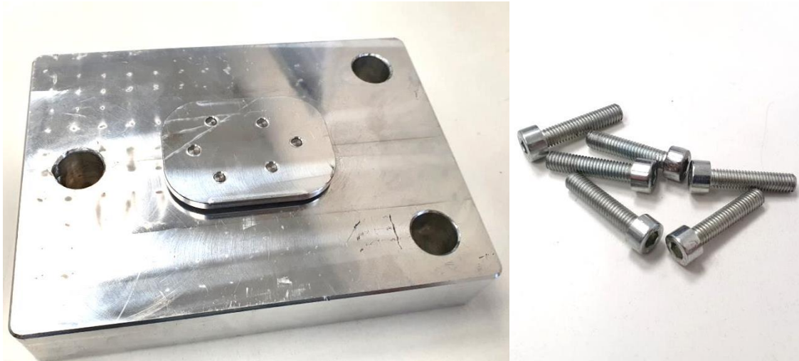
Slika 7.25. Sklapanje gornje ploče kalupa s jezgrom
