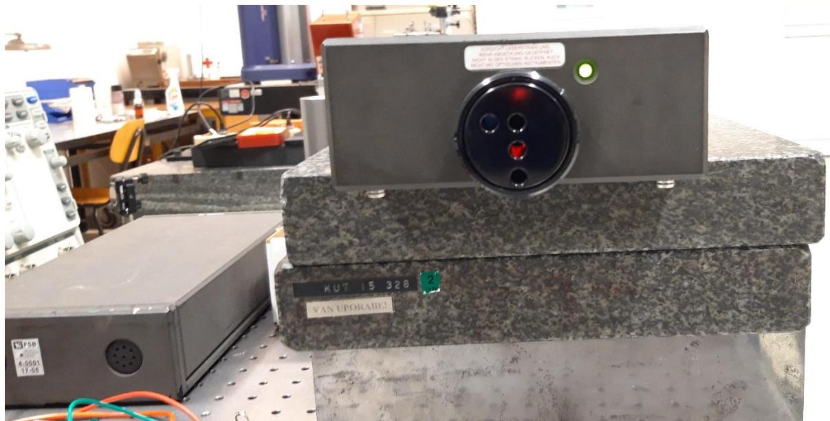
Slika 23. Laser spreman za namještanje sustava
