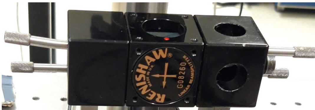
Slika 14. Sustav za potpunu interferenciju zrake svjetlosti
