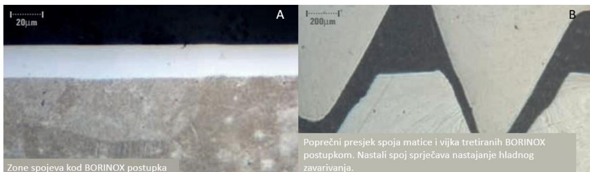
**Slika 15. Mikrostruktura dobivena BORINOX postupkom [16]**
