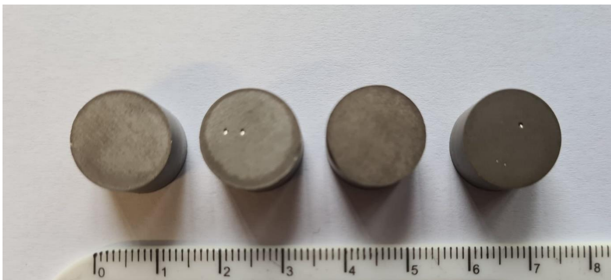
Slika 21. Uzorci nakon boriranja i dubokog boriranja
