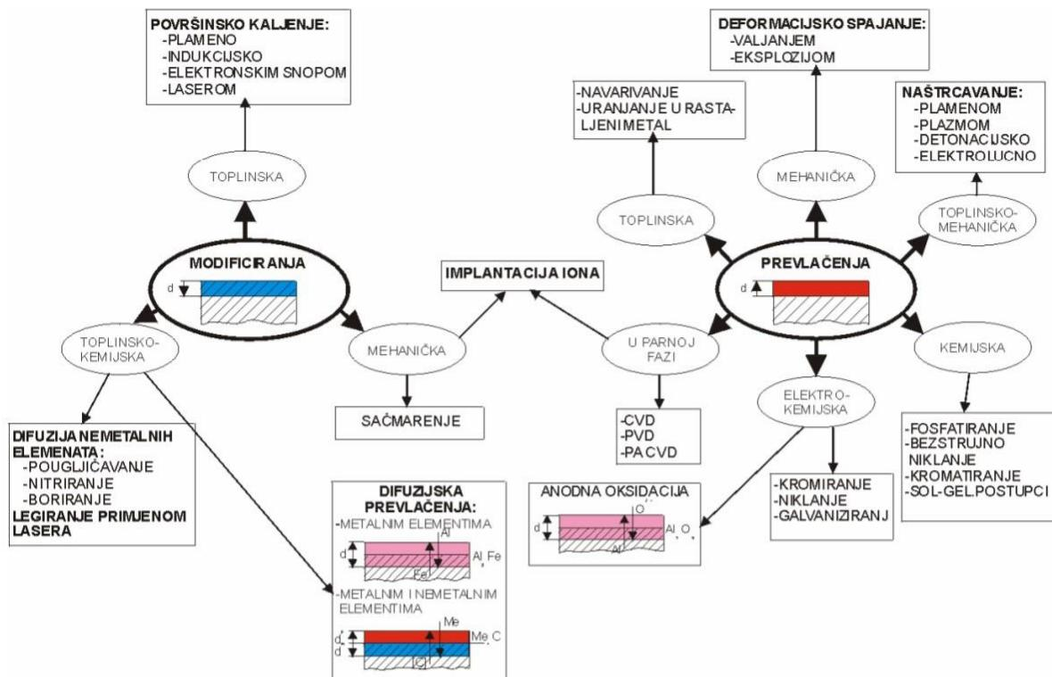
Slika 1. Postupci modificiranja i prevlačenja površina [3]
