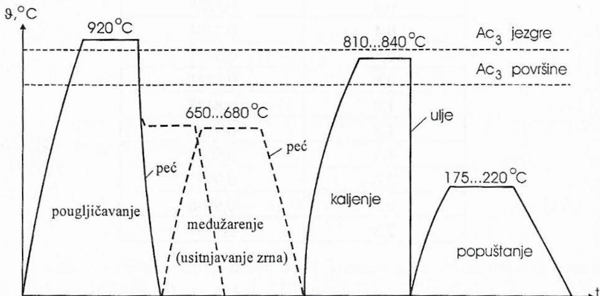
Slika 2. Shematski prikaz postupka cementiranja [5]
