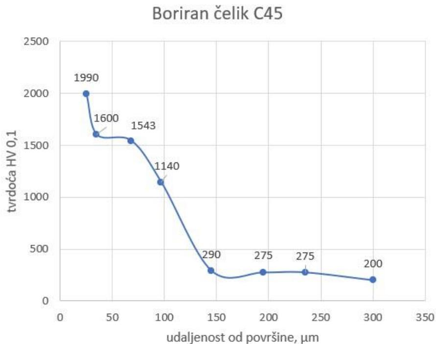
**Slika 25. Raspored tvrdoće boridnog sloja kod klasičnog boriranja**
