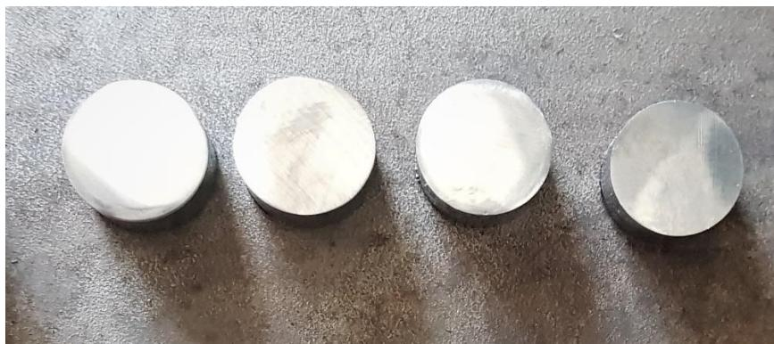
**Slika 17. Odmašćeni i izbrušeni uzorci spremni za boriranje**
