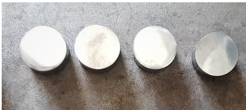
Slika 17. Odmašćeni i izbrušeni uzorci spremni za boriranje
