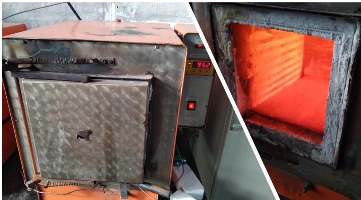
Slika 19. Prikazuje peć prethodno ugrijanu na temperaturu boriranja
