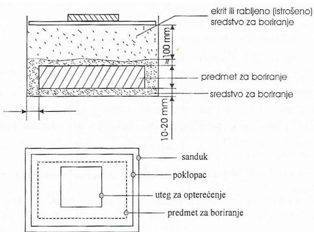
**Slika 9. Shematski prikaz slaganja sarže za boriranje u čvrstom sredstvu [5]**
