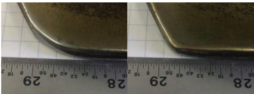
Slika 12. Usporedba trošenja poljoprivrednog alata nakon boriranja (lijevo) i nakon dubokog boriranja (desno) [14]
