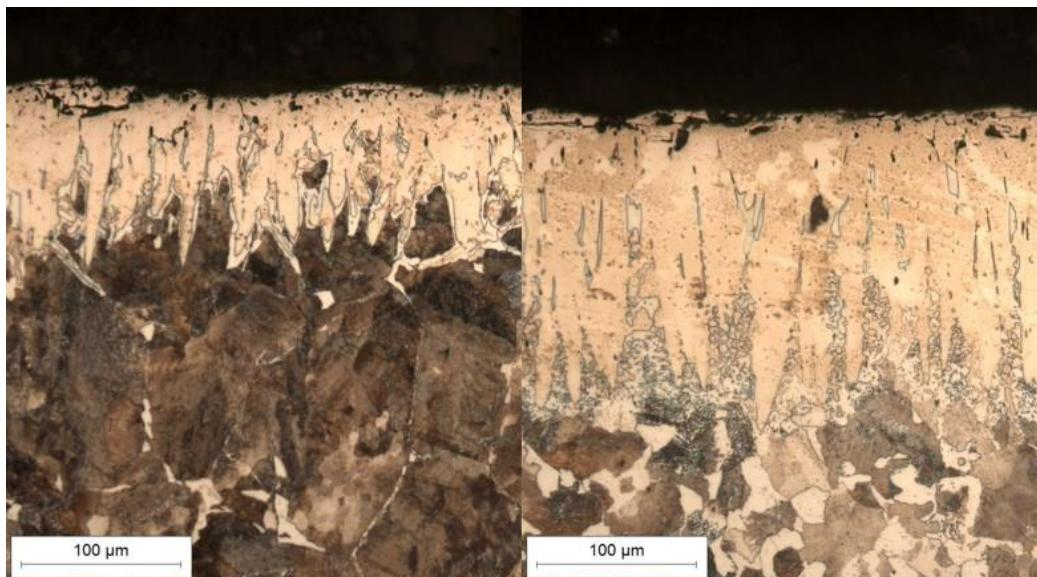
**Slika 32. Mikrostruktura boriranog (lijevo) i duboko boriranog (desno) uzorka pod istim povećanjem (200x)**
