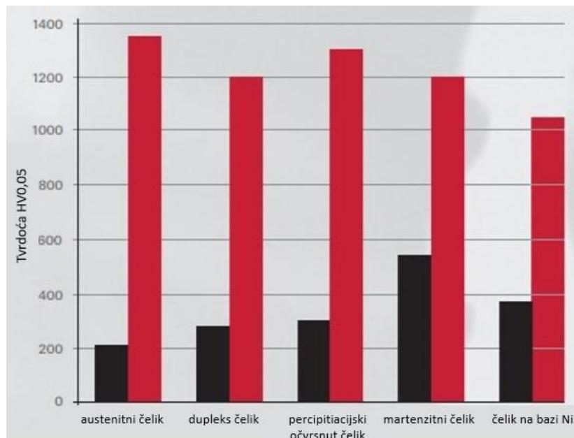
**Slika 16. Tvrdoće materijala prije i nakon Borinox postupka [16]**
