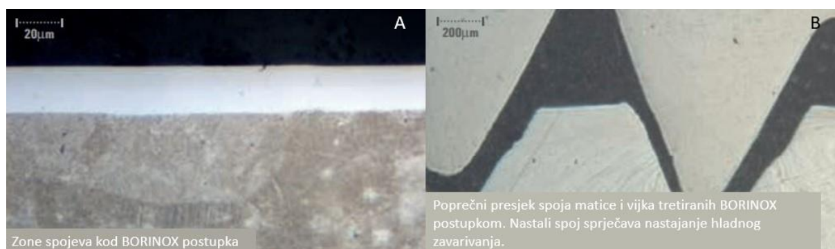
Slika 15. Mikrostruktura dobivena BORINOX postupkom [16]
