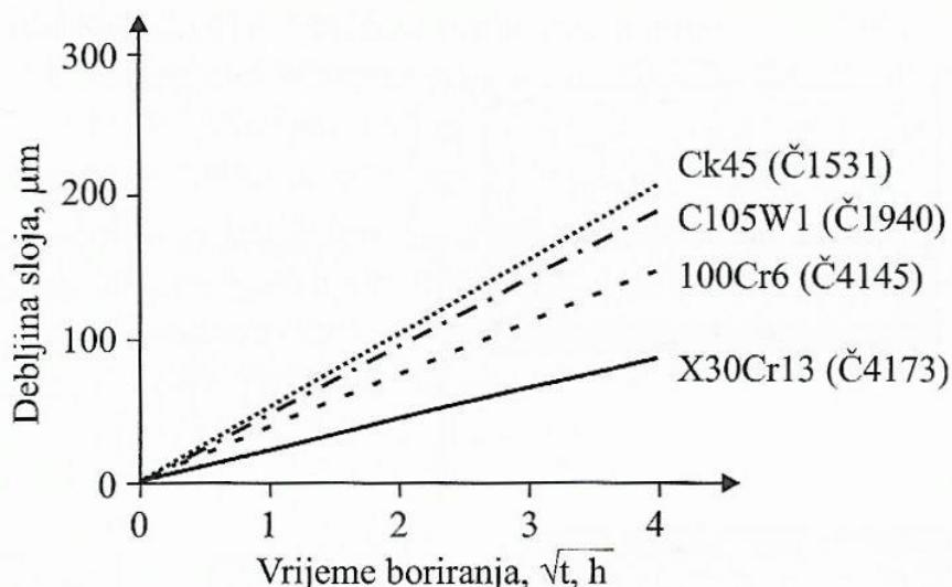
**Slika 10. Ovisnost debljine boridnog sloja o vremenu boriranja [2]**
