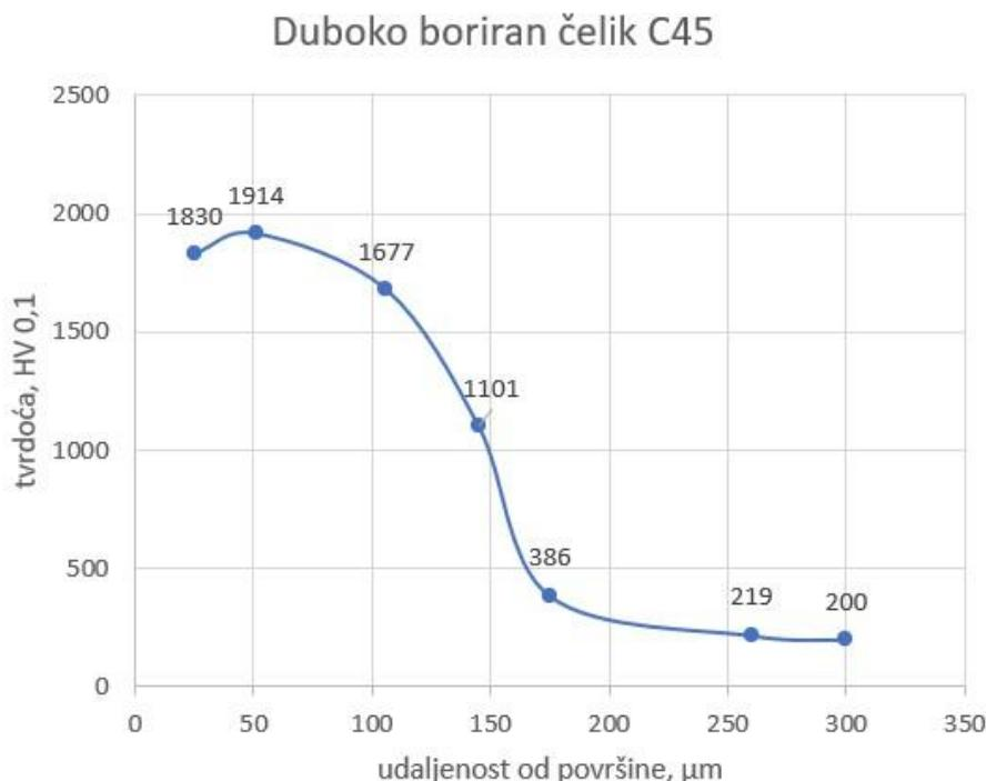
**Slika 26. Raspored tvrdoće boridnog sloja kod dubokog boriranja**
