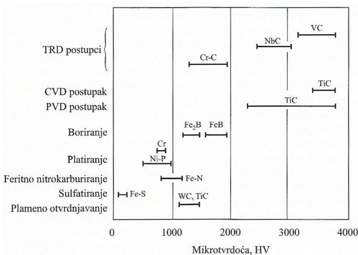
**Slika 4. Usporedba mikrotvrdoća difuzijskog prevlačenja sa drugim postupcima [2]**
